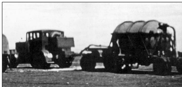
Прицеп с цистерной для жидкого кислорода. Для спирта и других жидкостей и газов существовали свои прицепы.
