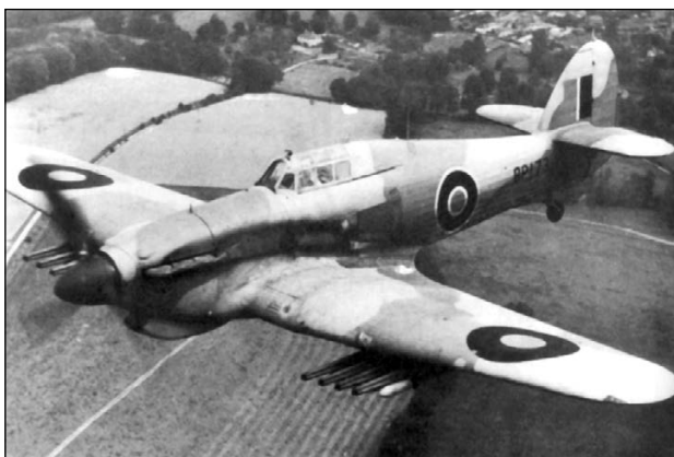
Типовое ракетное вооружение Харрикейна – одна счетверённая пусковая установка под каждым крылом. Видна ракета с 60-и фунтовое осколочно-фугасной боевой частью.
