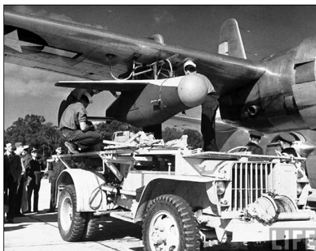
Подвеска бомбы BAT под крыло самолёта. 1946 г. Фото: Томас Д. МакАвой, LIFE.
