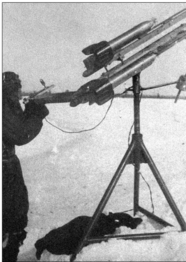
Вариант зенитной установки для запуска 2 снарядов М-8. Стрелок находится у прицела.
