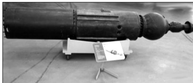
Блок силовой установки ракеты Рейнтохтер R-3. Справа налево: камера сгорания, бак топлива, отсек боевой части, бак окислителя.
