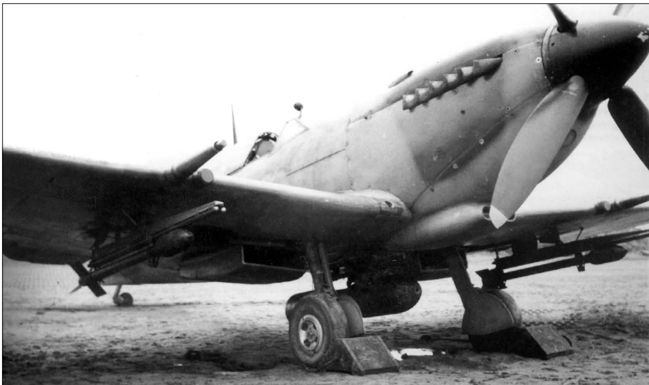
Спитфайер LF.IX или XVI, снаряжённый для выполнения штурмовых задач. Под крылом ракеты с 60-фунтовой (27 кг) БЧ, а под фюзеляжем – 500-фунтовая бомба (225 кг). Один из аэродромов в Голландии. 1945 г.
