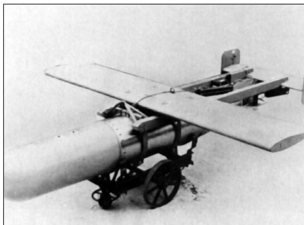
Планирующая торпеда. Применён планер от бомбы GB-1.
