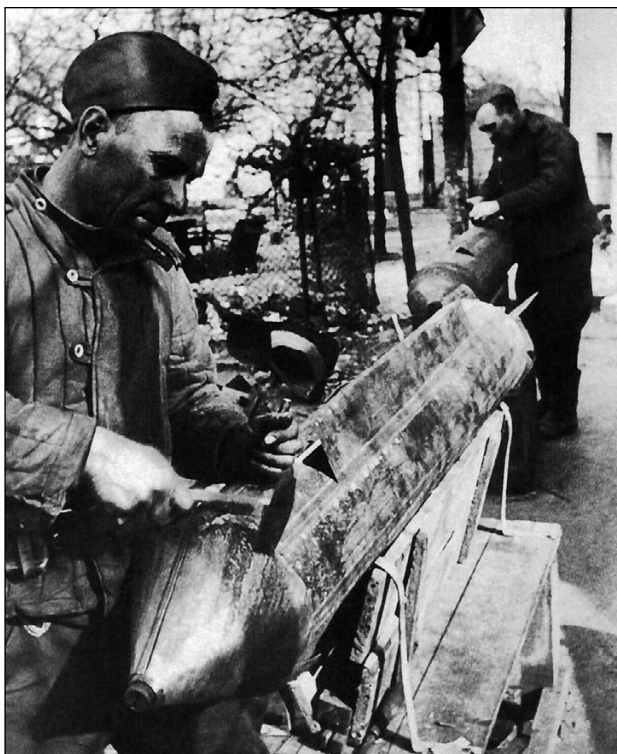
Изготовление летающих торпед. Кожух, изготовленный из кровельного железа, на гвоздях, крепится к деревянным шпангоутам торпеды. В носу оставлено отверстие для вворачивания взрывателя в М-20. Бреславль, 29 апреля 1945 г.
