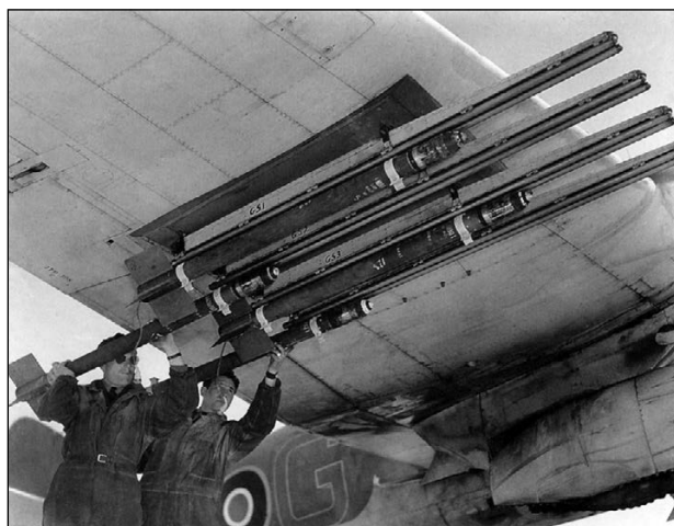
Установка бронебойных ракет с 25-фунтовой головкой (11,3 кг) на самолёт Бофайтер Mk.X. Направляющие штифты на ракетах (белого цвета) сделаны из двух штампков из полосы, стянутых болтами. Направляющий паз на пусковой установке сделан из двух трубок. Ракеты могли запускаться парами (по одной с каждого крыла) или залпом.
