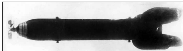
Реактивный снаряд РС-82. Направляющие штифты установлены с двух сторон корпуса. Это сделано для симметричности, для уменьшения рассеивания. Фото: Росархив.
