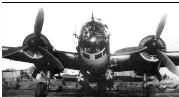
Пара планирующих торпед L-10 «Фриденцеглер» подвешена уступом под самолёт Ju 188A. Самолёт имеет радиолокатор. В носитель планирующих торпед была переоборудована одна машина.
