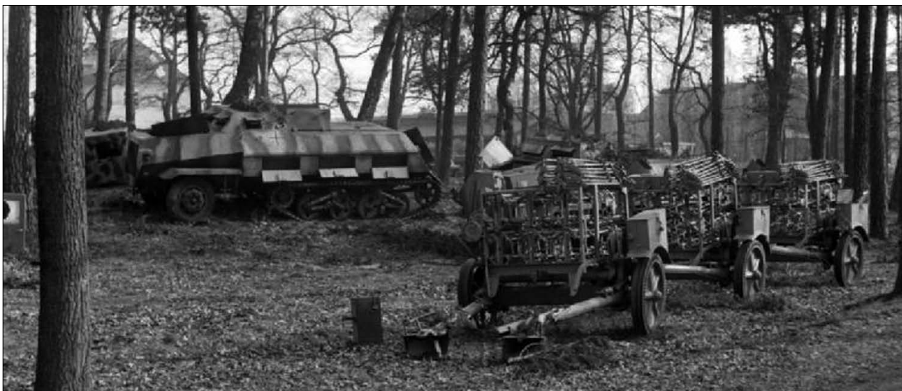
Пусковые установки 30-см «R-Werfer 56» на выжидательной позиции. На ПУ видны вкладыши, применяемые для стрельбы 15-см ракетами.
