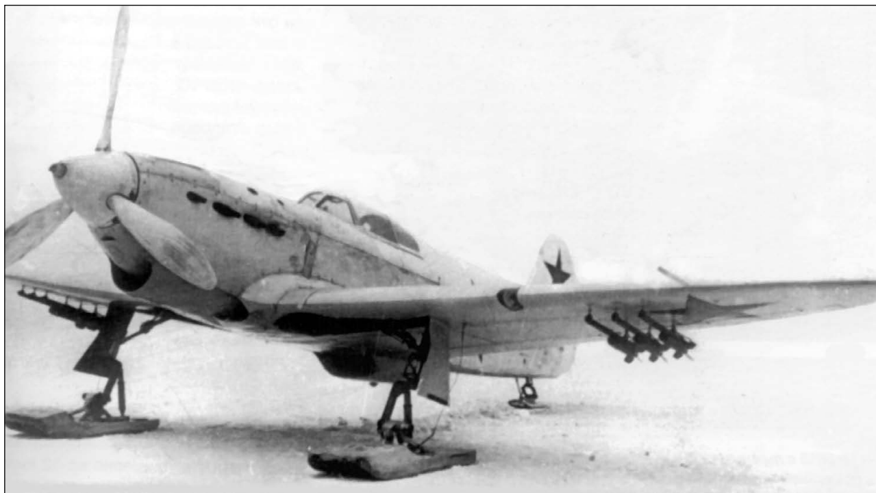
Истребитель Як-1 в зимнем камуфляже и на лыжах. Под крылом 6 снарядов РС-82.
