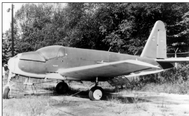
Для отработки системы управления предназначалась пилотируемая бомба LBE-1 «Глоумб».
