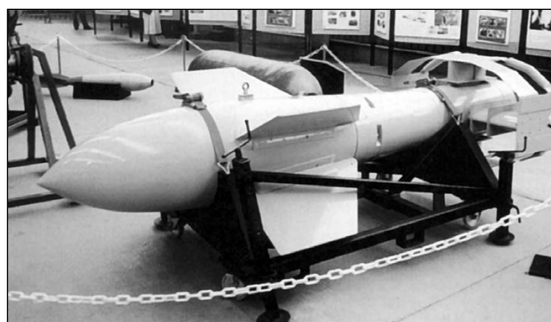
Бомба X-1 из экспозиции Имперского Военного музея. Хорошо видна конструкция стабилизатора со щелями и толстыми стойками, в которых находятся интерцепторы. В узел крепления к самолёту ввёрнут рым-болт, который перед применением снимают. Блестящая лакированная окраска — скорее всего результат стараний музейных работников. На боевых образцах цвет был матово-серый, и присутствовали технические надписи.
