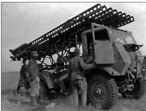
Установка БМ-13-16 на шасси автомобиля Форд WOT-8 («Форд» — канадский). Немецкие солдаты осматривают установку, потерянную предположительно в 1942 г.
