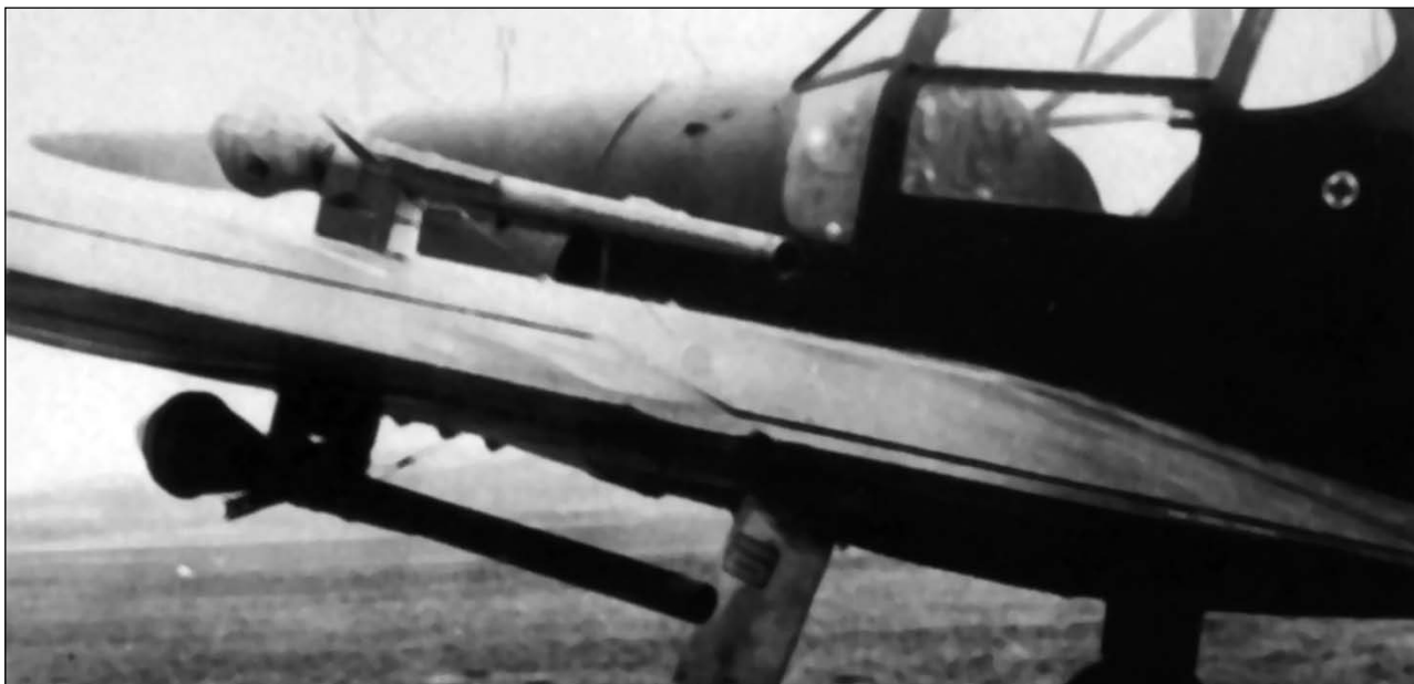
Установка армейского гранатомёта «Панцерфауст-100» на крыле самолёта Ву 181. Это оружие последней надежды, эффективность которого близка к нулю.
