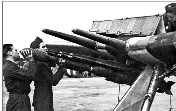
Пусковые установки истребителя «Тайфун» снаряжаются ракетами RP.
