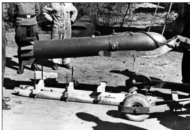
Немецкая бомба с ракетным ускорителем PC 500 RS Pauline. Данный образец имеет 12 небольших стабилизаторов. Видны: заводская тара и перекатная тележка.
