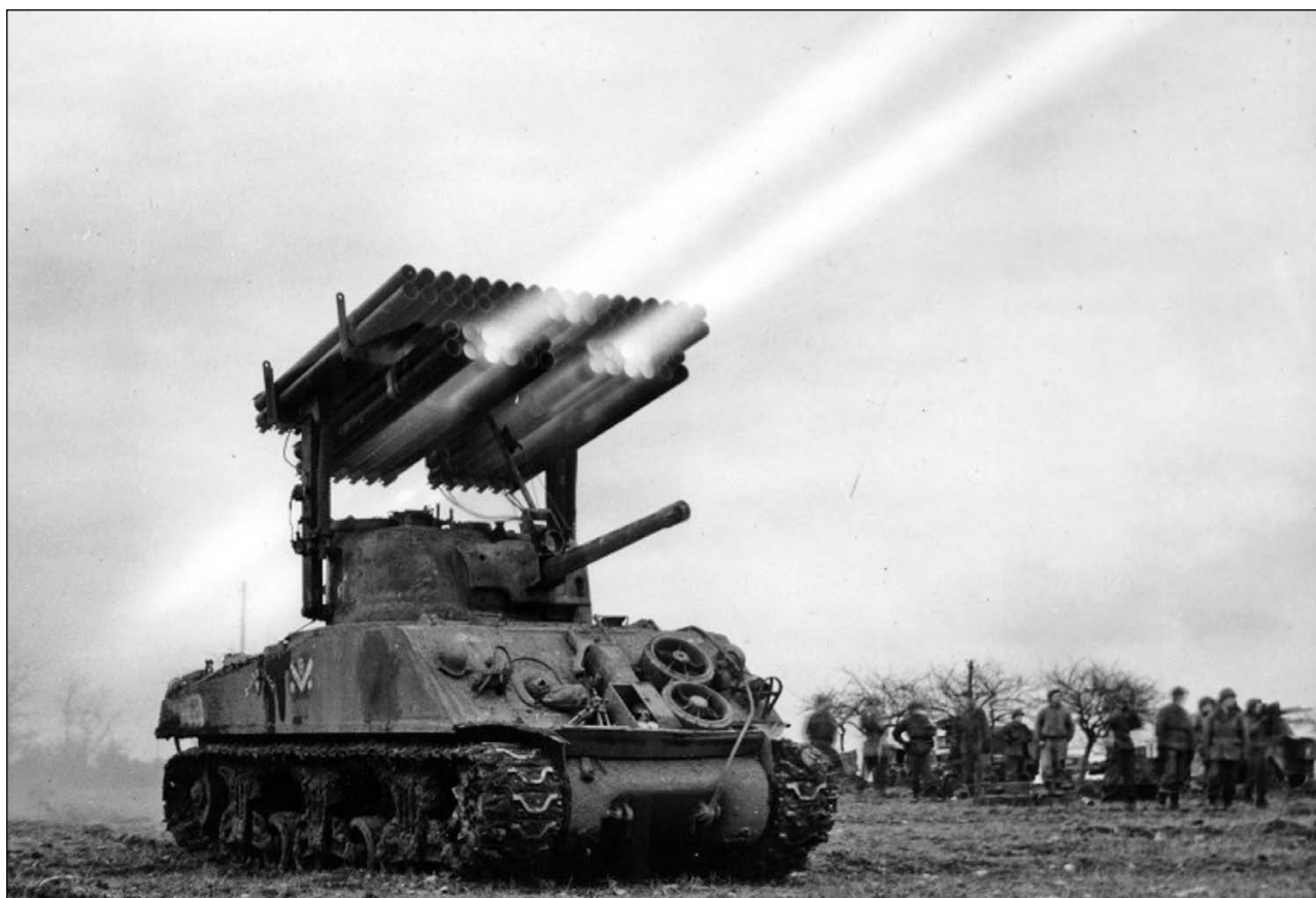
Американская пусковая установка Т34 Calliope, смонтированная на танке М4А3 — «Шерман» — с именем Cold Storage. 12-ая Танковая дивизия США ведет огонь в районе Флетранж, Франция.
