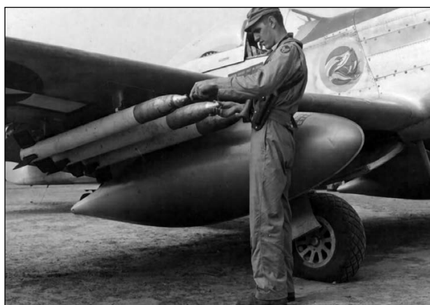
Ракеты HVAR, кал. 127 мм, на пусковых установках с нулевыми направляющими. Истребитель «Р-51D Мустанг».
