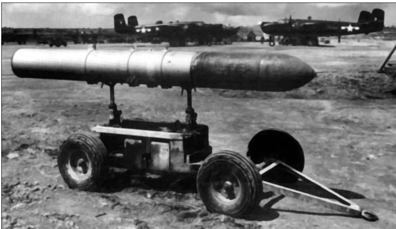
Ракета «Тайни Тим», пока без оперения. Хорошо видны хомуты с ушками для подвески к пусковой установке. Ракета лежит на модифицированной бомбовой тележке Mk I, Mod. I. На заднем плане видны самолёты Митчел, в версии РВJ-1 из эскадрильи VMВ-612, вооружённой этими ракетами. В носу самолётов установлены радары AN/APS-3. Американская база на о. Иво Дзима. 2 августа 1945 г.
