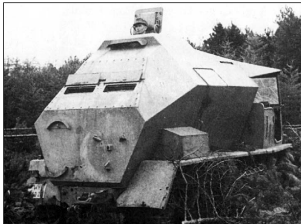
Бронированный пункт управления батарей А-4 защищал командиров в случае взрыва ракеты на старте.
