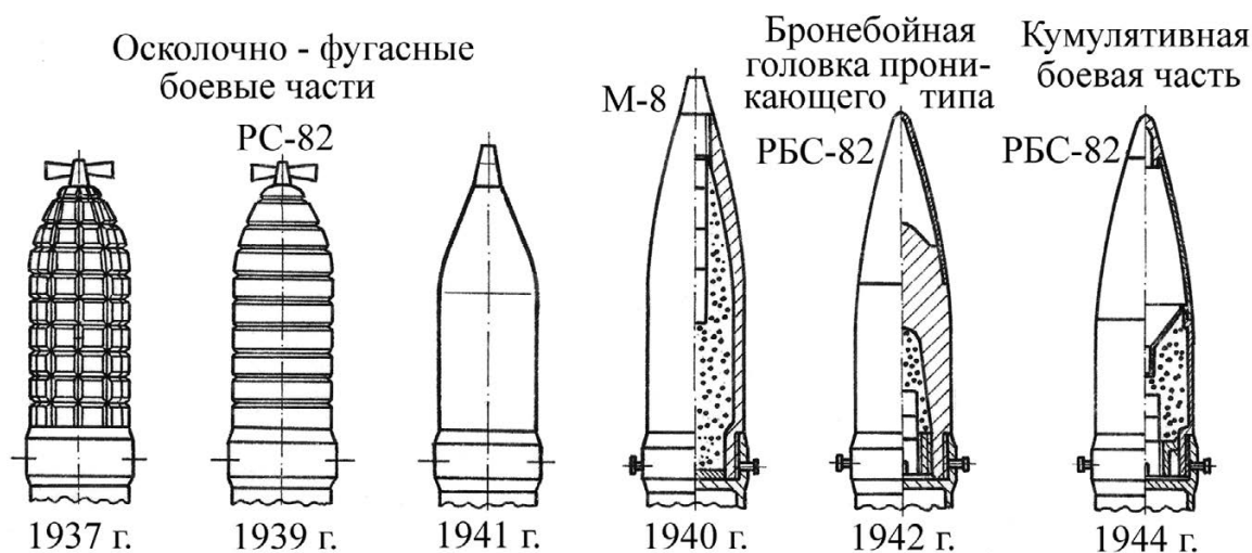
Рис. 83. Развитие боевых частей на примере 82-мм снарядов.
