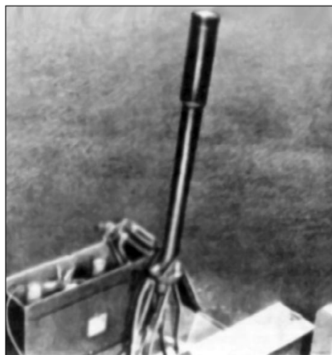
Установка «Snare». У этого образца направляющая выполнена в виде кольца, а трос хранился в ящике, рядом с ракетой.
