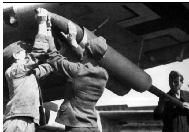
Заряжание пусковой установки ракетой WGr 21, калибром 210-мм. Это было непростым делом. Вес снаряда составлял 112,6 кг, его нужно было поднять на вытянутых руках и вставить в трубу, не повредив при этом её тонкие стенки. Для того, чтобы снаряд не соскользнул назад, сбивая при этом фиксаторы и систему зажигания, третий вооруженец подпирает его деревянным поленом.
