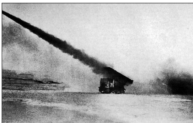
Залп «тракторной катюши» в районе Сталинграда, январь 1943 г. Густой чёрный дым — результат применения отечественных порохов в двигателе. После 1943 г. пороха и компоненты для их производства стали получать по ленд-лизу, и количество дыма значительно уменьшилось.
