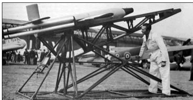
Ракета «Студж». Можно оценить её размеры. Видны стартовые ускорители. На нос надет колпачок, защищающий трубку ПВД.
