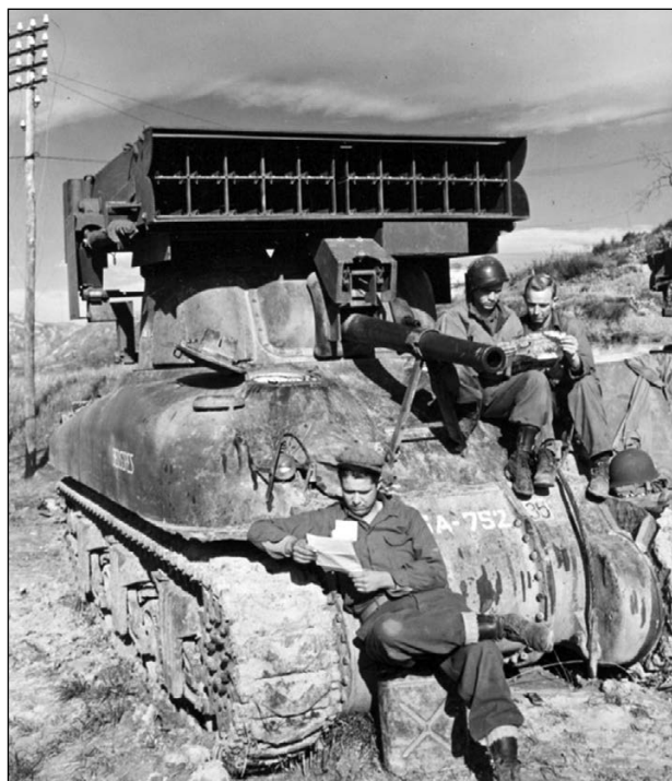
Американский танк М4А1 «Шерман» с установленной над башней системой залпового огня Т40 -М17.
