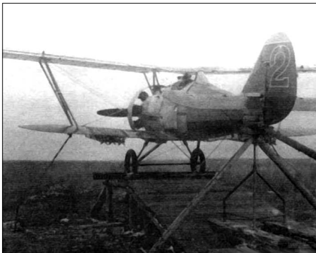
Наземные испытания реактивных снарядов РС-82 с истребителя И-5.
