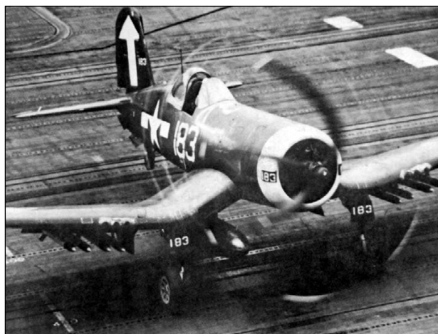
Авианосец «Банкер Хилл», 19 февраля 1945 г. «Корсар» взлетает для атаки на Иво Дзиму. Ракеты HVAR имеют серый корпус и чёрную боевую часть. Обратите внимание на несимметричную подвеску дополнительного бака.
