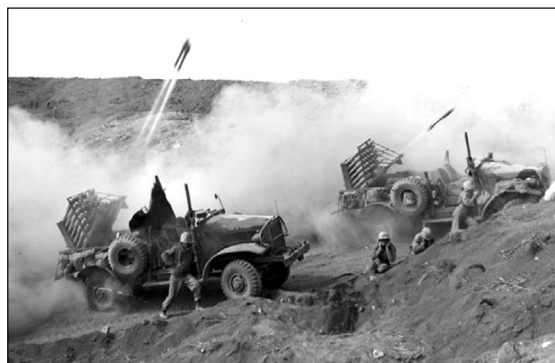
Установка с гравитационной подачей ракет на направляющие. Ракеты размещаются в вертикальных магазинах и падают на направляющие и пусковые контакты после вылета предыдущего снаряда. Бои на Иводзиме. Обратите внимание на отважного американского парня, стоящего вплотную к стреляющей ПУ. Интересно, смог бы он это повторить рядом с нашей «катюшей»?
