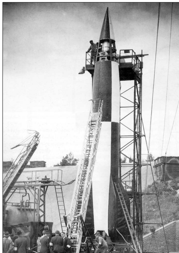
А-4 готовится к испытательному полёту. Крышки приборного отсека сняты. Виден белый контейнер, в котором размещены приборы системы управления. Обратите внимание на множество гражданских специалистов, стоящих возле ракеты. Лица, не имеющие повязок, не имеют права находиться на стартовой позиции.
