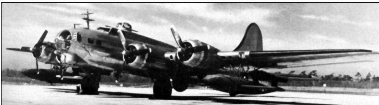
В-17G с парой реактивных снарядов JB-2 Thunderbug под крыльями.
