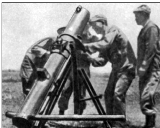
Пусковая установка для ракеты калибром 203 мм, весом 90 кг. Ни о какой залповой стрельбе с таким оружием речи быть не может.
