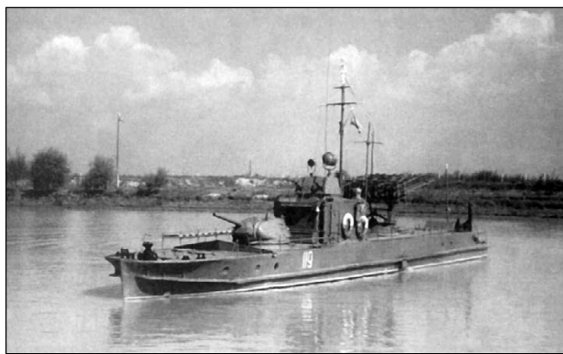
Бронекатер пр. 1124 с пусковой установкой для 16-М-13 132-мм реактивных снарядов.
