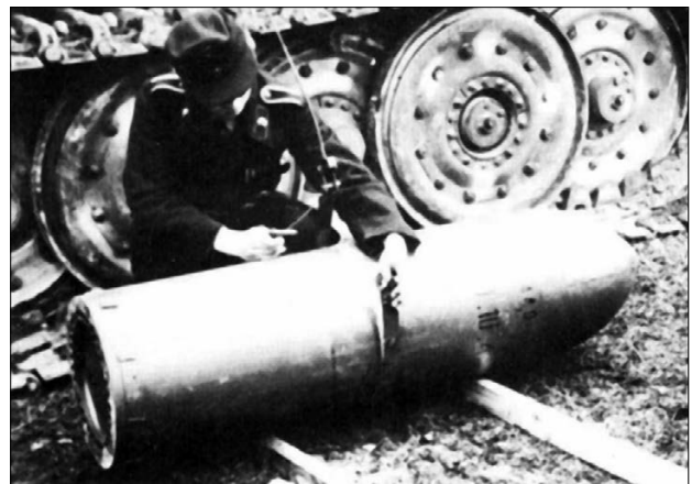
38-см WGr 4581 – 380-мм снаряд к штурмовой мортире. Солдат прилаживает захват, с помощью которого снаряд можно загрузить в корпус самоходной мортиры.
