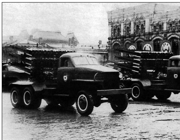
БМ-8-72 на шасси автомобиля «Студебекер» имела самое большое число направляющих — 72 штуки. Парад Победы, Москва, 24 июня 1945 г.
