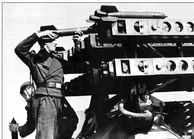
Реактивные снаряды 80-см WGr Spreng — реплика советского снаряда М-8.
