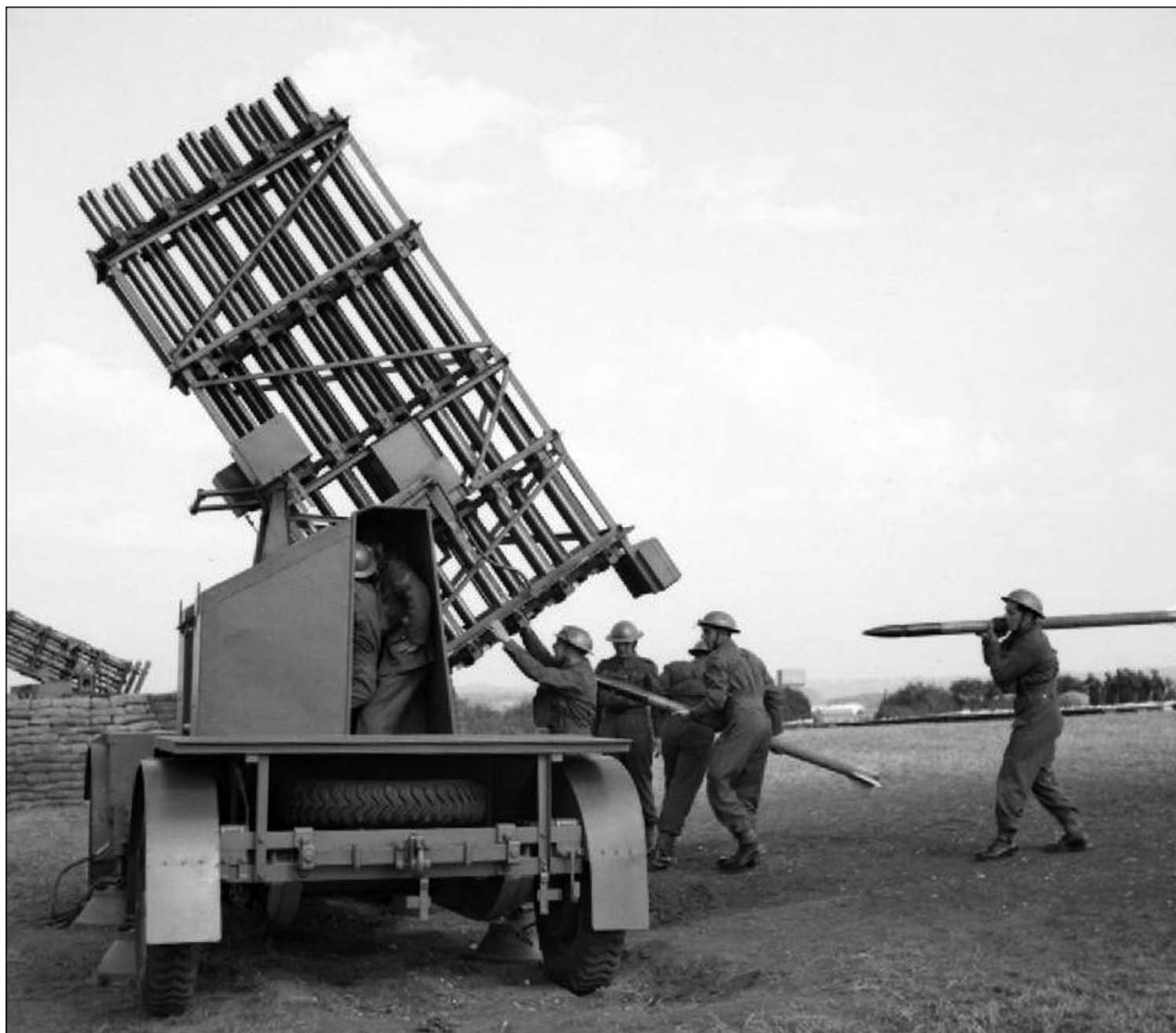
Солдаты Территориальной обороны заряжают ракеты типа «Z» в 10-ствольную пусковую установку. ПУ смонтирована на прицепе. Мобильная батарея Королевской артиллерии, июнь 1941 г.
