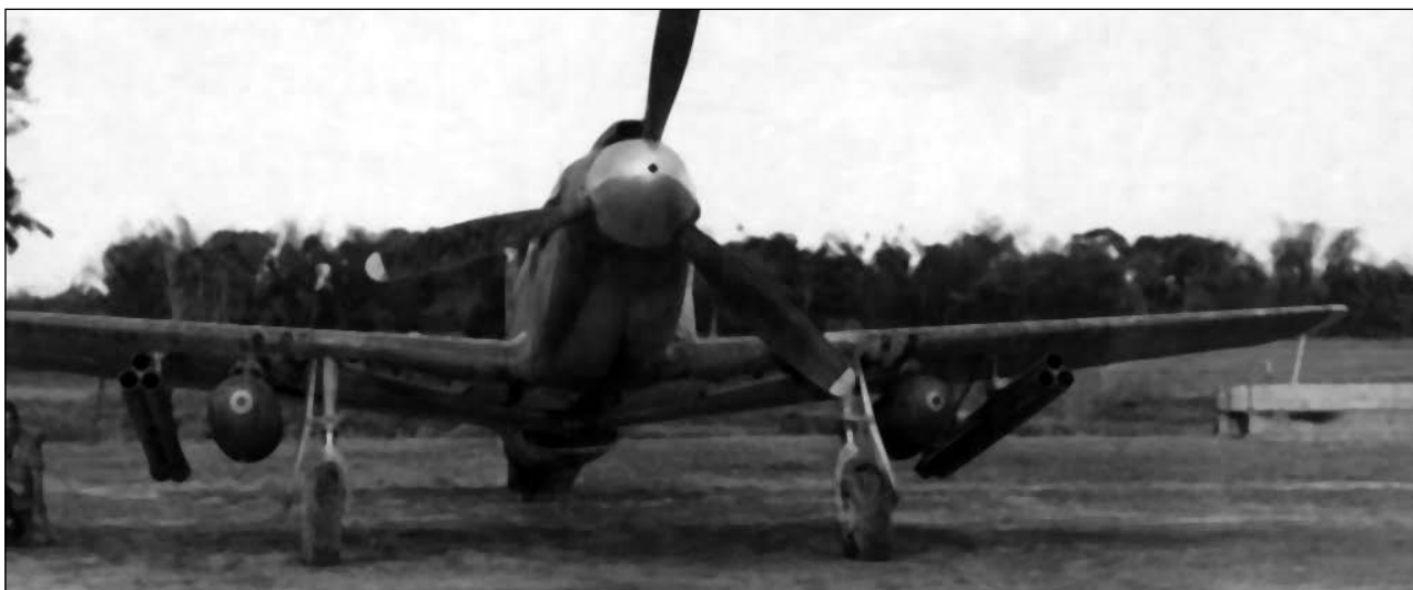
«Р-51 Мустанг», со строенными пусковыми трубами для ракет М-8. Август 1944 г.
