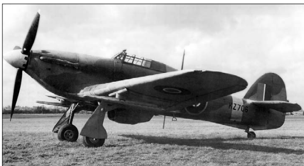
Пусковая установка «Лонг Том» на Харрикейне MkIV. Обратите внимание на громоздкую защиту крыла и на единственную направляющую под крылом. В дальнейшем использовали многоствольные пусковые установки.
