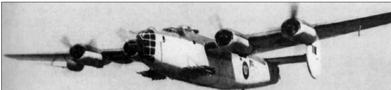
Самый тяжёлый ракетоносец Второй мировой войны — британский Либереитор Mk.III (GR.V). Он предназначался для борьбы с немецкими подводными лодками и нёс 8 ракет RP с 11-кг головками, калибром 76 мм. Под правым крылом виден обтекатель прожектора, с помощью которого осуществляется поиск подводных лодок на поверхности воды ночью.
