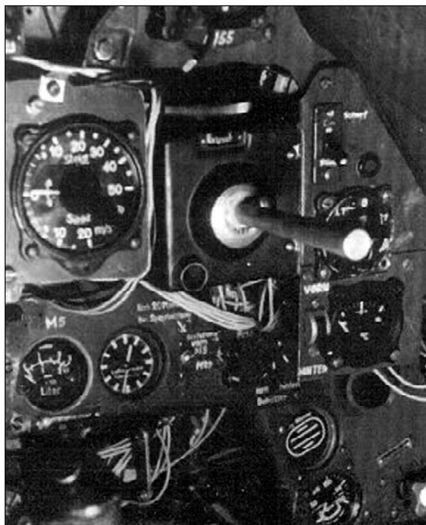
Приборная доска Fw 190. Виден «кноппель», с помощью которого пилот управлял полётом ракеты X-4.
