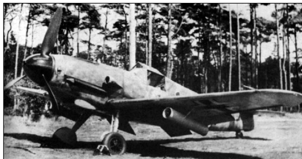
Me 109G-6, вооружённый ракетами WGr 21. Такие самолёты применялись для борьбы с тяжёлыми бомбардировщиками союзников.
