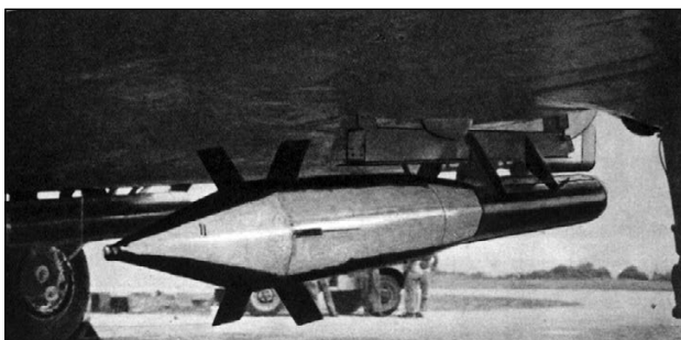
Британская бомба с ракетным ускорителем «Дисней бомба» (1200 кг) под крылом испытательного самолёта В-17.
