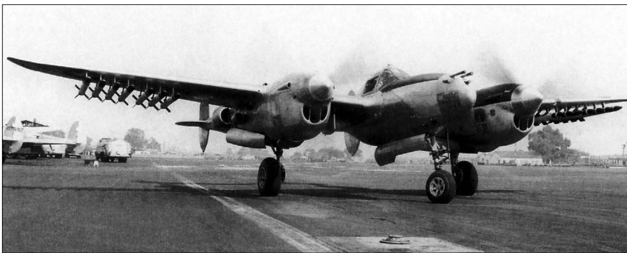
«Лайтнинг Р-38L-1-LO» с семью пусковыми установками с нулевыми направляющими типа Mk 5 для ракет HVAR.
