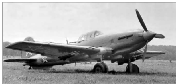
Ил-10 — вершина в развитии поршневых штурмовиков. Под крылом — армейские снаряды М-13 и бомбы 250 кг.
