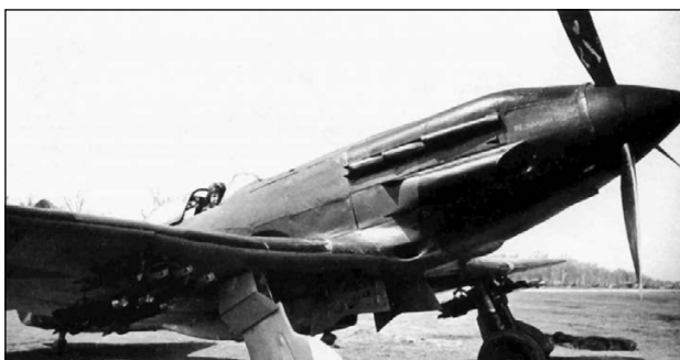
Истребитель МиГ-3, вооружённый снарядами РС-82.
