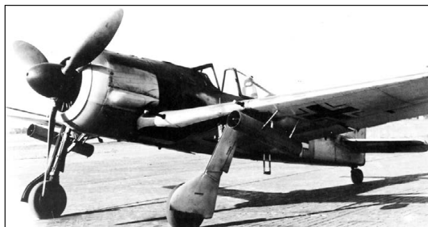
Истребитель Fw 190A-4/R6, вооружённый ракетами WGr 21.
