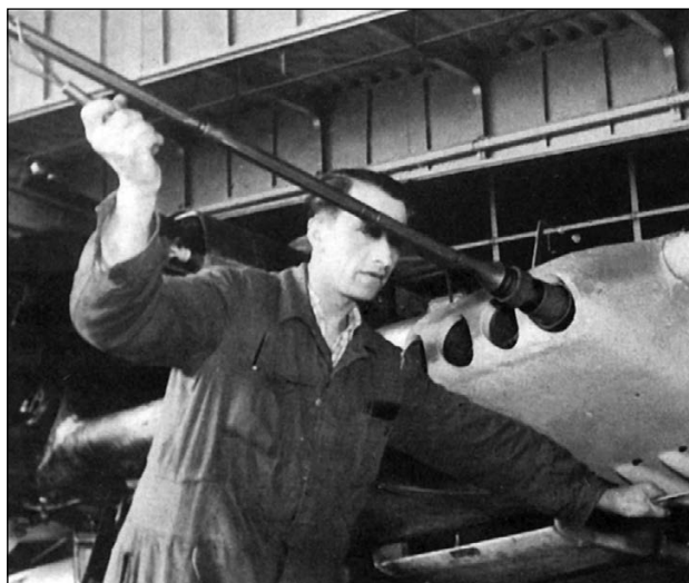
Заряжание ракеты R.Z.65 в пусковую установку самолёта Me 109F.
