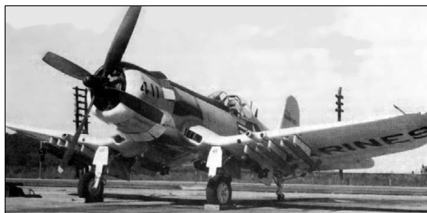
Штурмовой вариант «Корсара AU-1», вооружённый четырьмя ракетами Холи Мозес и тремя бомбами кал. 113 кг. Пусковые установки выполнены в виде пилотов. Калифорния, 1957 г.
