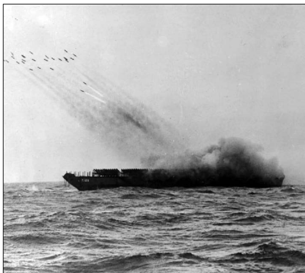
Залп 5-дюймовых (127 мм) ракет с борта британской десантной баржи. Пусковые установки крепились под углом 45 градусов. После выхода на расчётную дистанцию командир корпуса корабля выполнял наведение по азимуту и производил залп из примерно 1000 ракет в течение 45 сек. Затем баржа подходила к берегу и высаживала морских пехотинцев.
