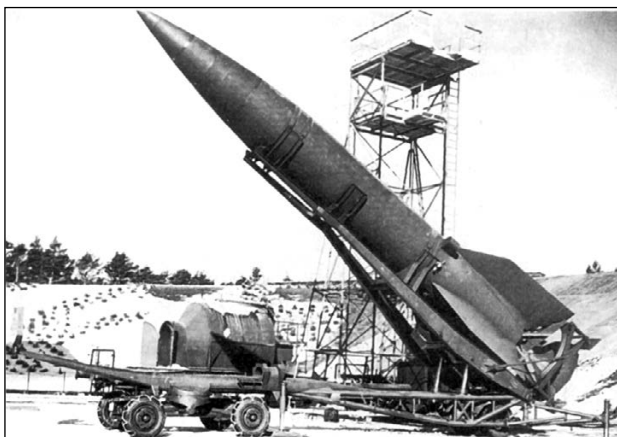
Установка ракеты в стартовое положение. Хорошо видна транспортная тележка и стартовый стол. На заднем плане — цистерна с кислородом.
