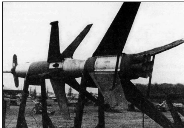
Ракета «Рейнтохтер R-1». Вид сзади. Хорошо виден стартовый ускоритель, крепление стабилизаторов на уголках, их подкосы, сопла двигателей и повреждения на двух перьях стабилизатора.
