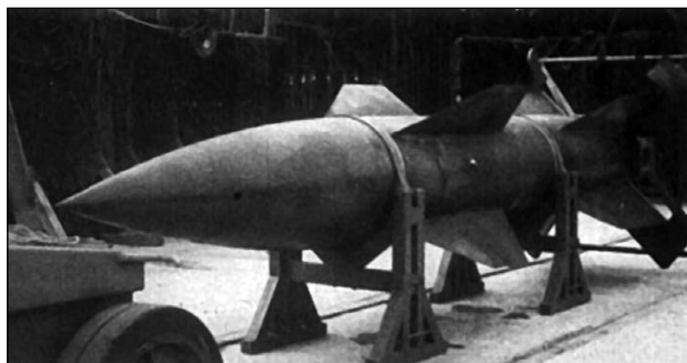
Прототип «Вассерфалья» при горизонтальных испытаниях. Сзади закреплена перекатная тележка.
