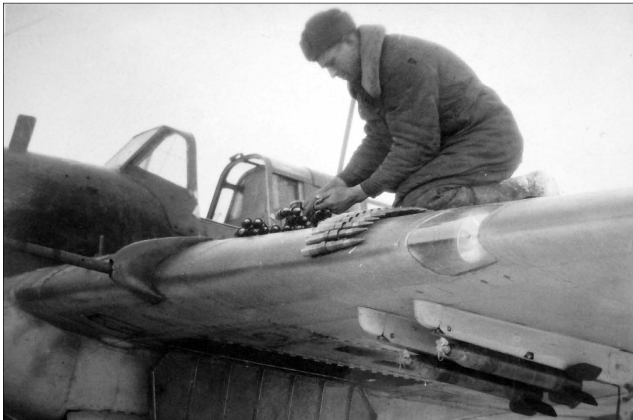
Под крылом Ил-2 два ракетных орудия РО-82 в обтекателях ЦАГИ. Ракетные снаряды РС-82 на середине направляющих. Перед вылетом их сдвинут назад, чтобы пиропистолет вошёл в сопло. Бомболюк открыт, техник заряжает пушку.
