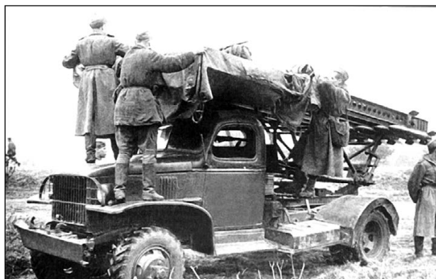
Установка БМ-13-16Н на шасси грузовика «Шевроле» G-7117 грузовика. Заряжен нижний ряд направляющих. Трудно определить время съёмки. На солдатах видны погоны — значит, после 1943 г., а с другой стороны, боец слева одет в будёновку, — значит, начало войны?
