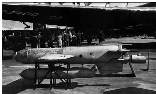
Ракета Hs 293A на выставке трофеев в США. Хорошо видна компоновка ракеты.
