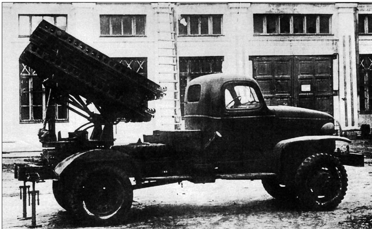
Установка БМ-8-48 на шасси автомобиля «Шевроле G-7117» во дворе завода «Компрессор». 1942 г.
