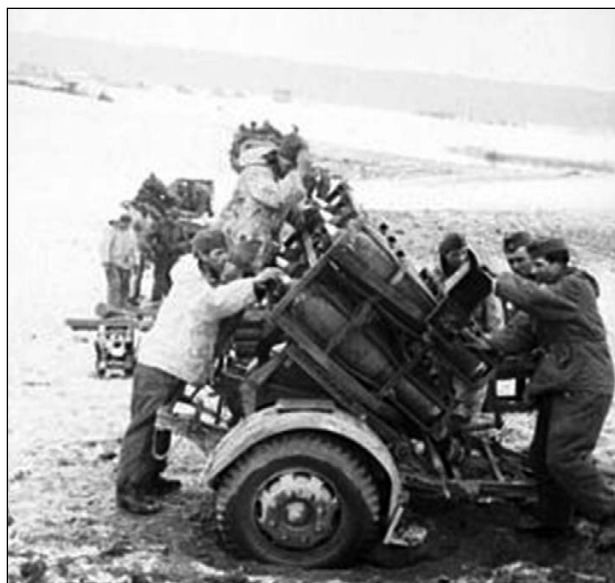
Подготовка 300-мм снарядов к стрельбе. Шесть укупорок с ракетами 30-см Wk Spreng (2 ряда по 3 штуки), установлены на 2-колёсный лафет.
