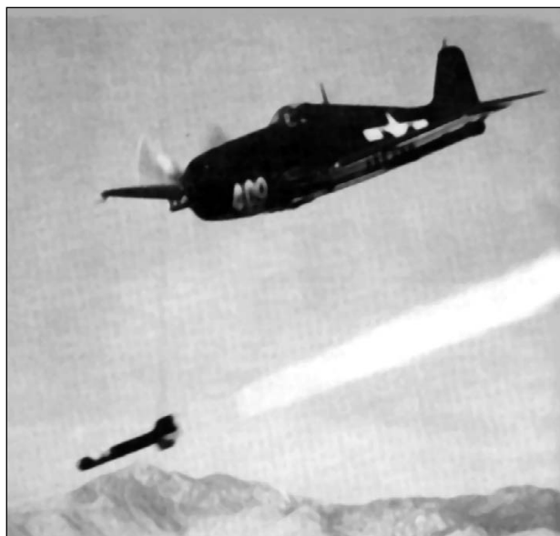
Испытательный пуск ракеты «Тайни Тим» с истребителя Хэлкэт. Одна такая ракета подвешивалась под фюзеляж. Можно оценить расстояние, на котором запускался двигатель ракеты. Под крыльями самолёта видны пусковые установки для других, более лёгких ракет.
