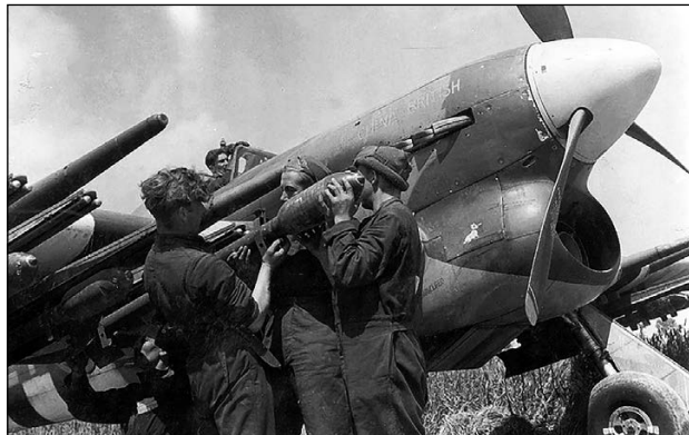
Подвеска ракеты RP (60 фунтов) под крыло истребителя «Тайфун».
