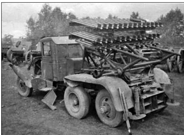
Разбитая установка БМ-8-36, на шасси автомобиля ЗИС-6. Установка состояла из трёх рядов направляющих типа «Флейта», всего 36 шт. Одна из направляющих с ракетой стоит у заднего левого колеса.
