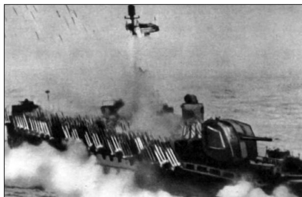
Десантный катер ведёт огонь ракетами BBR-4,5. Ракеты этого калибра (4,5 дюйма = 114 мм, вес — 13,1 кг) явились основой для создания более мощной BBR-5 (127 мм).
