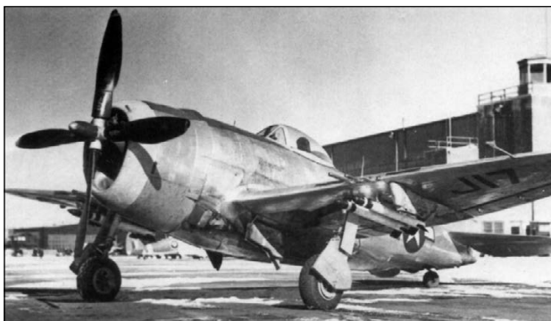
Одна из последних версий «Тандерболта P-47D», вооружённая ракетами «Холи Мозес». Ракета имеет серый корпус, чёрные стабилизаторы и чёрную с серой полосой боевую часть. Пусковая установка сделана в виде довольно высокого пилота, причём передний штифт ракеты расположен примерно на середине его длины. Так что ракета висит на ПУ в виде консоли. 9-я Воздушная армия в Европе, 1945 г.
