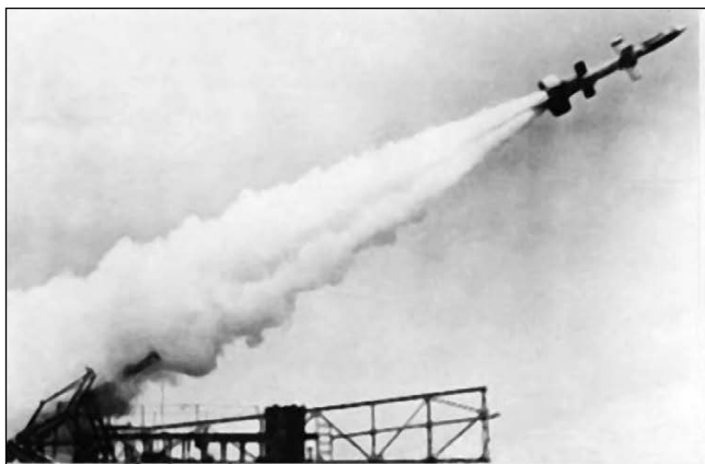
«Ларк» на пусковой установке. Хорошо видны маршевая ступень и один из стартовых ускорителей с коробчатым стабилизатором. Пусковая установка сделана в виде катапульты. Пружины в центре снимка – выбрасывают ракету в воздух.
