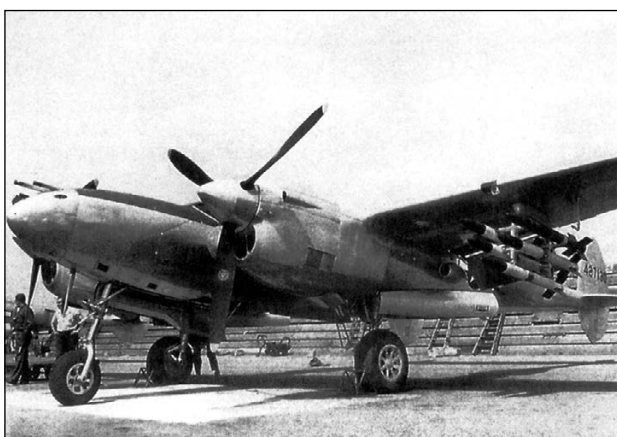
Истребитель «Лайтнинг», с пусковыми установками типа «Рождественская ёлка» для ракет HVAR, кал. 127 мм.
