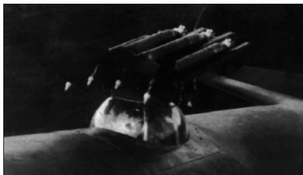
Ракетная батарея 4 РУБ-82 установлена на астролуке бомбардировщика Пе-2 для защиты задней полусферы. Ракеты РОС-82 снабжены взрывателями АГДТ-А-РС-82. Лето 1942 г.
