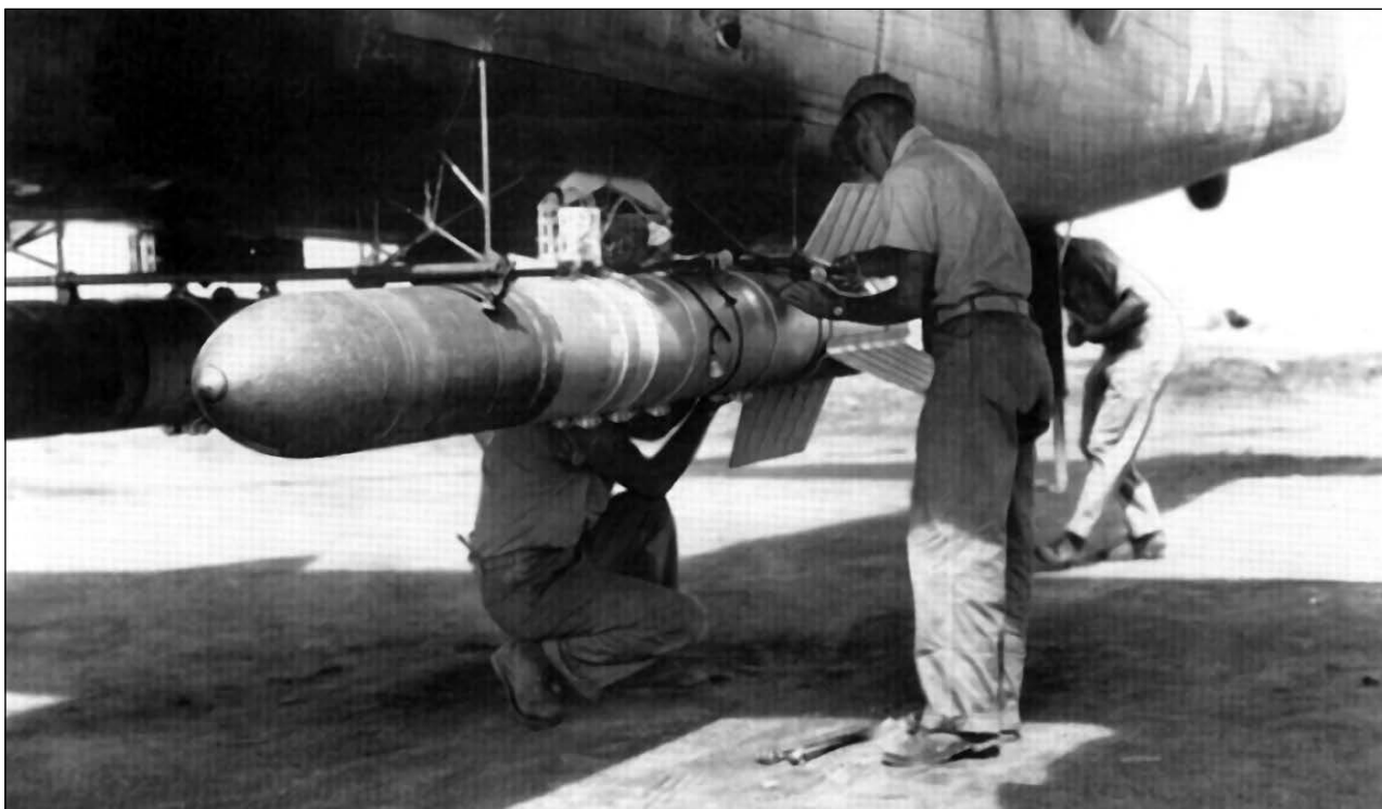
Подвеска ракеты «Тайни Тим» на самолёт «В-25 Митчел», версии РВJ-1D.
