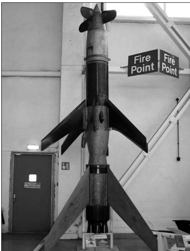
Музейный «Рейнтохтер R-1». Хорошо видна общая компоновка ракеты. Дополнительные панели на стабилизаторе отсутствуют.
