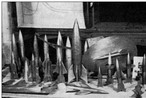
Продувочные модели ракет А-4 и «Вассерфаль».
