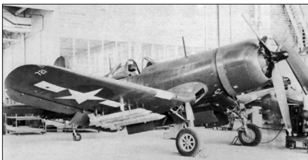
«Корсар F4U-1D», вооружённый ракетами HVAR Holy Moses, кал. 127 мм. Пусковая установка с нулевыми направляющими, выполненная из двух стоек. Ракеты покрашены в серый цвет. 1944 г.
