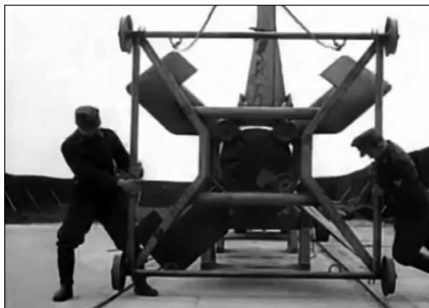
Перекатная тележка для ракеты «Вассерфаль». (Кадр кинохроники). При старте прототипа тележка почему-то не отделилась, и ракета полетела с ней. После набора высоты 100–200 метров, ракета завалилась на бок и рухнула на землю, в 300–400 м от старта.
