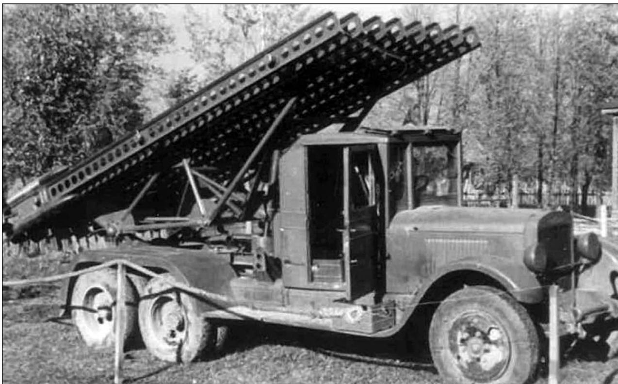
Боевая машина БМ-13-16, на шасси автомобиля ЗИС-6. Установка на какой-то выставке, о чём свидетельствует ограждение из верёвки и проволоки. Машина заряжена.
