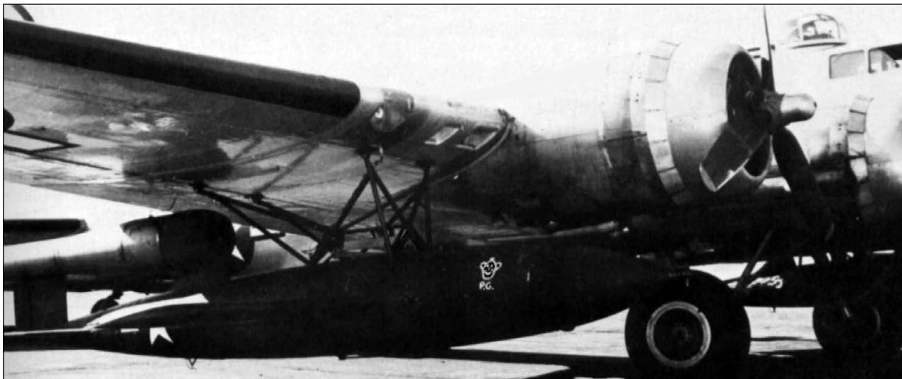
Подвеска JB-2 под крылом В-17G. Снаряд имеет американские опознавательные знаки под двигателем и карикатуру P.G. на носу. База Вендовер Файлд.
