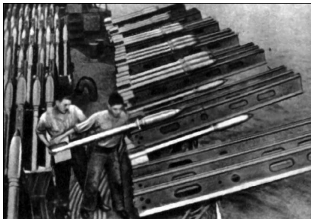
Корабельные пусковые установки заряжаются авиационными ракетами калибром 127 мм, типа AR-HE.
