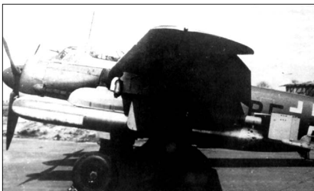
Самолёт Ju88A-4 с подвешенным планером Блом унд Воос L-10, снаряжённый торпедой LT5b.
