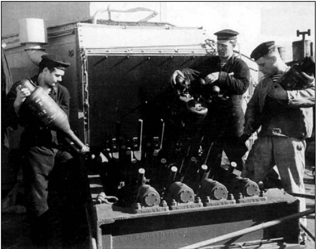
Заряжание бомбомётной установки «Хеджехог» на советском эсминце «Живучий» (до 1944 года «Ричмонд». Этот эсминец в августе 1944 года был передан Северному флоту). Хорошо видно, что установка не имеет привычных направляющих, а реактивные бомбы надеваются на специальные штыри.
