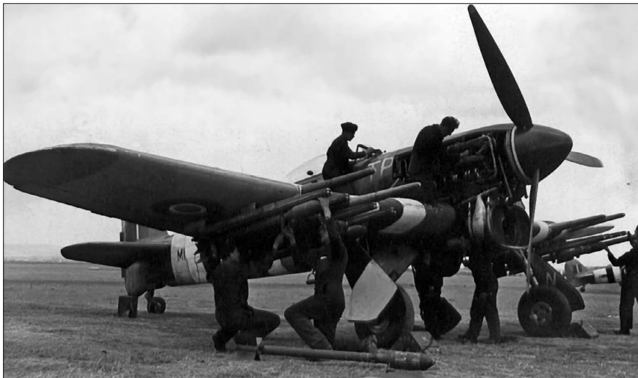
Истребитель «Тайфун» в штурмовом варианте. Кадр постановочный: мотористы ещё занимаются двигателем, а оружейники уже подвешивают ракеты RP с 60-фунтовой (27 кг) БЧ. Фото: LIFE.
