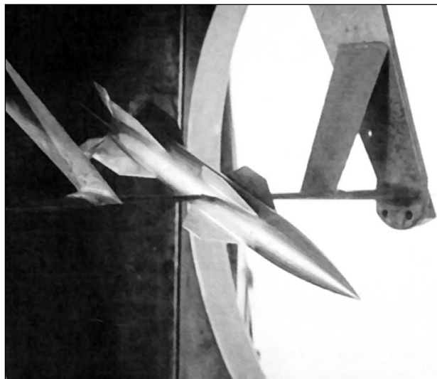
Модель ракеты «Вассерфаль» в аэродинамической трубе.
