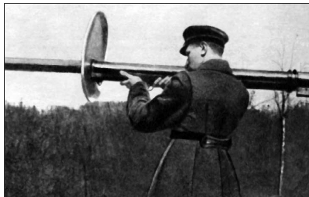
РС-65 – предвоенная разработка ручного ракетного оружия. Из-за малой точности и опасности для стрелка, на вооружение принята не была.
