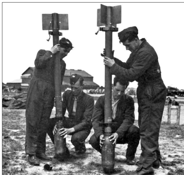
Сборка ракеты RP. На 3-дюймовый двигатель навинчивается 60-фунтовая (27 кг) осколочно-фугасная боевая часть.
