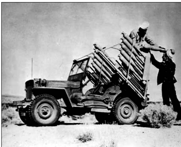
Заряжание пусковой установки с гравитационной подачей ракеты на стартовый поток.
