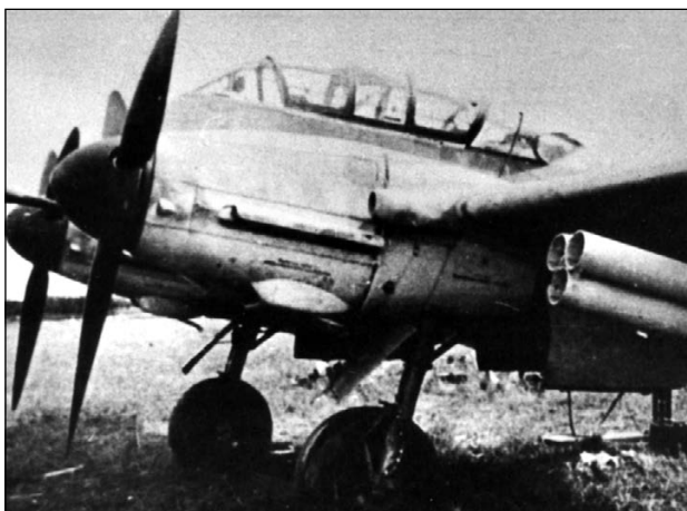
Венгерский самолёт Me 210Ca-1, вооружённый пушкой калибром 40-мм и строеными пусковыми установками для реактивных снарядов калибром 150-мм. Так предполагалось оборудовать 30 самолётов, но сделали только четыре. Октябрь 1944 г.
