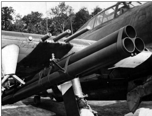
Пусковая установка для трёх ракет М-8, кал. 4.5 дюйма, на истребителе Р-47. Видны пулемёты «Браунинг», кал. 12,7 мм.
