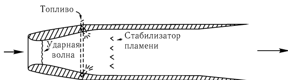
Рис. 69. Принципиальная схема, показывающая элементы прямооточного воздушно-реактивного двигателя. (Из книги Joseph Liston, Power Plants for Aircraft [copyright 1953, McGraw-Hill Book Co., Inc.], с разрешения.)
