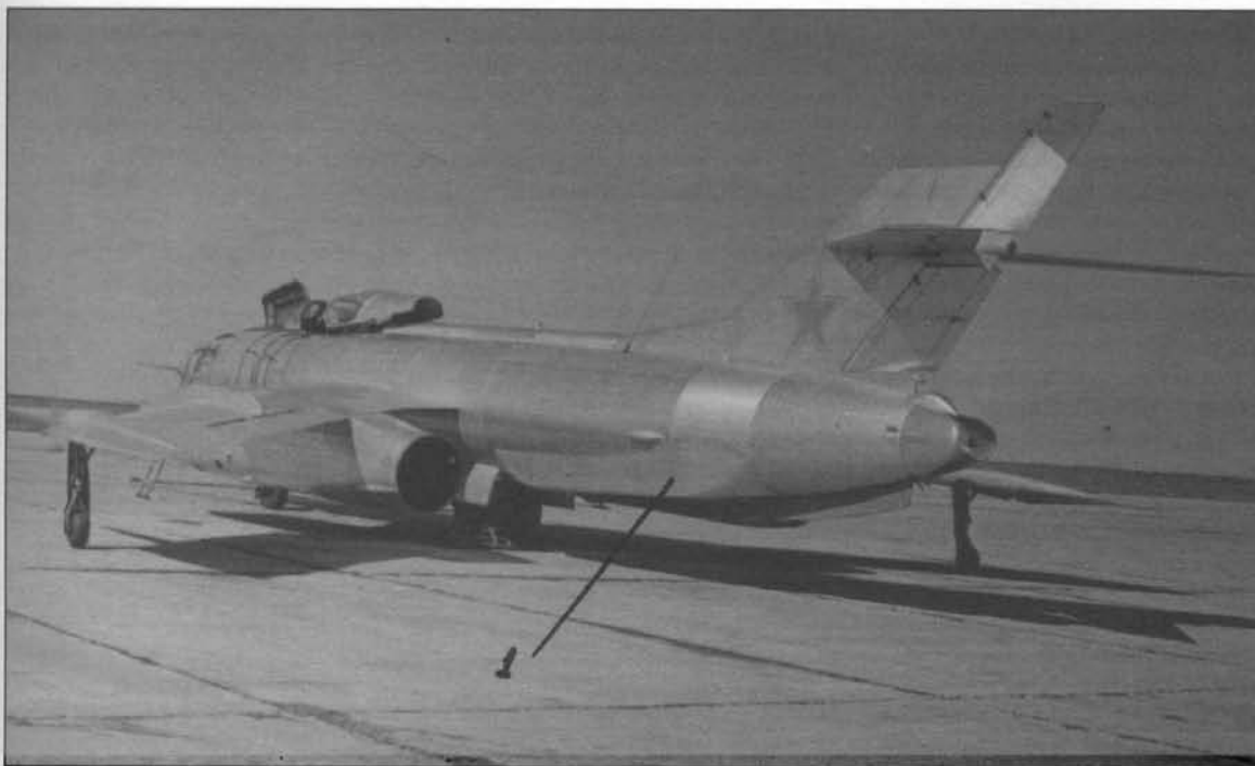
Отсек с камерными установками Як-27Р № 0407 оборудованного опытной разведывательно-корректировочной аппаратурой «Буревестник».
