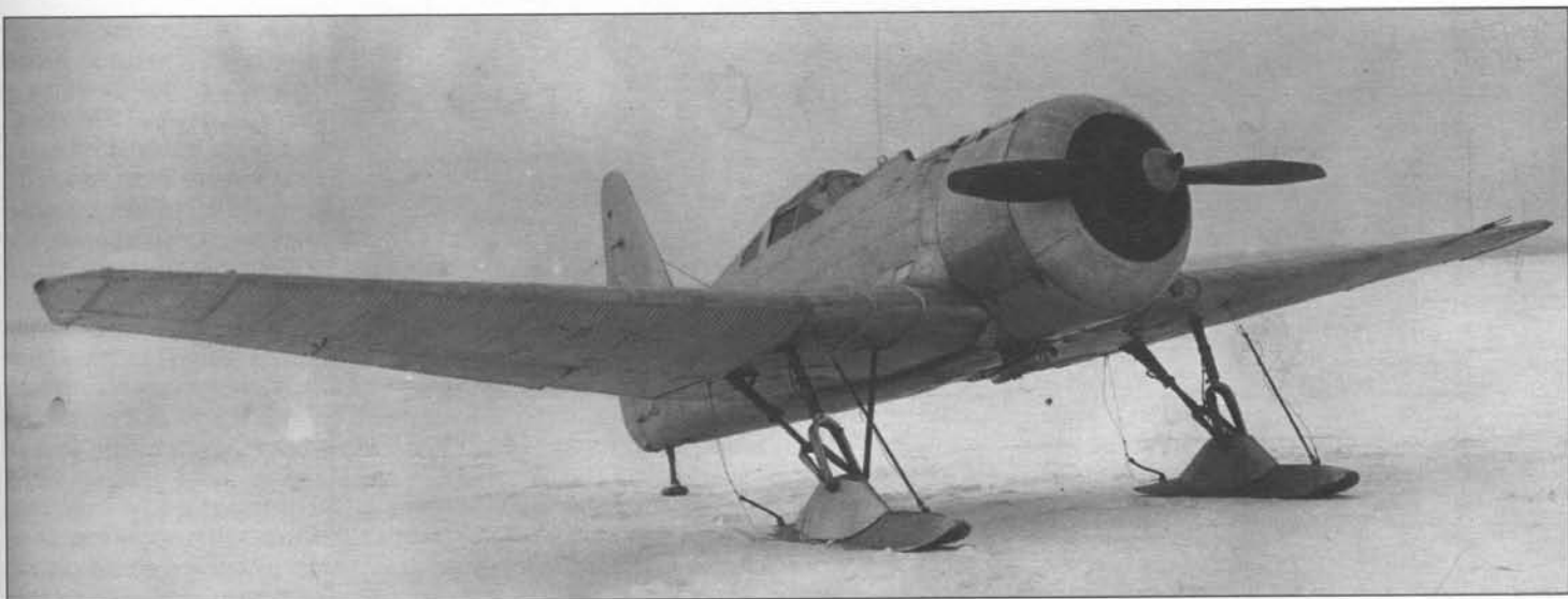
Первый опытный И-14 с гофрированным крылом не отвечал всем требованиям И. Варшавского.
