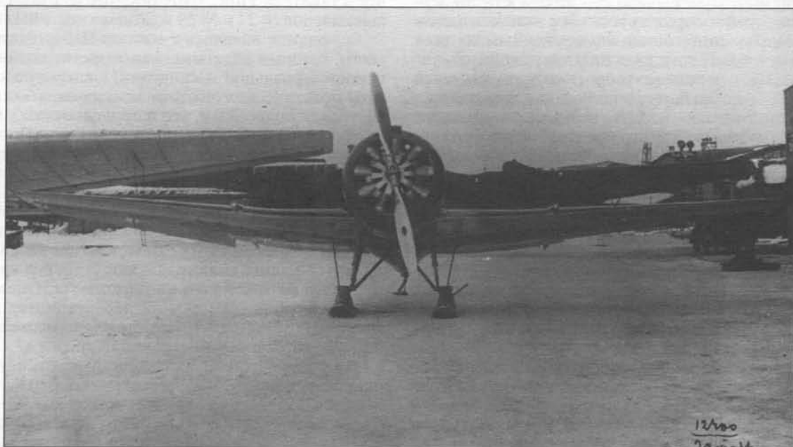
Цельнометаллический истребитель И-14бис с мотором «Райт Циклон» проходил испытания в марте-мае 1934 г. В отличие от первого опытного образца он имел крыло и хвостовое оперение с гладкой обшивкой.
