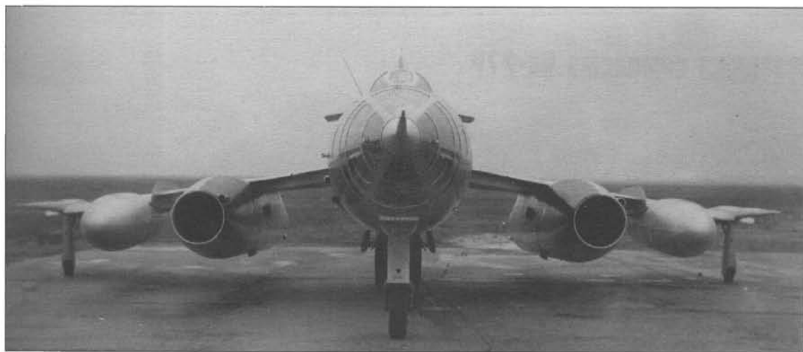
Як-27Р (бортовой № 25, заводской № 0710) с двумя подвесными топливными баками. 1962 г.
