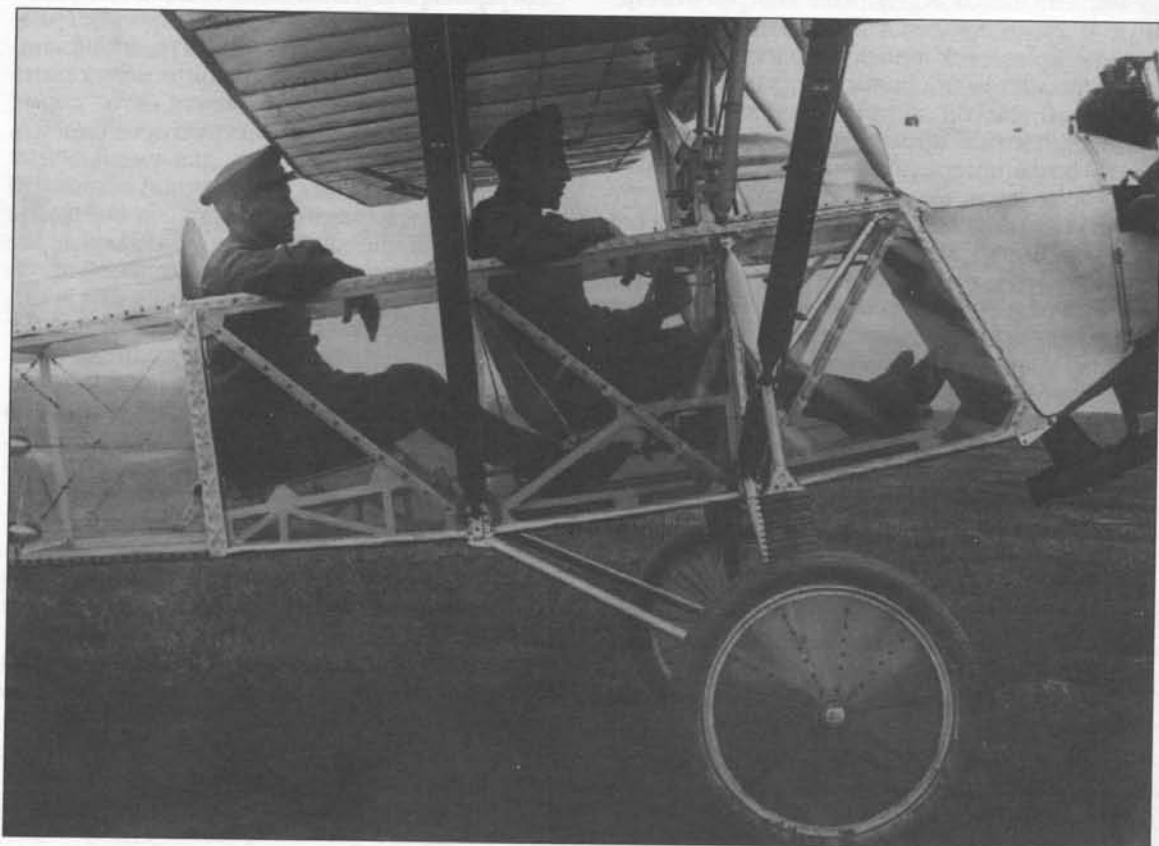
Прозрачные крылья и борта кабины ПС обеспечивали экипажу необыкновенный обзор.
