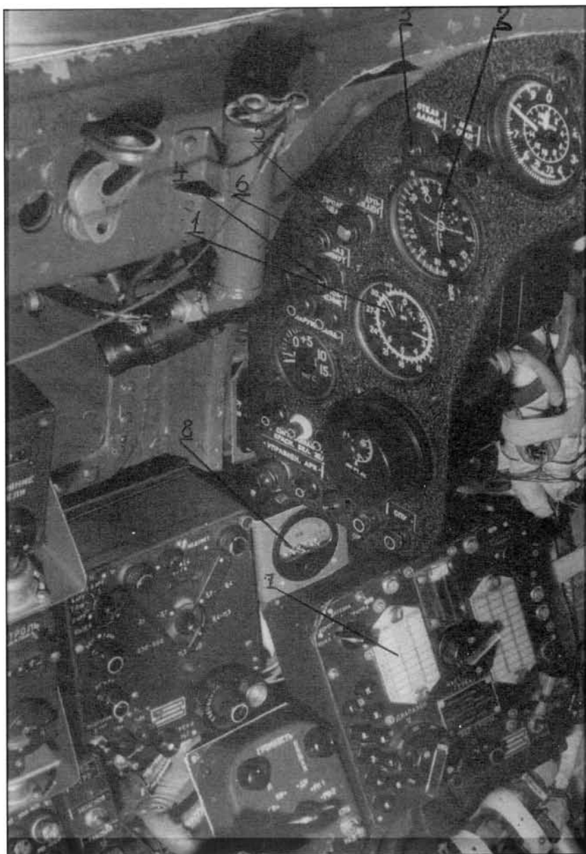
Приборная доска штурмана самолета Як-27Р.
