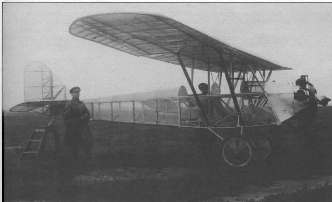
Самолет ПС с 60-сильным мотором «Сименс» SH-4 был переделан, вероятно, из АИР-4, имевшего до этого опознавательный знак «СССР-С480».
