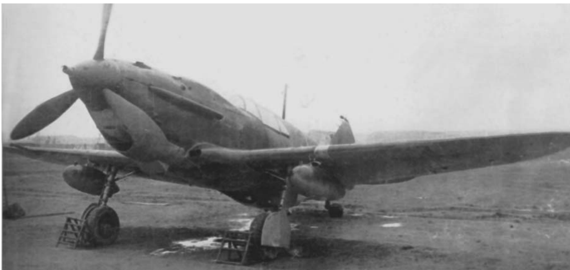
Самолет ЛаГГ-3 в модификации истребителя морской авиации дальнего действия
