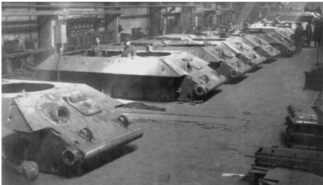
Сварка корпусов танка Т-34 на Уральском танковом заводе № 183 в Нижнем Тагиле
