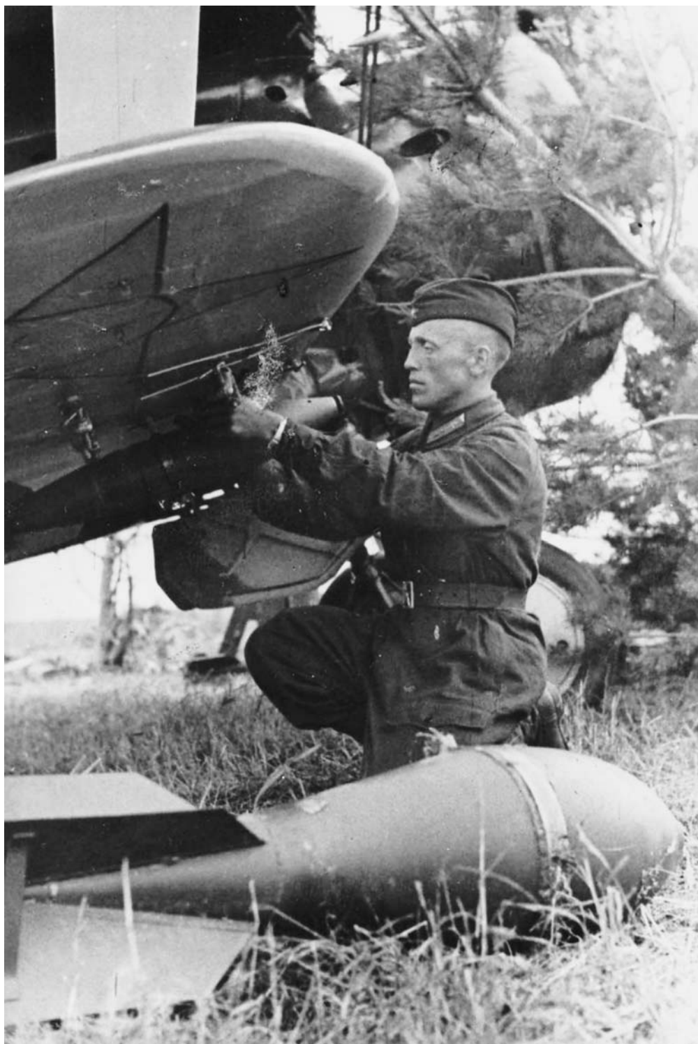
Авиатехник сержант Н. Крылов подвешивает реактивный снаряд под крыло истребителя И-153
