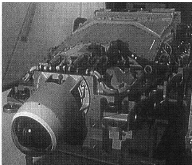
Моноблок лазерно-телевизионной прицельной системы «Кайра-23» (изделие 16С1)
