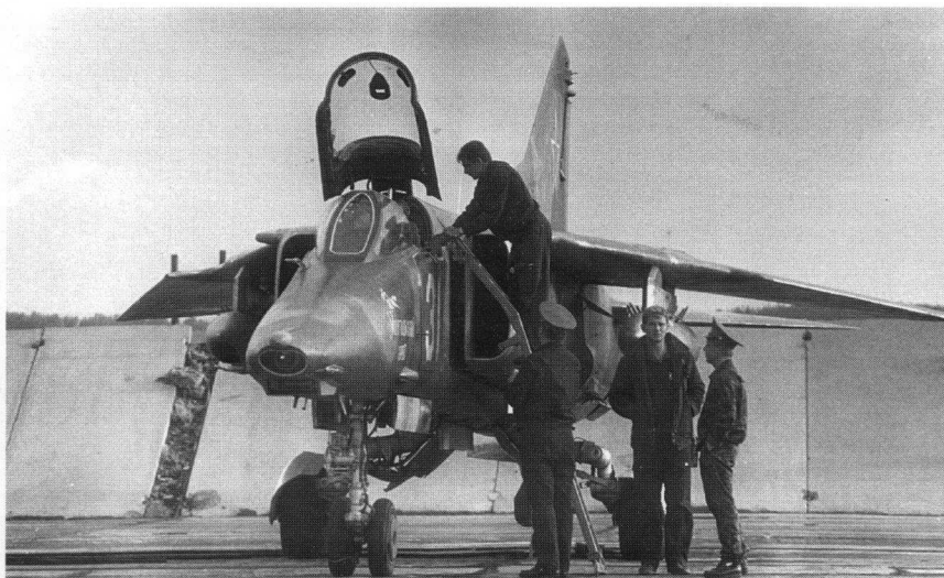
Технический экипаж выполняет послеполетное обслуживание МиГ-27К 266-й апиб. Аэродром Степь, лето 1990 г.
