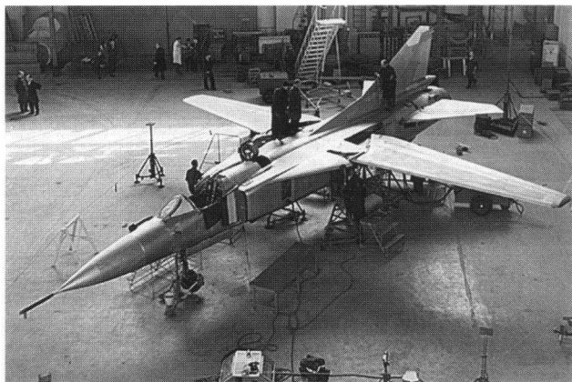
Первый прототип истребителя МиГ-23 («23-11») с крылом изменяемой геометрии в цеху опытного производства микояновского ОКБ
