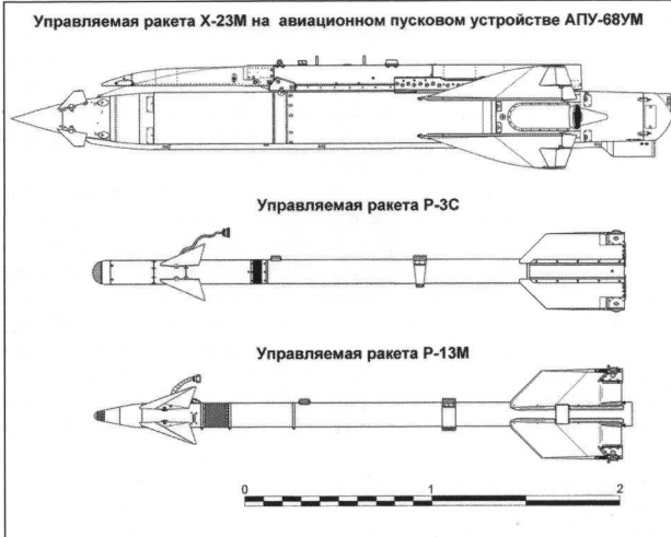
«Длинная рука» МиГ-27 – управляемая ракета X-23М (изделие 68М)
