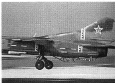
Посадочный гак в хвостовой части летающей лаборатории на базе МиГ-27
