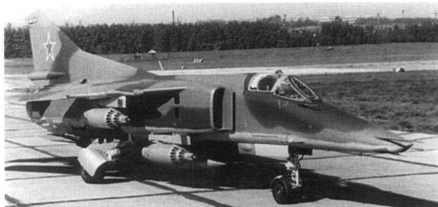
Заводской снимок МиГ-23 с четырьмя блоками реактивных снарядов УБ-32А и подфюзеляжным баком ПТБ-800
