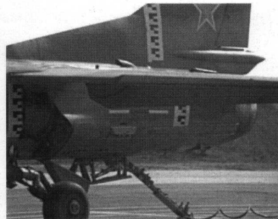
Зацепление гака МиГ-27 за трос аэрофинишера
