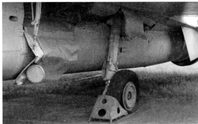
Основная опора шасси изделия «9-01»
