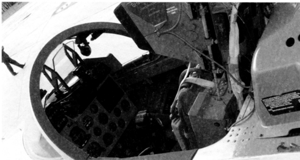
Доработанная кабина курсанта самолета L-39М с приборным оборудованием и прицелом истребителя МиГ-29
