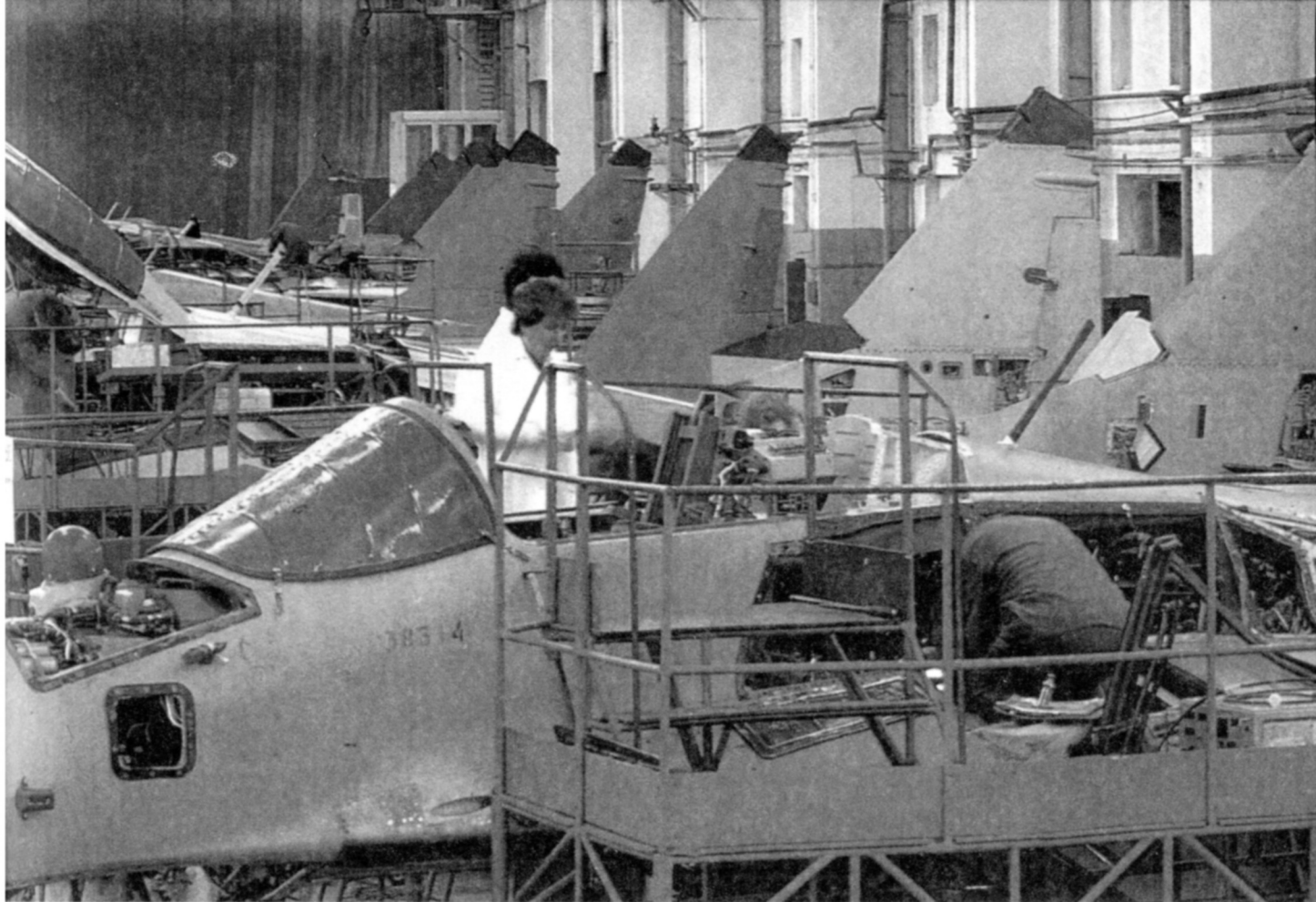
Сборка МиГ-29 в цехе № 38 Производственного центра РСК «МиГ»
