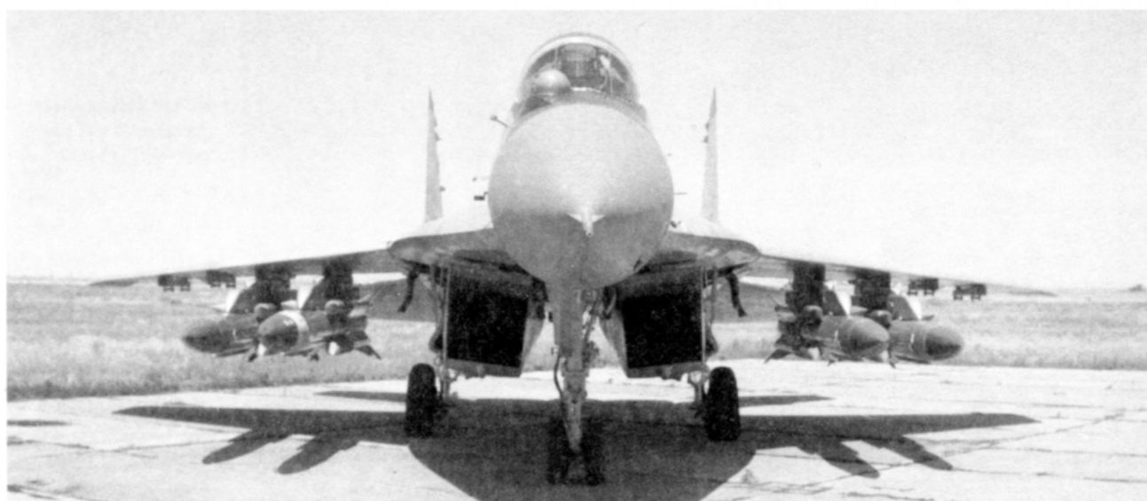
Пятый экземпляр МиГ-29М (изделие «9-15») №155 с противорадио- локационными ракетами Х-31П
