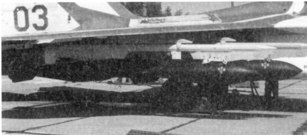
Фугасные авиабомбы ФАБ-250М-62 на крыльевых подвесках МиГ-29УБ. Аэродром нижегородского авиазавода «Сокол». 2003 год
