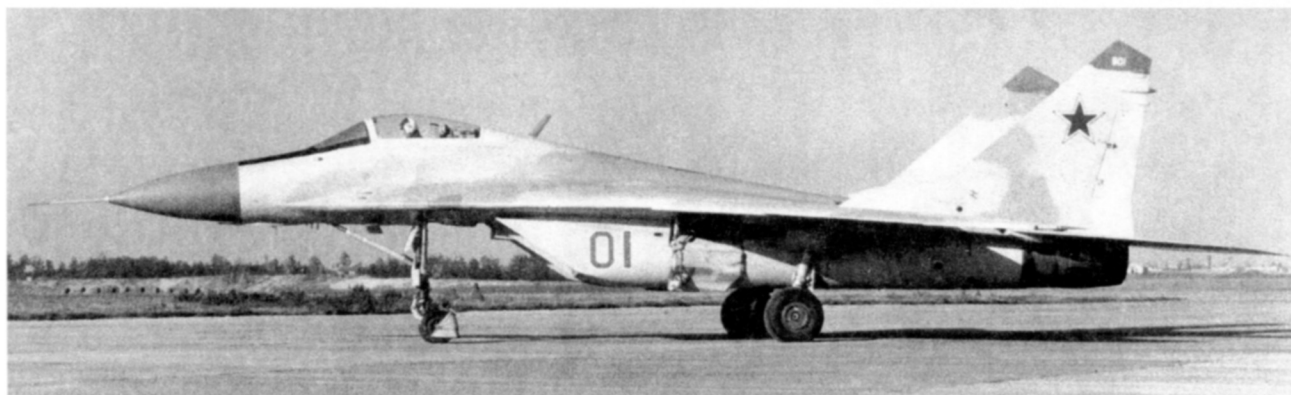
Первый прототип МиГ-29 (изделие «9-01») без квантовой оптико-локационной станции (КОЛС) на аэродроме ЛИИ
