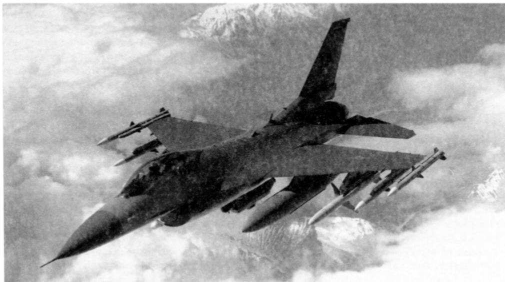
F-16 с четырьмя ракетами AIM «Спэрроу» класса «воздух — воздух» и двумя противорадиолокационными HARM
