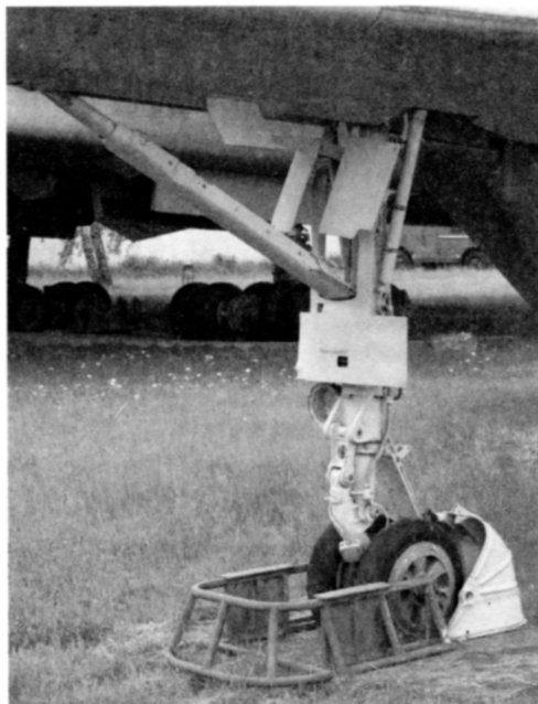
Передняя опора шасси изделия «9-01»
