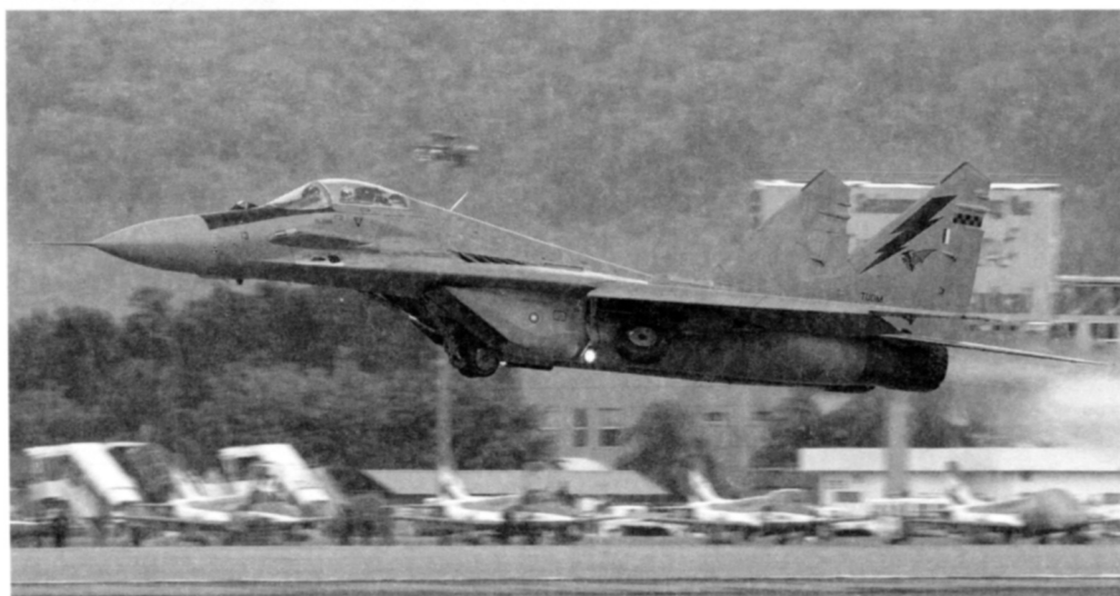
МиГ-29Н (МиГ-29СД) ВВС Малайзии доработаны устройством для дозаправки топливом в воздухе
