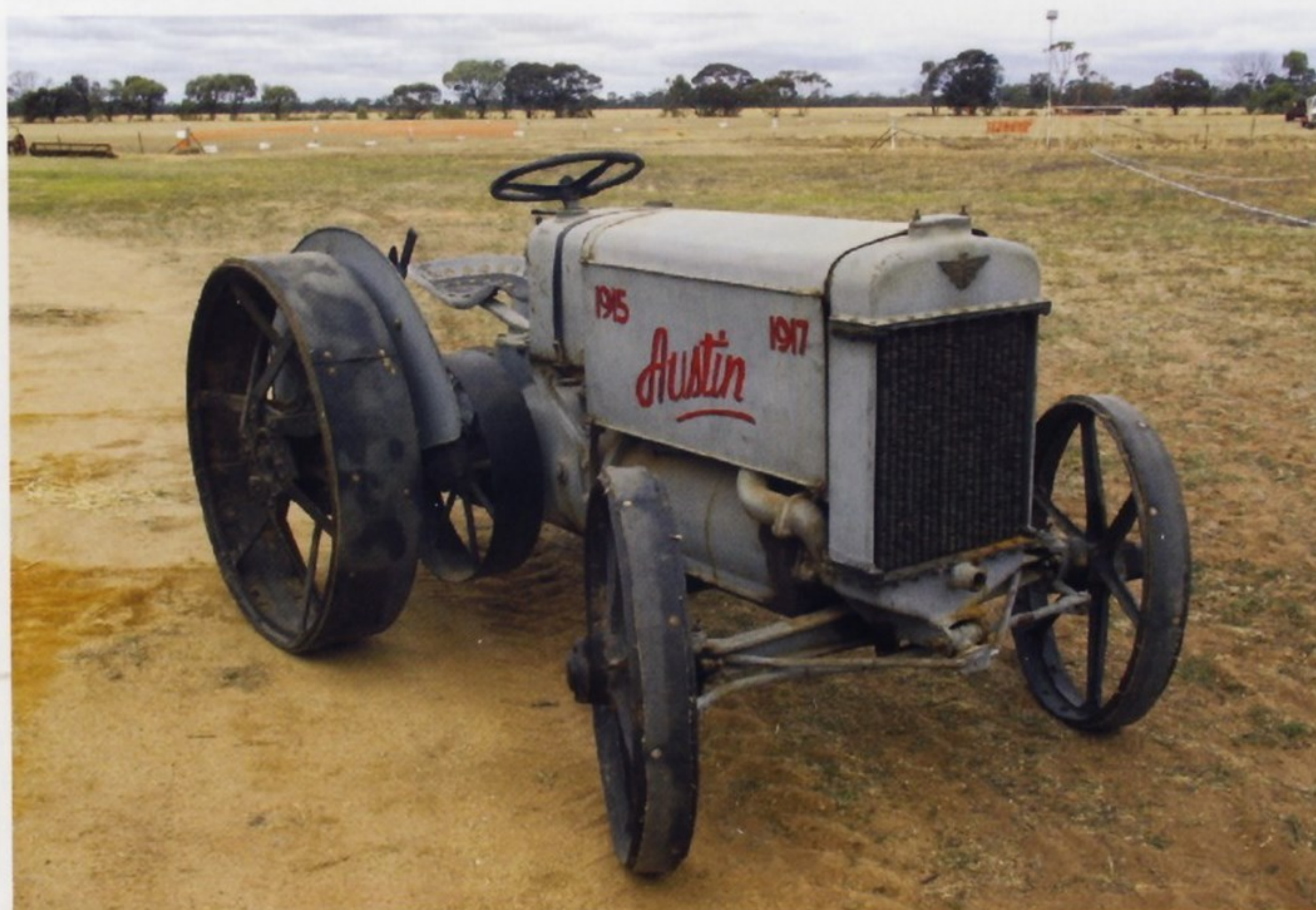
Первые тракторы Austin имели четырехцилиндровый двигатель с диаметром цилиндра 95 мм и ходом поршня 127 мм. Он мог работать на парафине.
