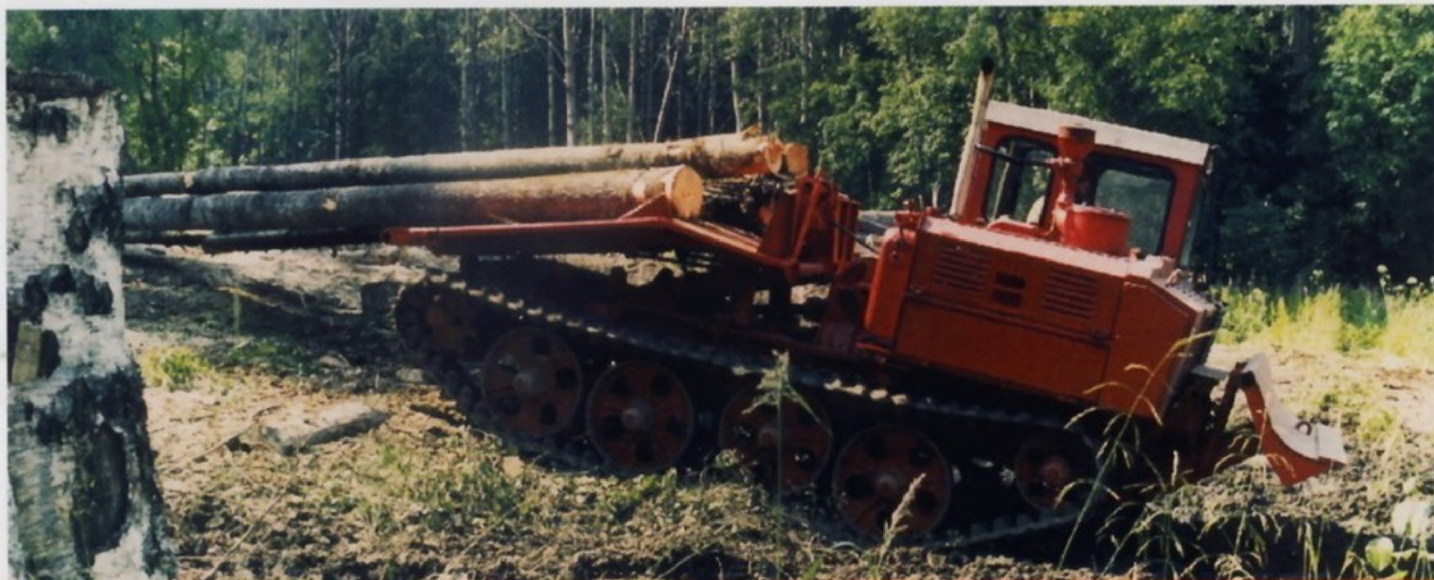
Направляющие колеса с механизмами натяжения и амортизации обеспечивают устойчивость трелевочному трактору ТДТ-55А, которая так необходима при работе на пересеченной местности.
