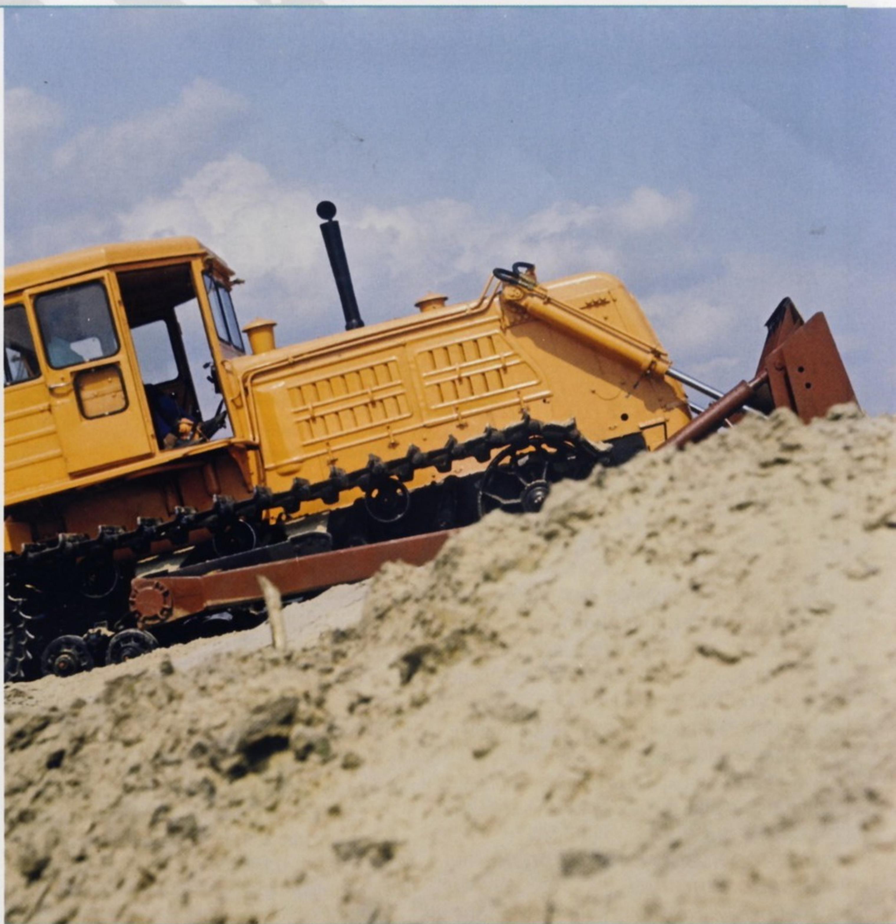
Бульдозер Д-521 Брянского завода дорожных машин, созданный на базе Т-140.
