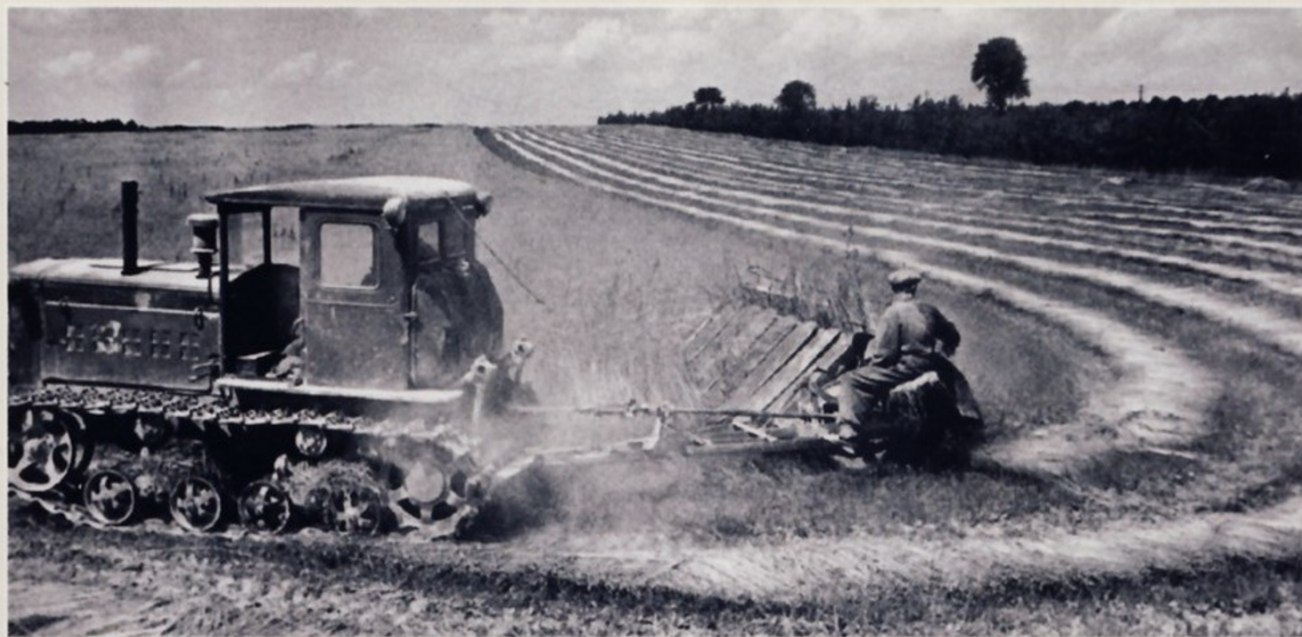
Трактор ДТ-75, спроектированный в 1959 году, агрегатировался более чем со 100 сельхозмашинами и орудиями.
