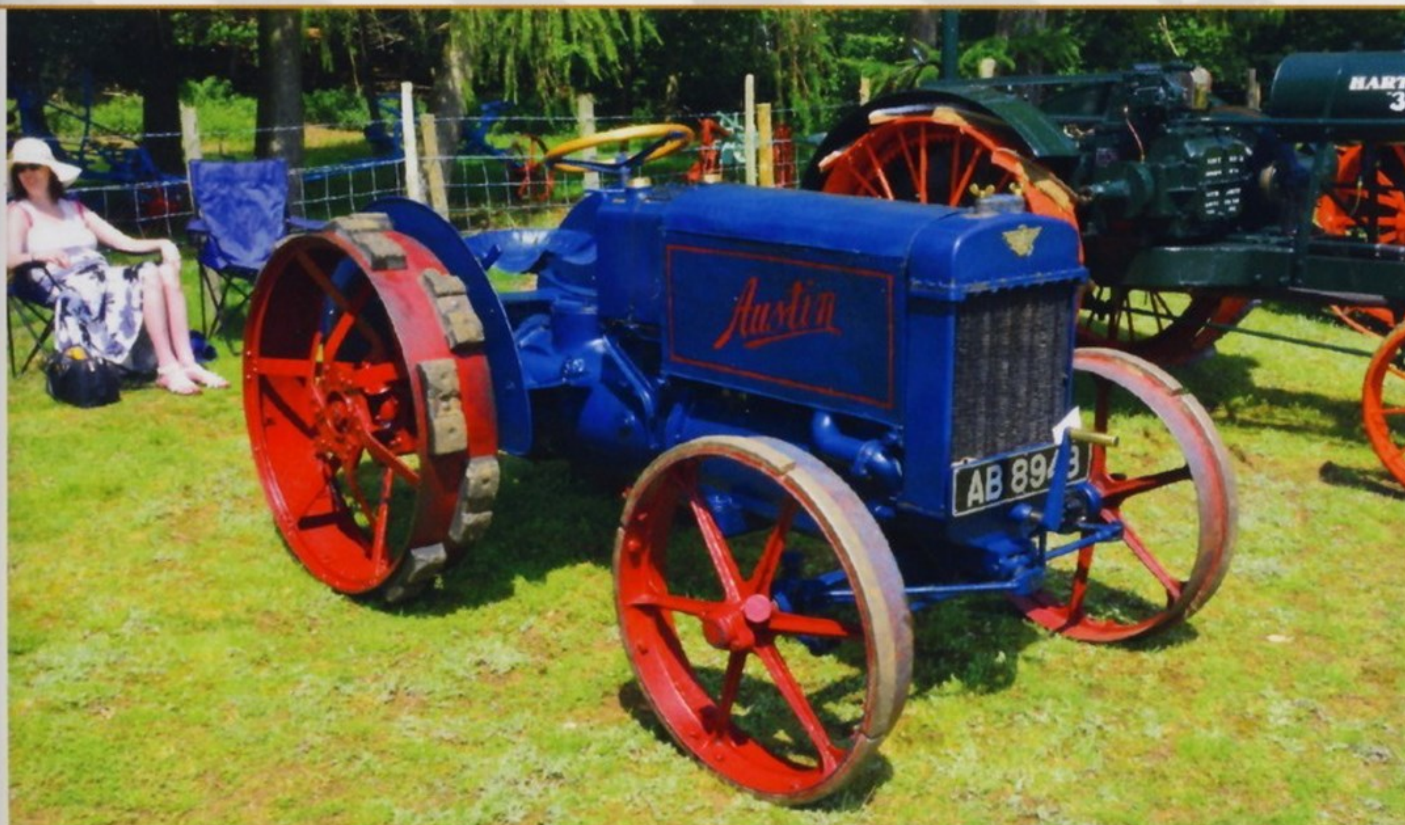
В 1920-х годах Austin 15/25 был конкурентом трактора Fordson F во Франции. Обе модели имели моноблочную конструкцию с двигателем, коробкой передач и мостом, расположенными в линию под герметичными картерами.
