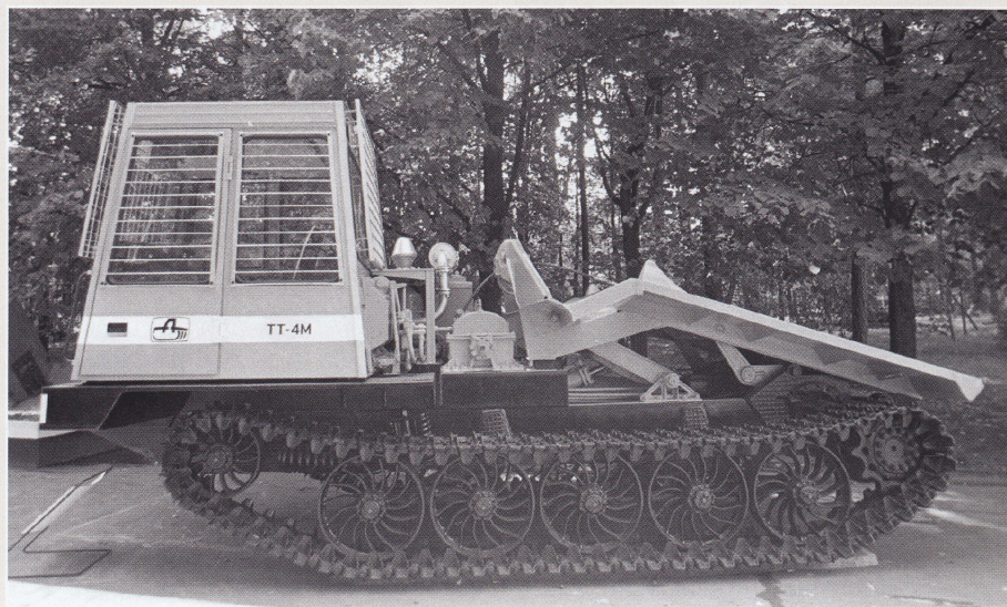
Проходимость и маневренность трелевочного трактора повышается за счет мелкозвенчатой гусеничной ленты, набранной из большого количества траков.
