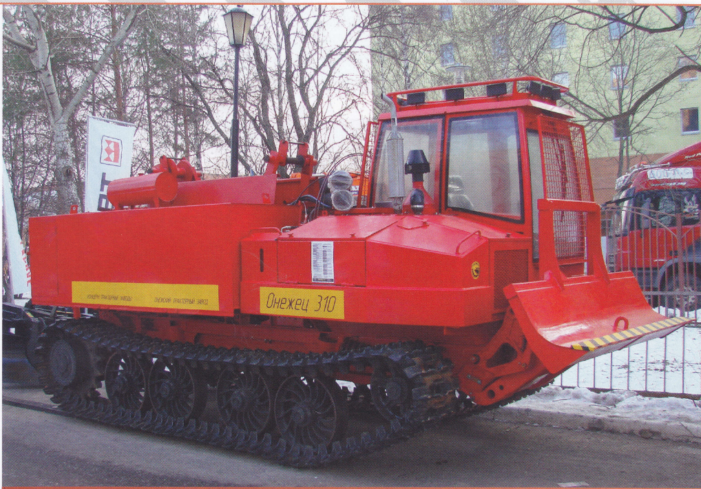
Каркас безопасности кабины лесопожарной машины «Онежец-310» на базе трактора «Онежец-300» отвечает требованиям международных стандартов, а переднее и заднее окна защищены металлическими сетками.
