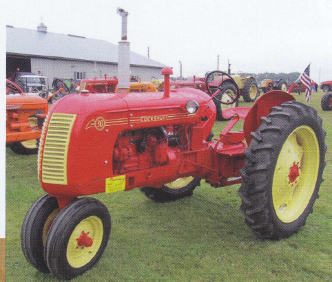
Трактор Cockshutt 30 отличался близко установленными передними колесами.
