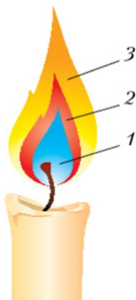
Рис. 8. Строение пламени. Разные зоны обозначены различными оттенками: 1 – тёмное, негорячее; 2 – яркое, горячее; 3 – менее яркое, самое горячее
