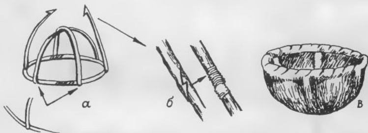
Рис. 30. Устройство лодки из плащ-палатки: а – изготовление каркаса; б – крепление прутьев для каркаса; в – общий вид
