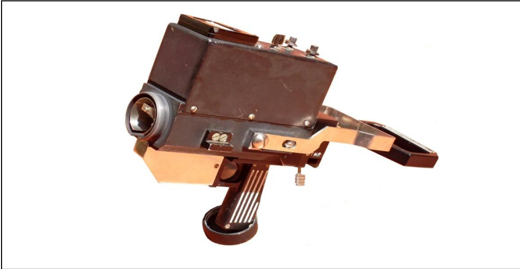
Рис.8.2. Переносной измеритель интегральной плотности заряда воздуха.
