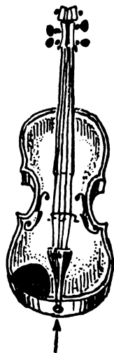
Духовой камертон монтируется вот здесь, где у скрипки находится пуговица для закрепления подгрифа.
