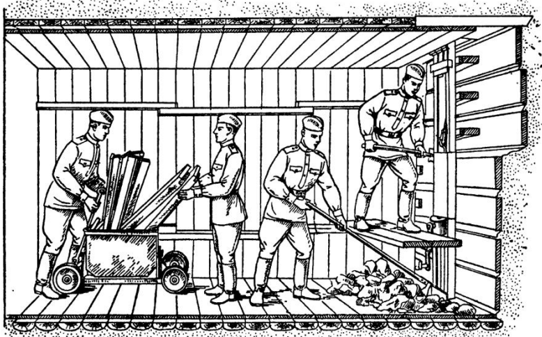
Рис. 45. Общий вид проходки с легким потолочным щитком и переносной стойкой
