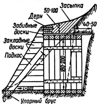
Рис. 53. Оголовок горизонтального входа при угле наклона местности свыше 30^\circ в слабых грунтах
