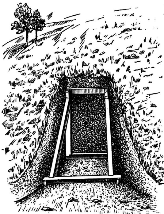
Рис. 25. Установка входной брусчатой рамы и элементов крепления во врезке
