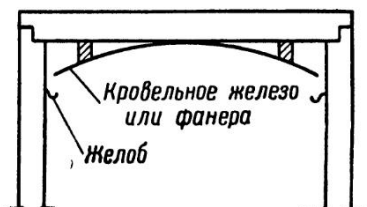
Рис. 65. Отвод грунтовых вод в полевых подземных выработках посредством зонтов
