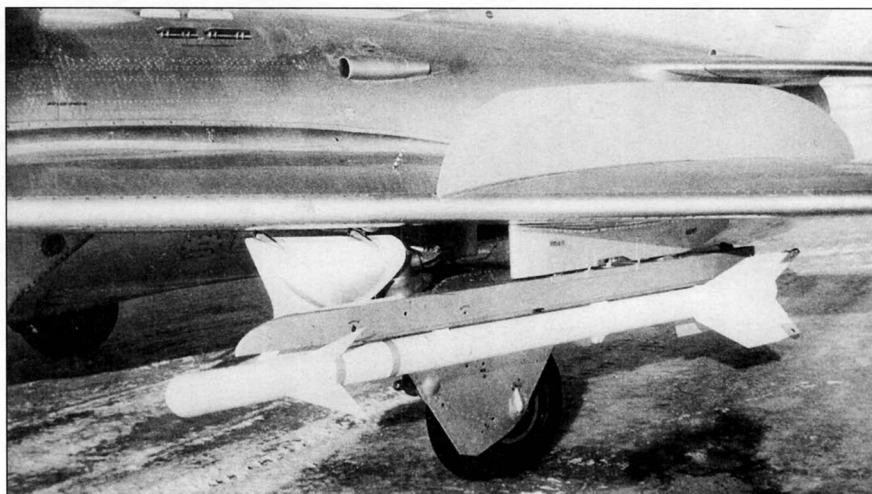
Серийные ракеты Р-3Р (К-13, сверху) и Р-13М, созданные на основе AIM-9В «Сайдуиндер» Справа: Ракета К-13 из опытной серии под крылом МиГ-19. 1959 г.
