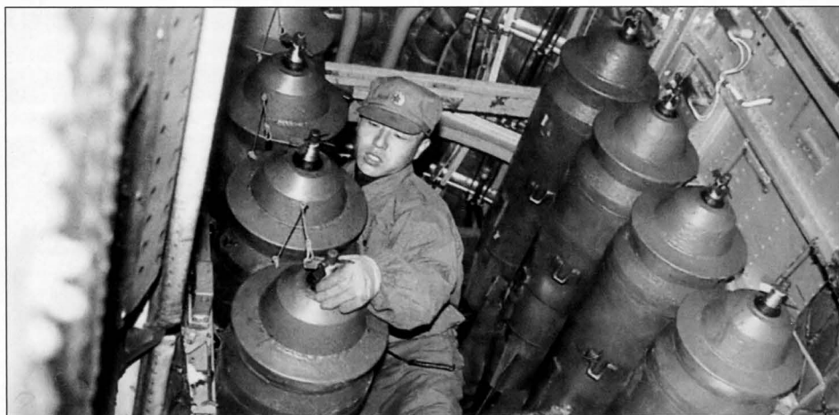
Загрузка бомб в бомбоотсеки стратегического бомбардировщика Н-6 (Ту-16) ВВС НОАК На левом снимке — бомба калибра 3000 кг, однако в отсеке помещалась и 9000-кг бомба
