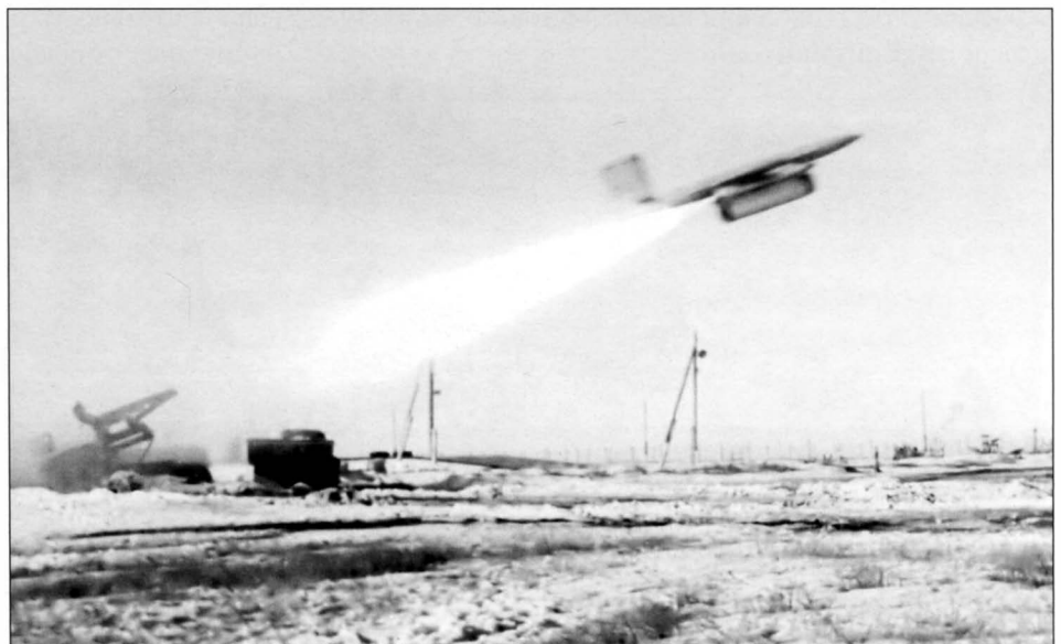
Старт мишени Ла-17М с наземной пусковой установки
