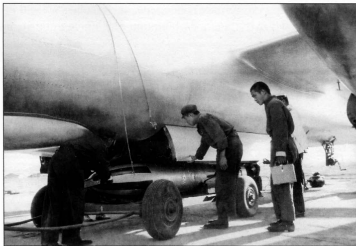
Сверху: Подвеска торпеды под бомбардировщик Н-5 (Ил-28) авиации ВМФ НОАК
