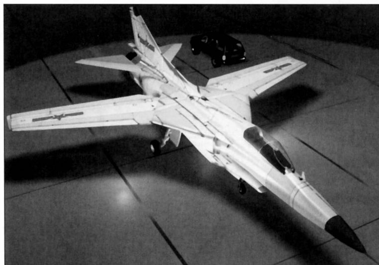
Модель штурмовика Q-6 с крылом изменяемой геометрии — влияние концессии МиГ-23
