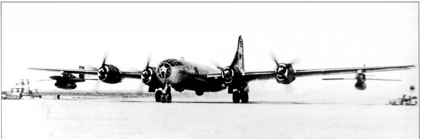
Самолёт-носитель Ту-4НМ с двумя мишенями Ла-17 под крыльями
