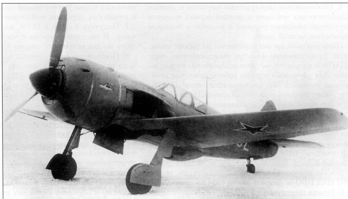
Советский истребитель Ла-9 с мотором АШ-82ФН. Поступил на вооружение ВВС СССР в 1946 г.
