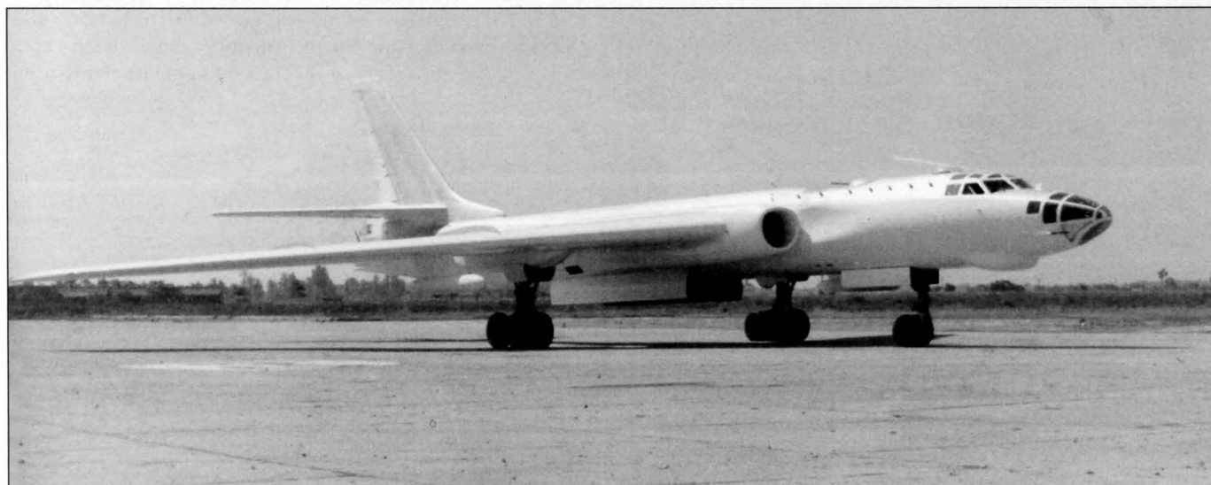
Атомный бомбардировщик Н-6, собранный в КНР из комплекта советских узлов и агрегатов
