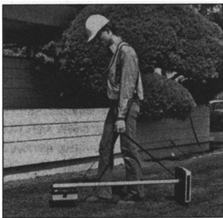
Рис. 18. Глубинный металлоискатель Geminy-3 фирмы Fisher
