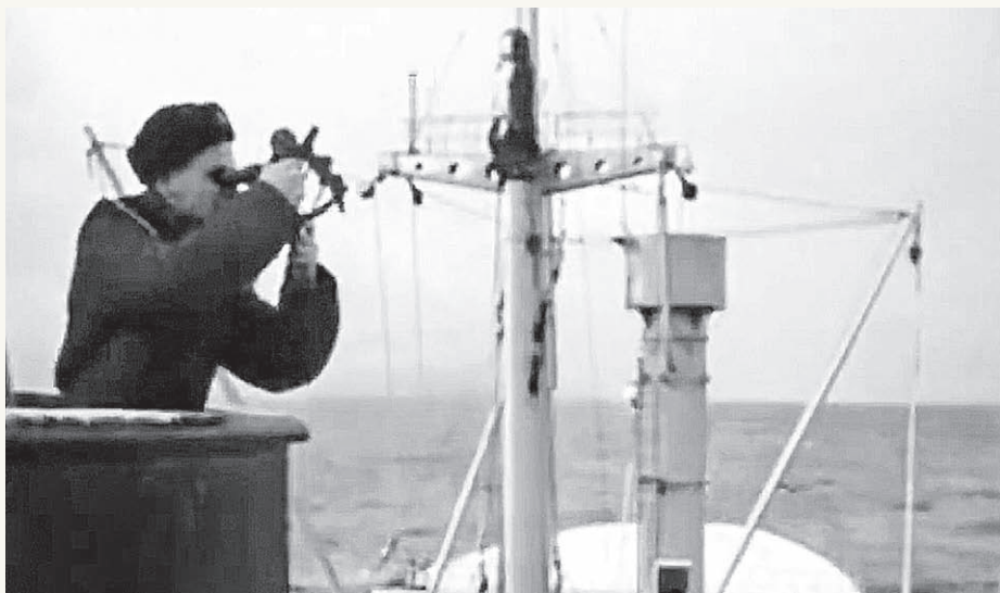
▲ Определение географических координат с помощью секстанта
