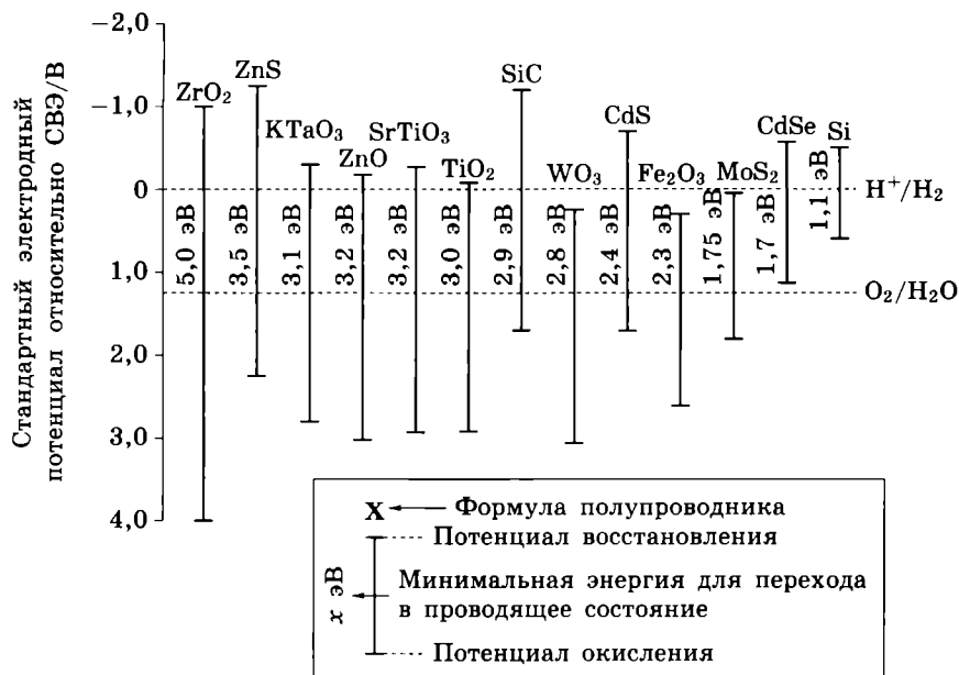
Рис. 4.18. Энергии перехода в проводящее состояние и электродные потенциалы различных полупроводников. Пунктирными линиями обозначены потенциалы окисления и восстановления воды
