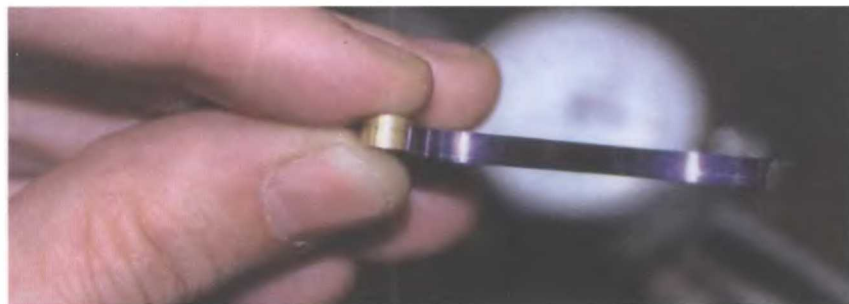
Автор наносит Dyken на грань черенка и чертит линию, где будут расположены оправы с драгоценными камнями.
