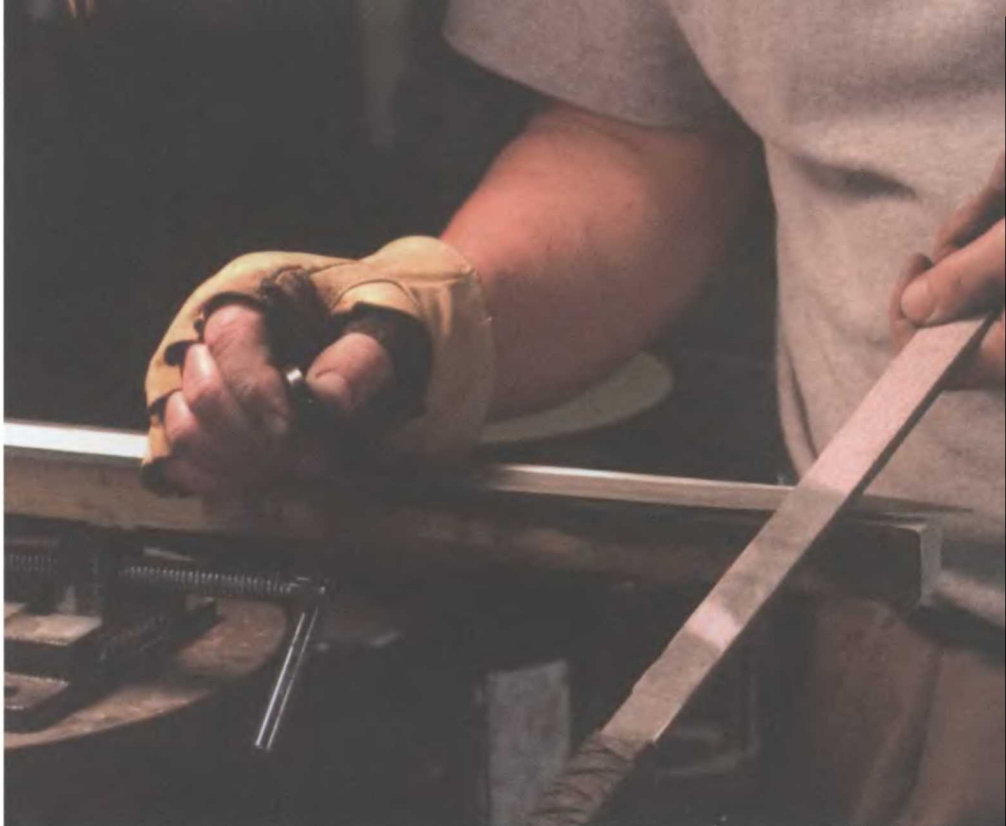
Для дальнейшей полировки клинка автор использует наждачный стержень.
