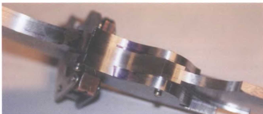
Нижняя часть черенка уже сравнена с корпусом рукоятки, но закругленные части черенка и рукоятки все еще следует доработать
