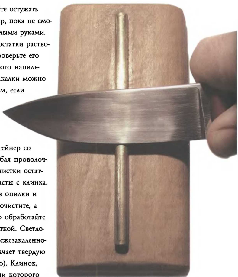
Так автор проводит тест на латунном стержне.
