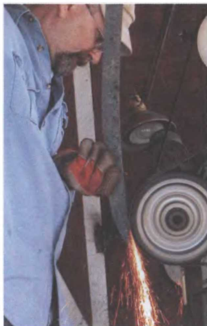
Теперь он профилирует острие клинка.
