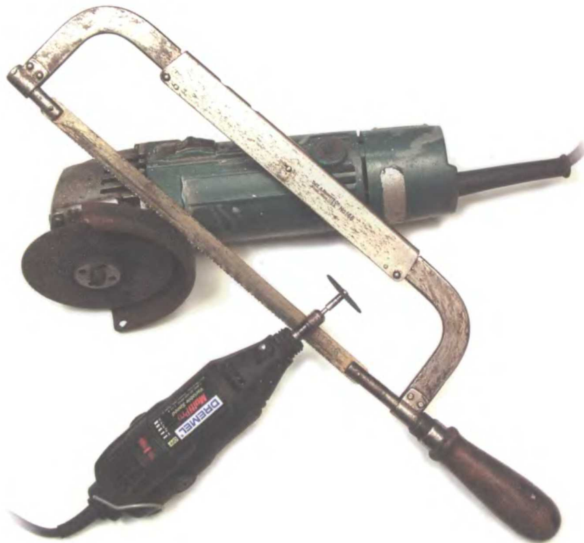
На фото показаны три способа резки стальной заготовки
