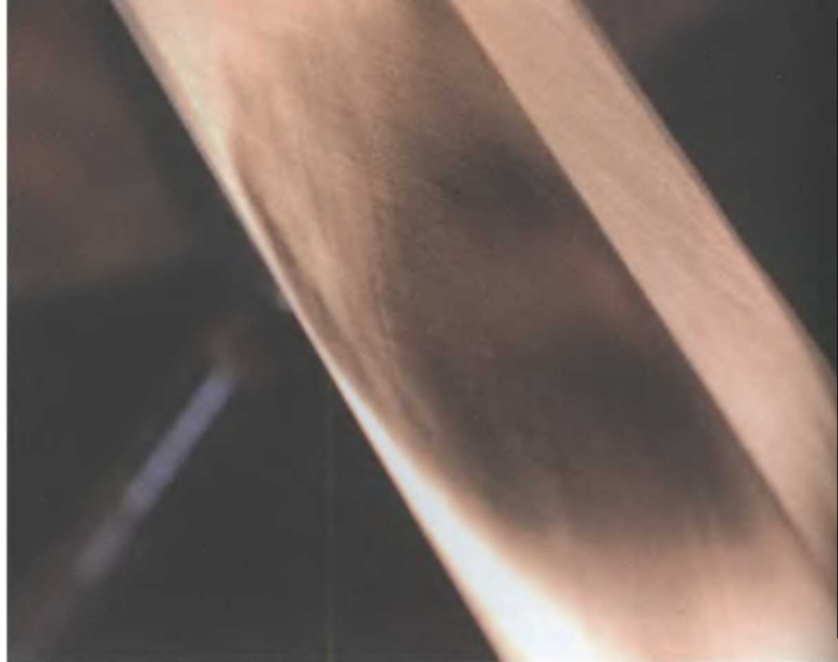
На фото показан рисунок диагональных царапин наждака зернистостью 400 на клинке меча.
