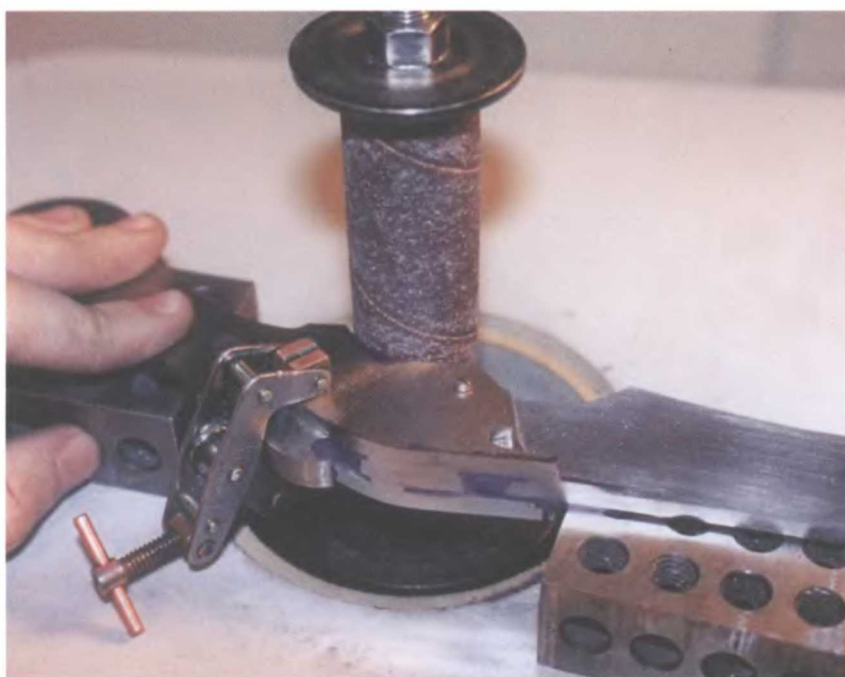
Шпиндельный шлифовальный станок прекрасно подходит для сглаживания нижней части черенка вровень с корпусом
