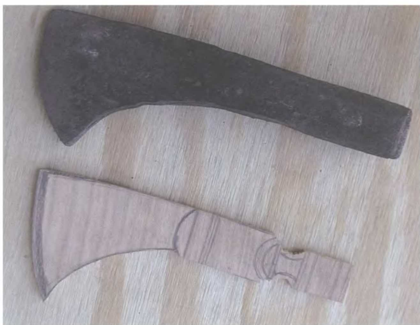
Автор использует деревянную матрицу в качестве шаблона, когда выковывает форму головки
