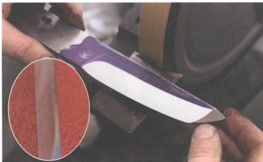
Линия шлифовки приближается к начерченной линии, но грань все еще достаточно толстая.
