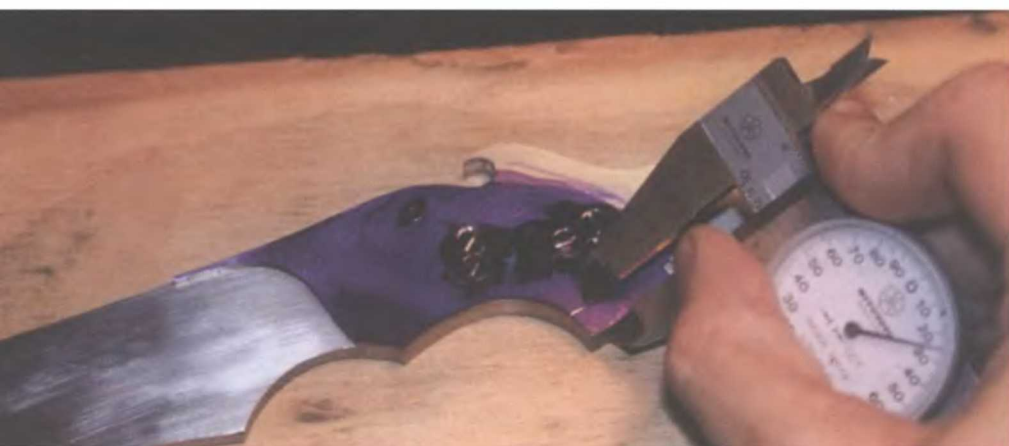
С помощью кронциркуля автор измеряет и слегка помечает места, где намерен расположить тыльную нижнюю сторону черенка на рукоятке
