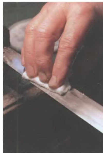
Последняя стадия полировки, когда автор протирает клинок пемзой на ватном тампоне.
