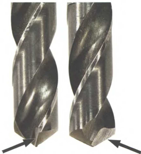
Это сверло предназначено для латуни. Обратите внимание на различный вид того же сверла
