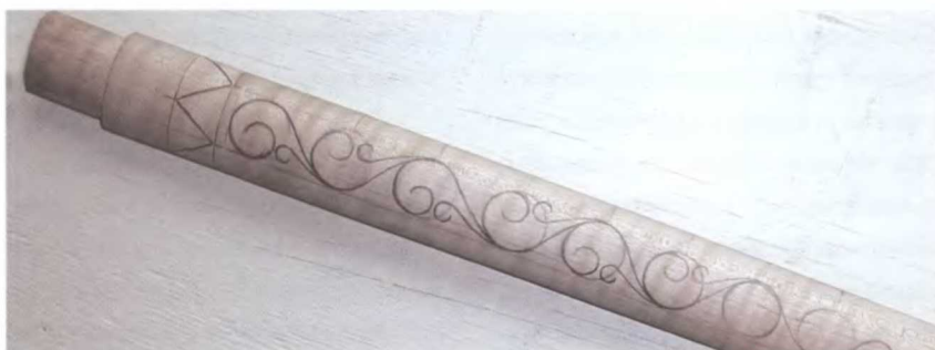
Автор рисует одинаково расположенные одноразмерные круги по всей длине конусной рукоятки. Эти окружности станут основой флористского дизайна или рисунка завитков
