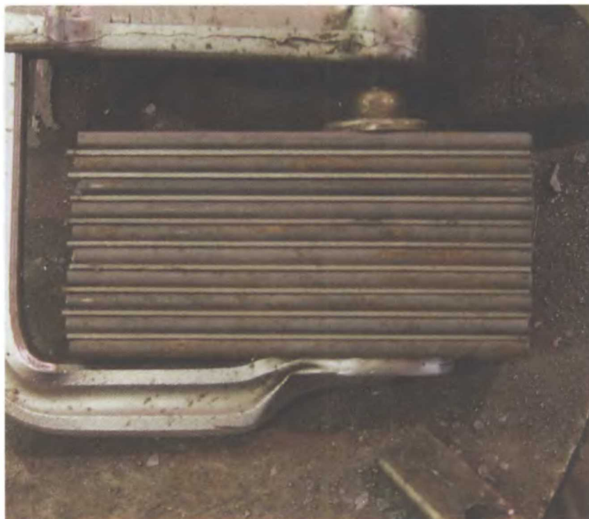
Девятнадцать слоев стали 1084 и 15N20 уложены вместе, причем более толстая сталь 1084 расположена сверху и снизу. Это позволяет избежать деформации более тонкой стали 15N20 при нагреве
