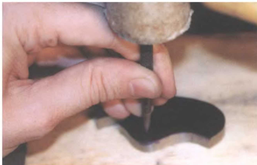
Автор устанавливает кернер на перекрестье и отмечает места отверстий
