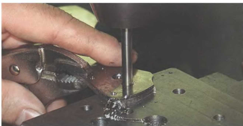
Лайнер запирающей стороны со всеми просверленными отверстиями используется как шаблон для перенесения разметки отверстий на черенки.
