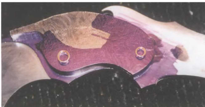
Автор удаляет зажим, рисунок и пленку с верхней части многослойного черенка. Теперь он наносит на верхнюю плоскость слой Dykex.
