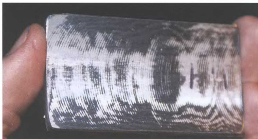
На фото показана задняя (дно) сторона фронтального черенка. Хорошо видны следы грубой обработки, которые необходимо заровнять
