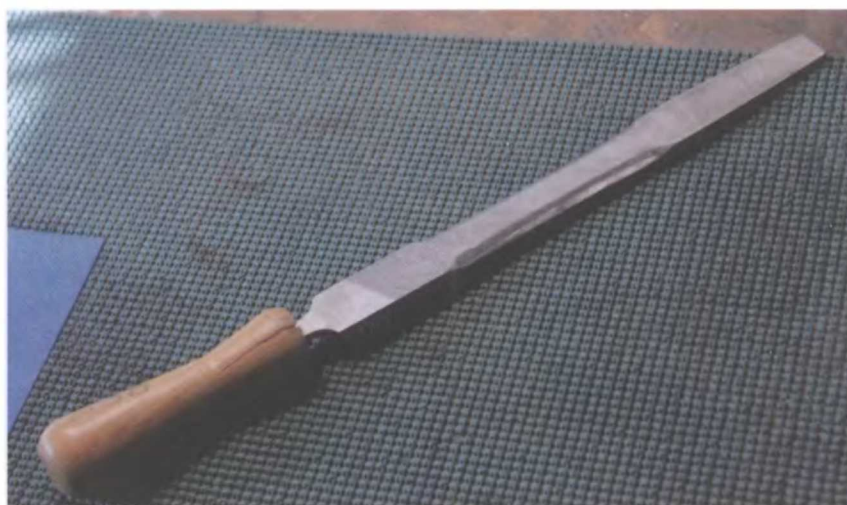
Это сен, или шабер, который автор выковал из старого напильника.
