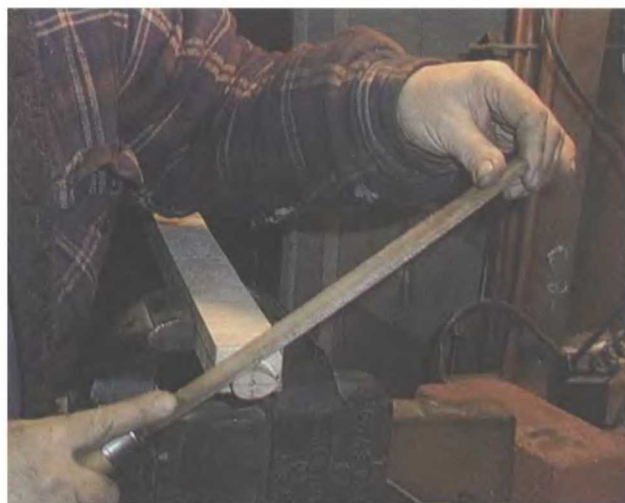
Рукоятка подгоняется под томагавк напильником вручную.
