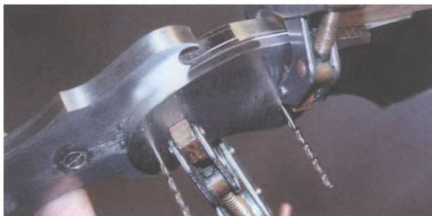
Нижний черенок фиксируется на корпусе с помощью двух зажимов.
