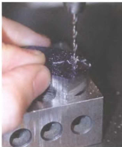
Автор приподнимает деталь к сверлу, помещая черенок на точный блок.
