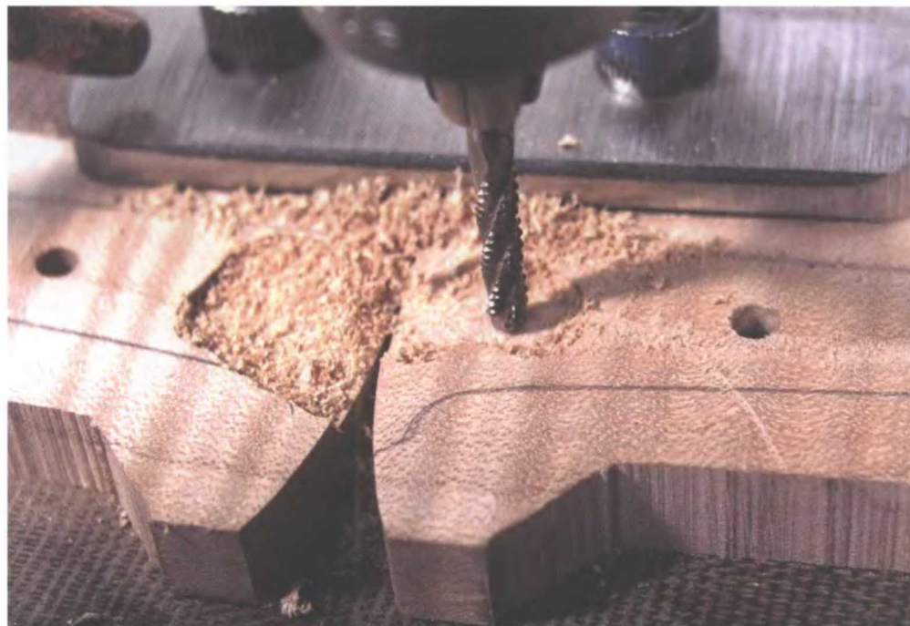
Вверху показан крепеж для фрезеровки рукоятки, а слева — сам процесс крупным планом
