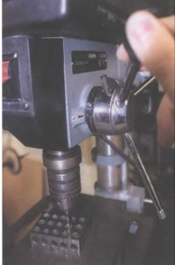
Автор устанавливает и фиксирует на сверлильном станке глубину прохода, чтобы она совпадала с необходимой ему глубиной отверстий, просверленных для вставок.
