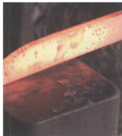
Один из способов очистить поверхность от окалины – намочить наковальню и молоток на этой стадииковки. Пре-вращаясь в пар, вода быстро сдувает окалину.
