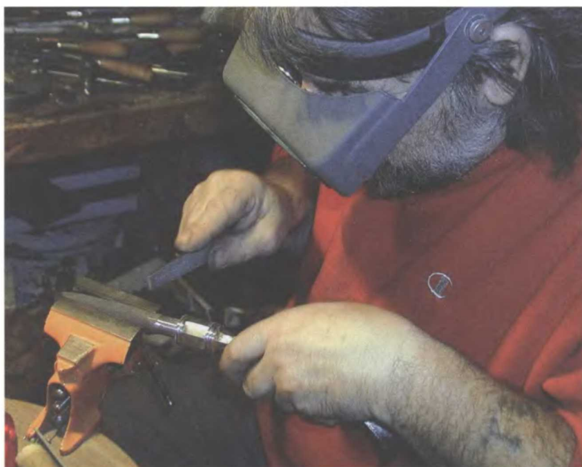
Томагавк имеет два молдинга, один сверху, а другой снизу обуха. Автор нарезает две линии молдингов с помощью треугольного напильника.
