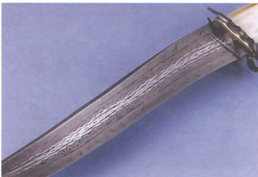
Кузнецы Вейд Колтер, Шейн Тейлор, Барри Галлахер и Рик Данкерли совместно создали этот композитный клинок из шести блоков.
