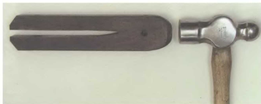
На фото показан толкатель для гарды и молоток со сферическим бойком.
