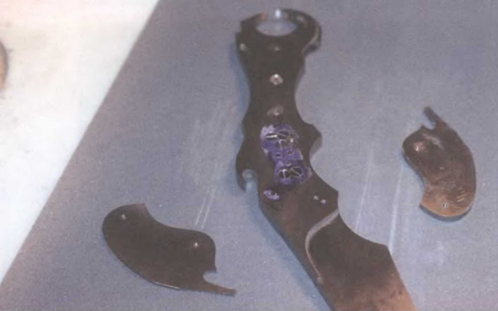
Передние верхний и нижний черенки привинчиваются к сердцевине рукоятки.
