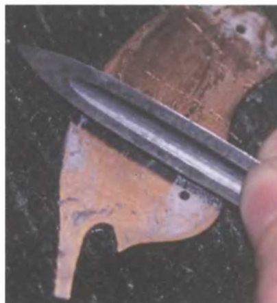
С помощью скребка автор счищает остатки клейкой ленты со всех поверхностей деталей черенка.
