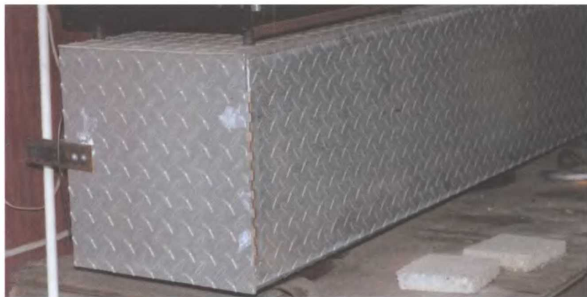
На фото изнутри и снаружи показана печь автора для отпуска стали.
