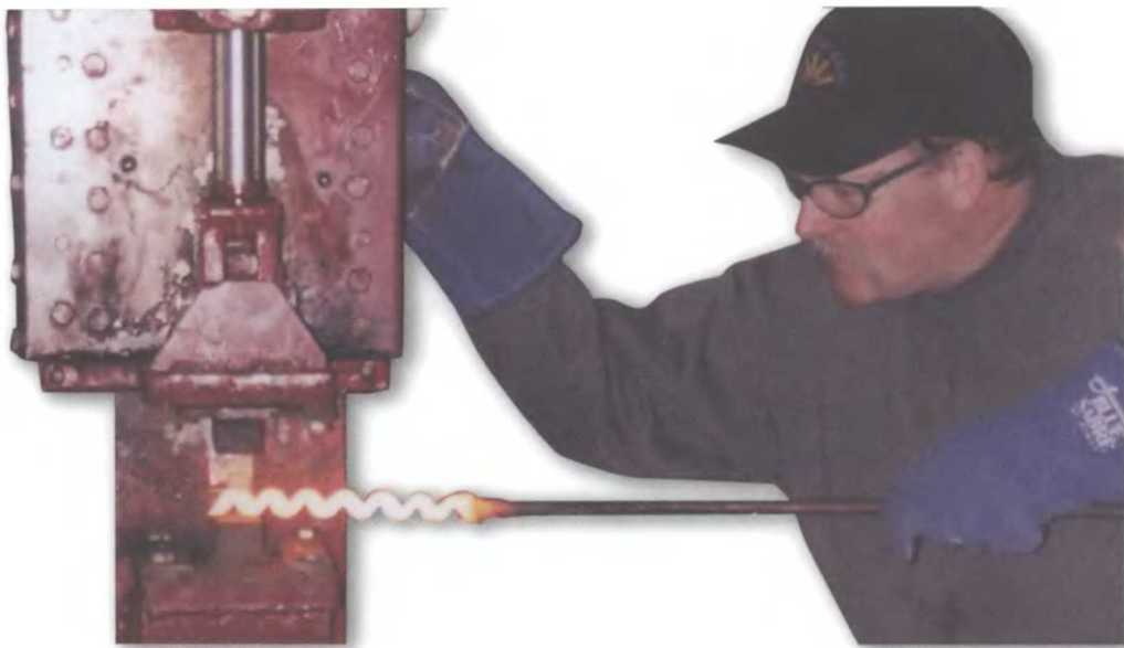
Автор выравнивает блок дамасской стали в стиле аккордеон на гидравлическом прессе.
