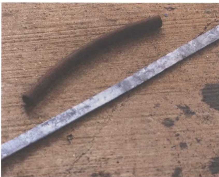
Следы от молота показывают, как автор разбивает заготовку клинка.
