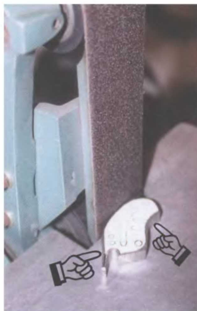
С помощью заднего упора и стола на шлифовальном станке Burr King автор зачищает округлости черенка.
