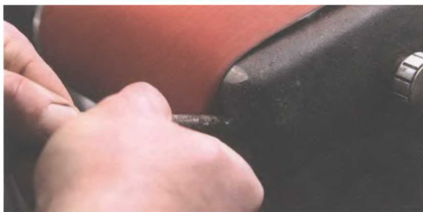
Автор сглаживает край ленты с помощью грубого бруска и устанавливает дорожку ленты так, чтобы \frac{1}{4} дюйма ленты свисала над упором.
