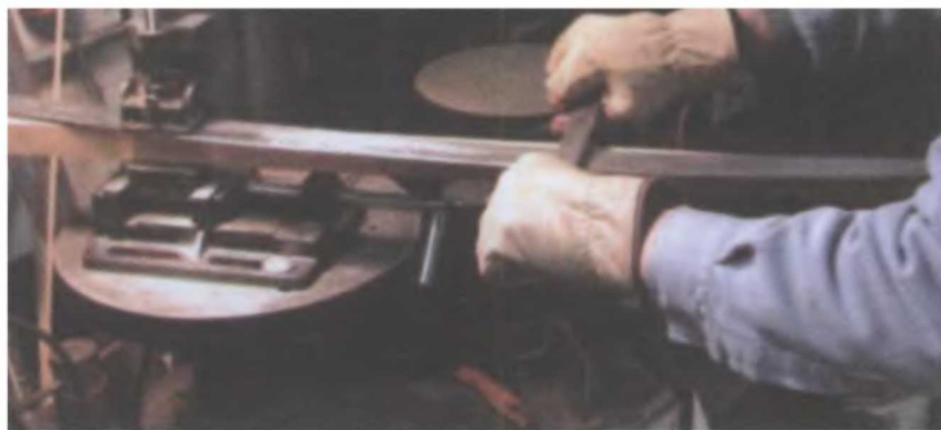
Следующий этап — шабером обрабатываются скосы.
