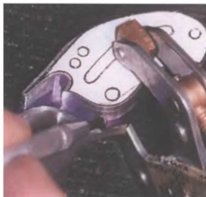
Две отметки показывают место расположения черенков на рукоятке.
