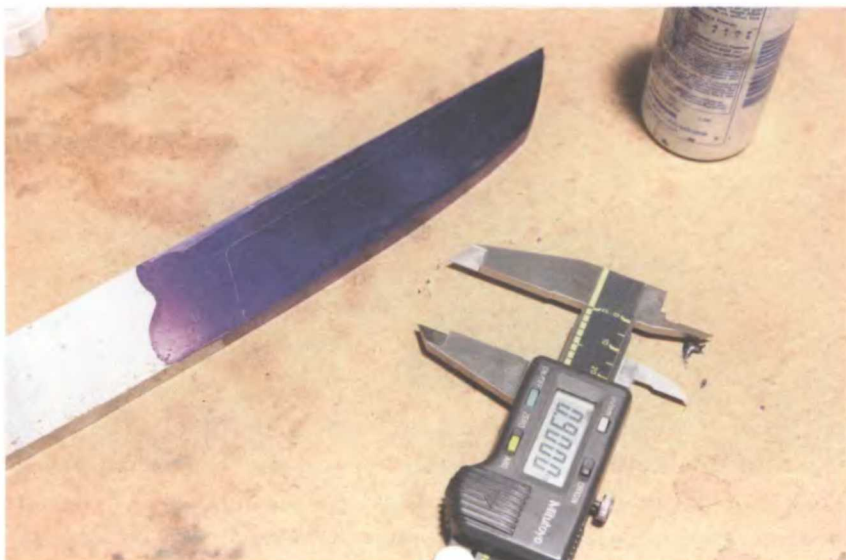
Предстоящая шлифовка клинка полностью определена на заготовке клинка
