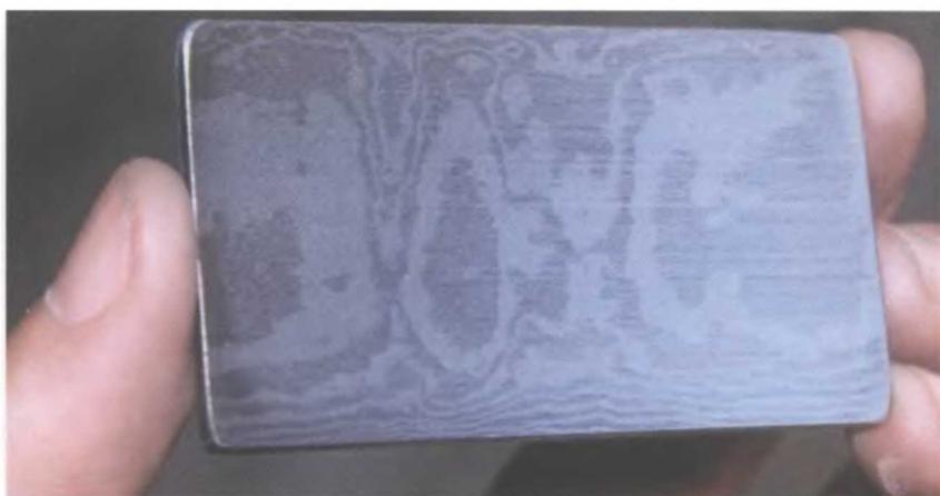
Здесь видны следы обработки детали на наждачной ленте, но материал черенка гладкий и плоский на вид и на ощупь
