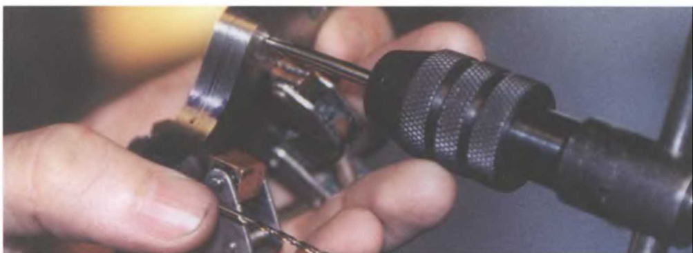
Черенки собраны и зажаты в фиксированной позиции, нарезка резьбы проводится вновь, чтобы совпадала сама резьба
