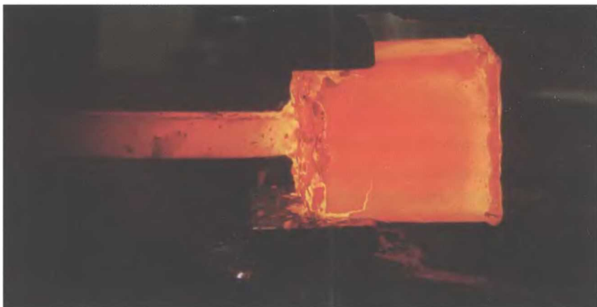
Изначальная сварка 4-дюймового квадратного билета.
