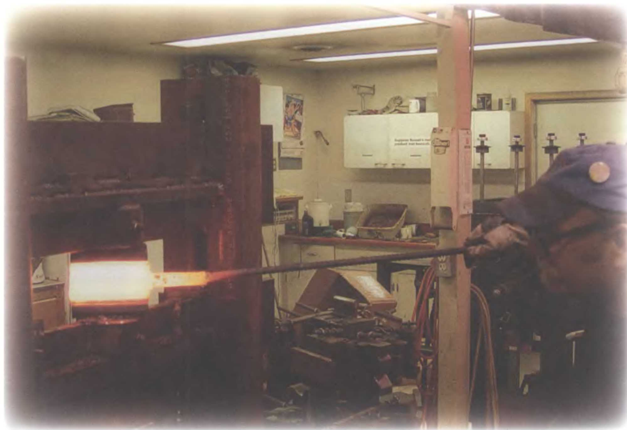
Эд Шемпп проводит первую сварку 19-слойного билета мокрым способом (с флюсом).
