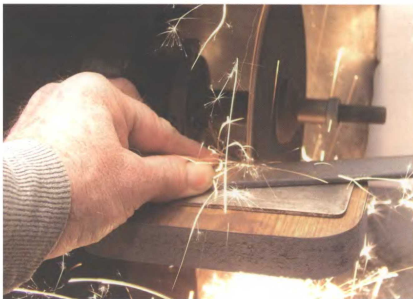
Самодельный шлифовальный станок используется автором в качестве абразивной пилы.
