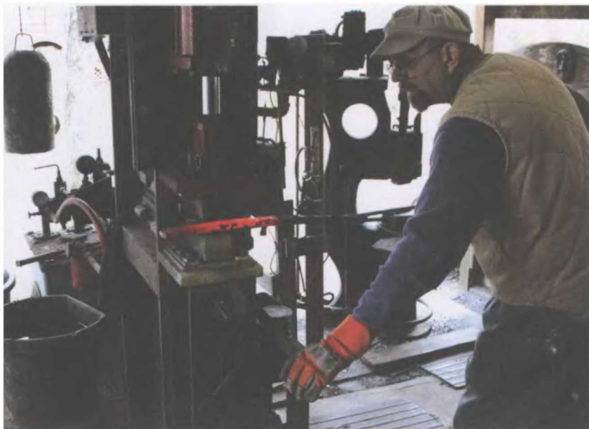
Начальный этап ковки — подготовка общей формы клинка меча. Профиль и толщина стали формируются с помощью молота.
