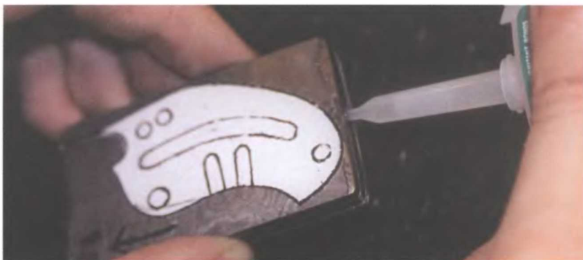
Автор обмазывает клеем Crazy Glue края сборки, чтобы все держалось на месте и части сборки не смещались, когда он начнет изначальную обработку деталей.
