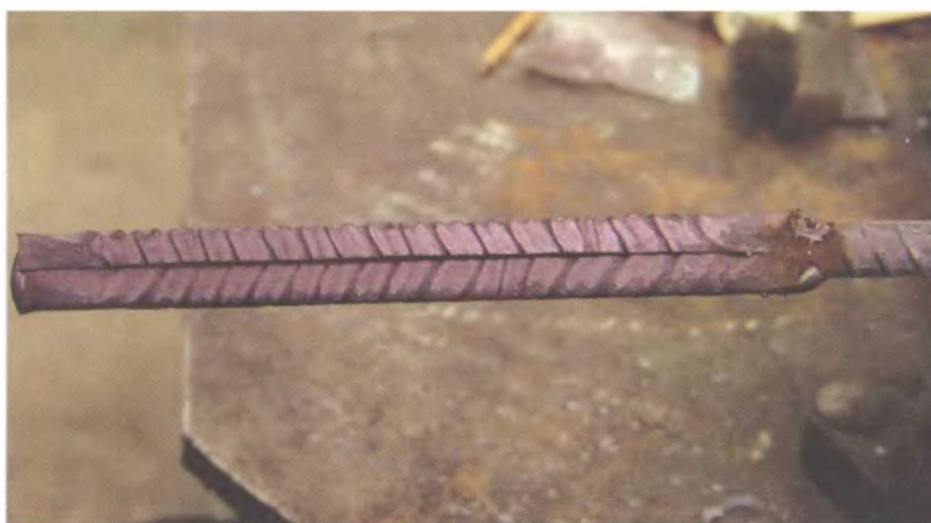
Два бруска, закрученные в противоположные стороны, можно сварить вместе. Они станут центральной основой композитного клинка из шести блоков.
