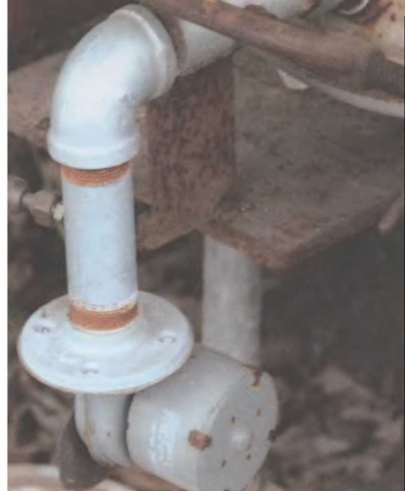
На фото показана конструкция горелки для бочкового горна.
