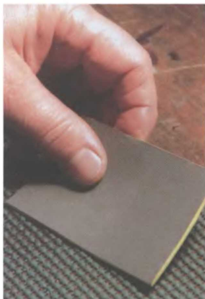
Автор подкладывает под бумагу зернистостью 2000 губку для следующей стадии полировки клинка меча.
