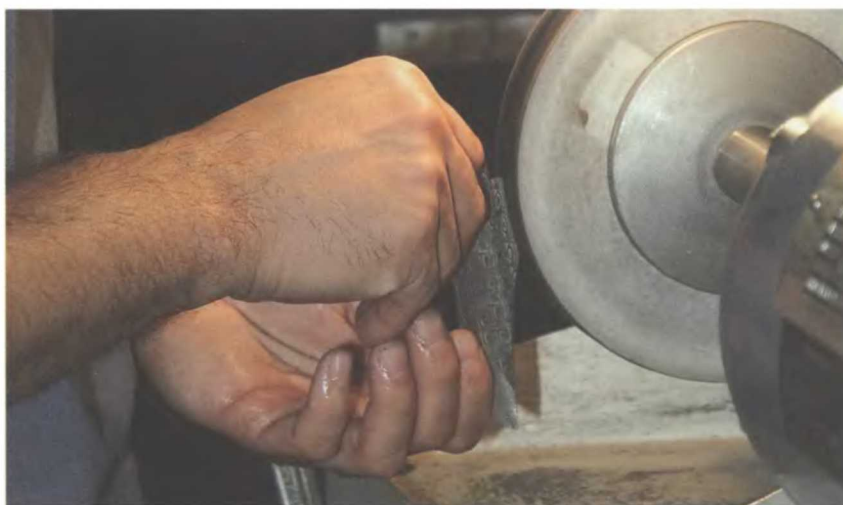
Аллен обрабатывает скос и внешнюю грань клинка на среднем войлочном колесе с небольшим добавлением румян.
