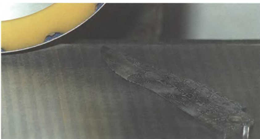
Аллен кладет клинок плоской шлифованной стороной на магнитный зажим. Клинок устанавливается под углом 60 градусов, и магнитный держатель включается. Чтобы удалить рисунок, оставшийся после травления на плоской стороне клинка, автор использует ленту зернистостью 120.
