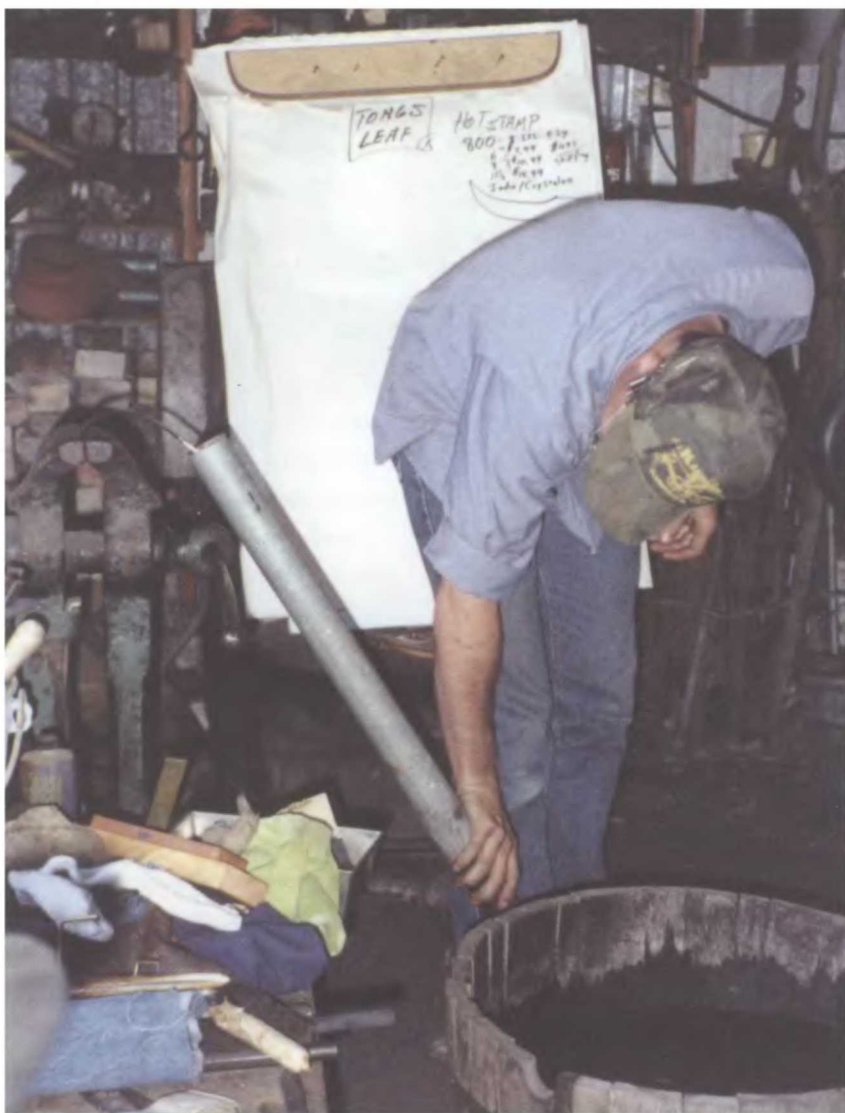
Кузнец из Монтаны Эд Каффри демонстрирует прочность клинка, прошедшего селективную термообработку, в мастерской Дейва Брендона.
