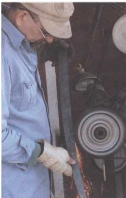
Автор профилирует хвостовик клинка.
