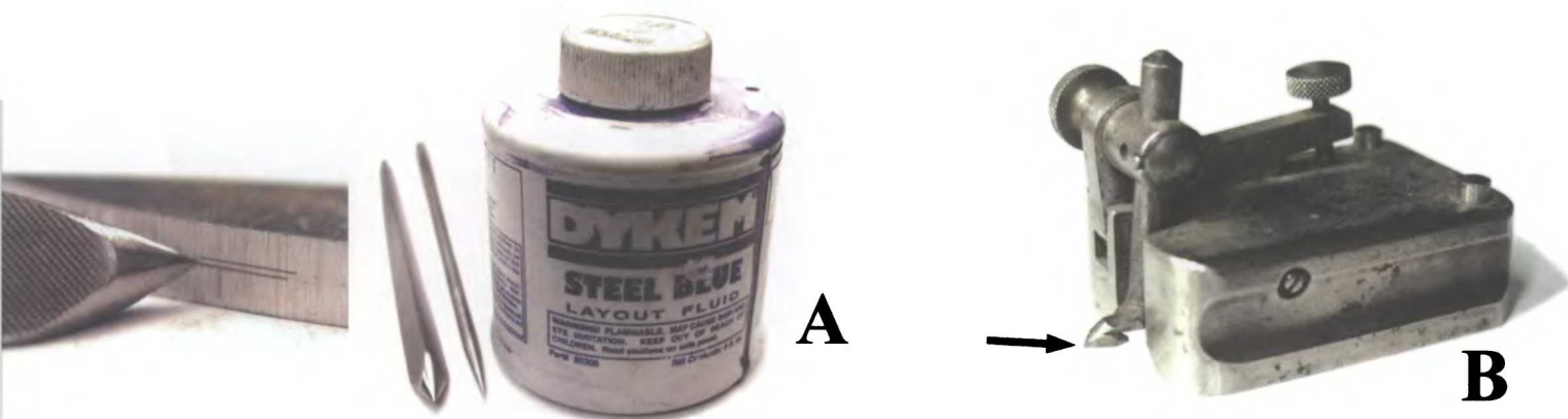
А Краска для разметки, а также чертилка и кернер, изготовленные из старых напильников. Крупным планом показано нанесение центральной линии. В Рейсмус с высокопрочной чертилкой для разметки центральной линии клинка. Клинок и рейсмус помещаются на плоскую поверхность. Центр определяется с помощью регулирующего винта. Линия наносится путем передвижения клинка по острию чертилки.
