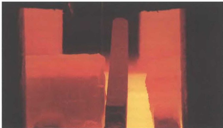
Несколько биллетов нагреваются до температуры сварки в горне. Большой квадратный билет слева будет сварен сухим способом (без флюса)
