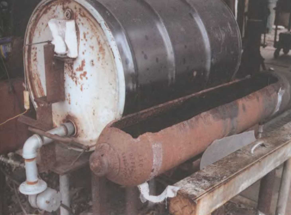
Это типичный бочковый горн и емкость для заправки – оборудование мастера по изготовлению мечей
