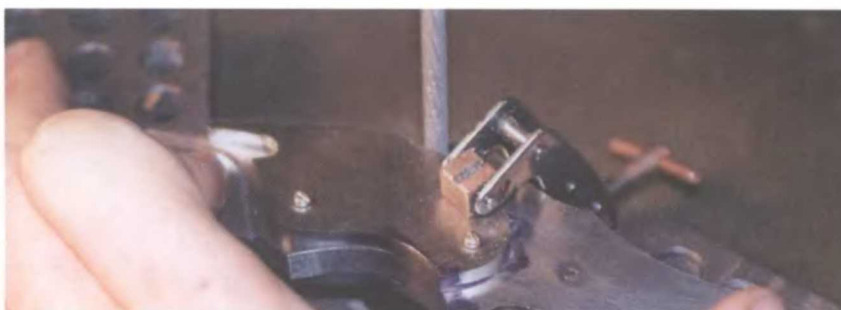
С помощью механического напильника автор может выровнять внутреннюю часть небольшого закругления в верхней части черенка.
