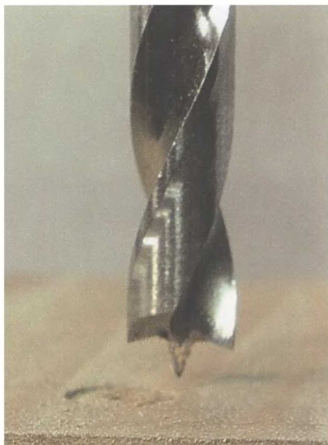
Винтовой наконечник сверла предназначен для того, чтобы просто врезаться в поверхность накладки рукоятки
