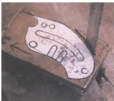
Убедившись в том, что ленточная пила и деталь расположены перпендикулярно, автор аккуратно обрезает черенок по форме близко к линии дизайна.
