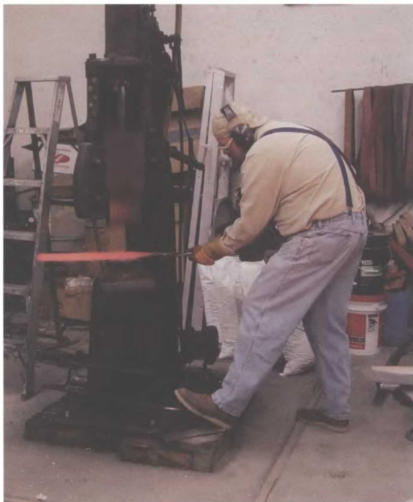
Девин Томас протягивает блок на 150-фунтовом пневматическом молоте
