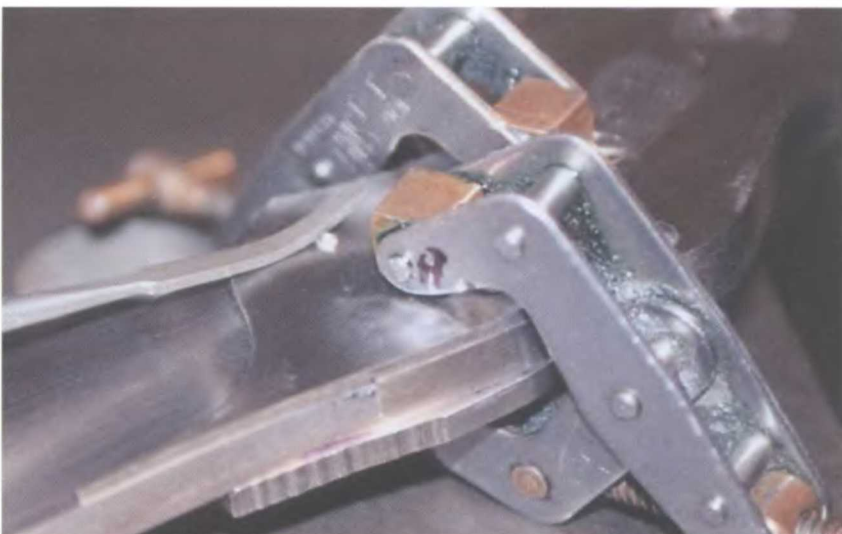
Вы можете видеть красоту работы рифтовочного напильника. Там, где напильник касается поверхности материала, возникает лишь небольшой концентрированный участок.
