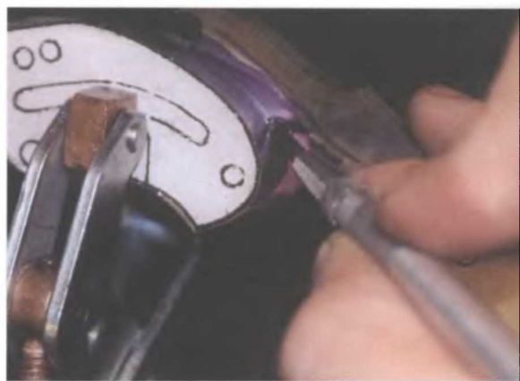
Для разметки профиля черенков автор использует острую чертилку.
