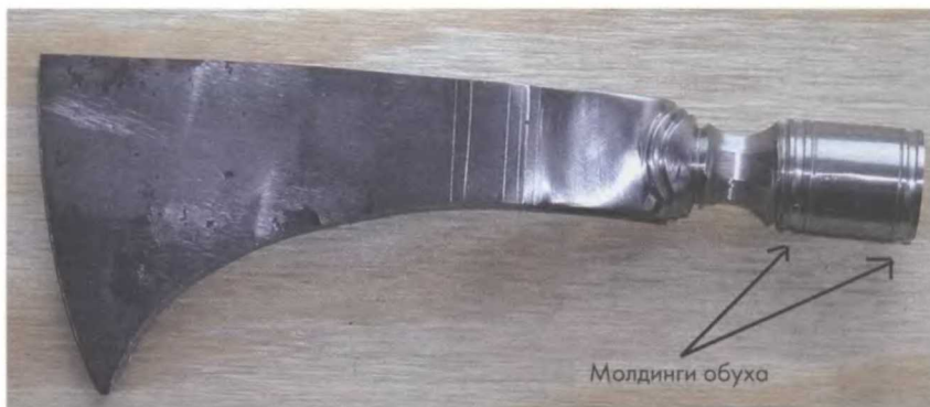
Томагавк имеет два молдинга, один сверху, а другой снизу обуха. Автор нарезает две линии молдингов с помощью треугольного напильника.
