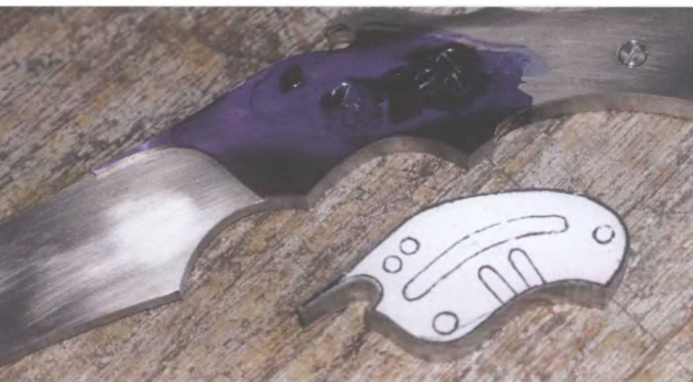
Автор наносит голубую жидкость для разметки DuPont на общий участок корпуса ножа, где будет помещаться черенок.
