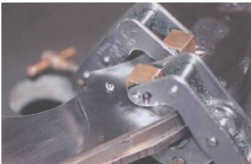
На выходном конце предварительно просверленного отверстия возникают большие заусенцы
