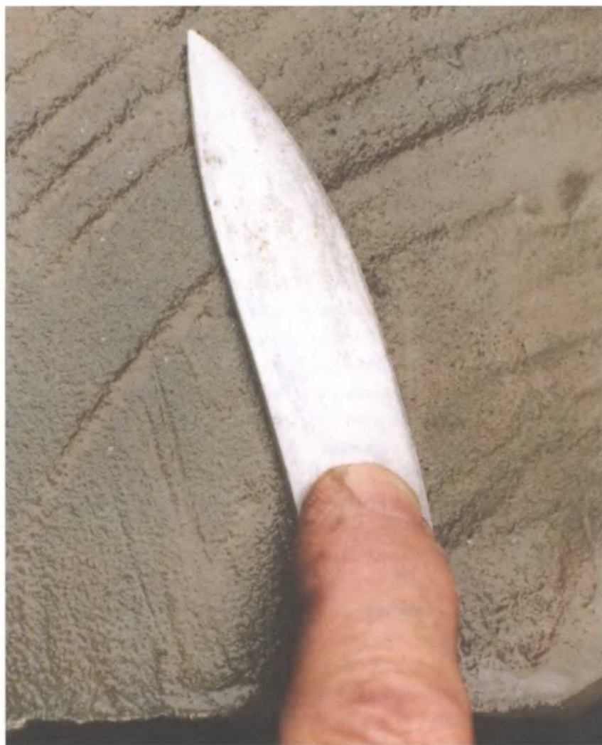
Для полировки вручную используется кусок натурального песчаника.
