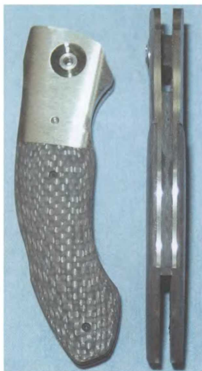
На этом этапе профиль ножа отполирован на ленте зернистостью 400, а контур материала рукоятки – на ленте 600
