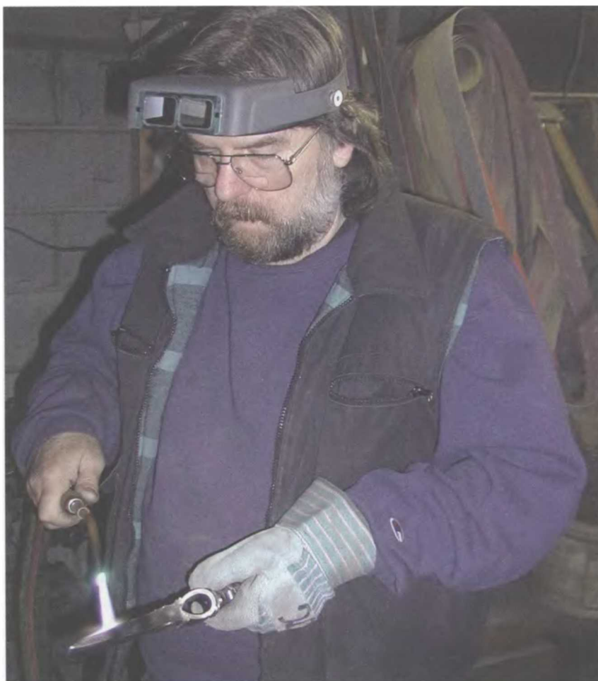
Автор нагревает клинок от самой толстой его части к режущей грани.
