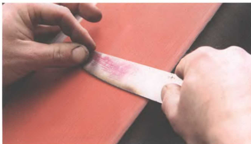
Учитывая более широкий участок контакта, на грань необходимо надавливать с большим усилием.
