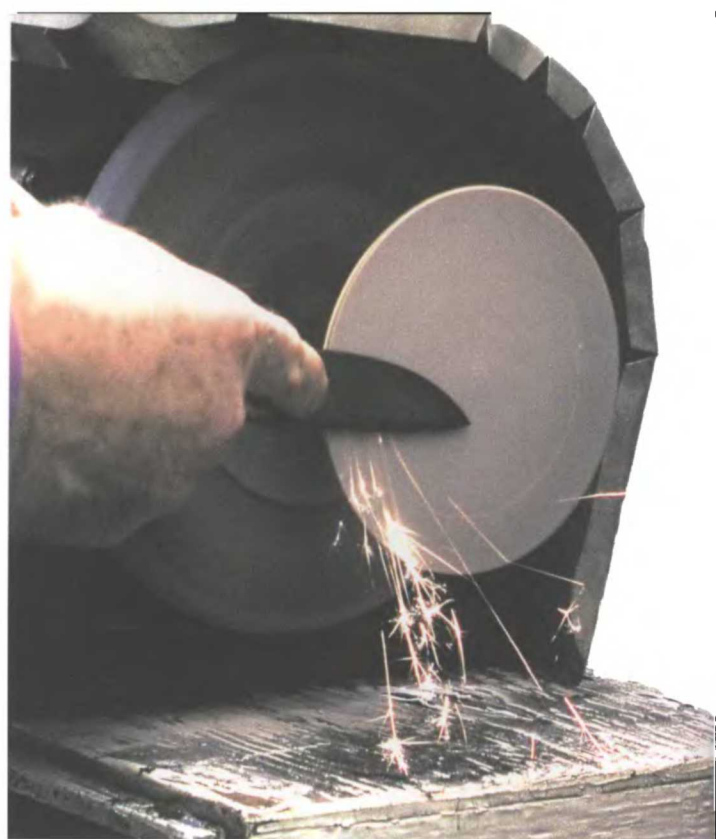
На фронтальном фото шлифовальной машины показан укрепленный на оси патрон с насадкой наждачного диска. Справа - операция по шлифовке шкуркой/сглаживанию клинка.
