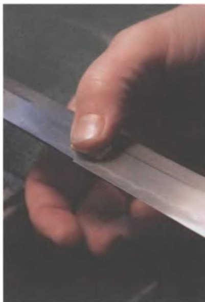
Автор полирует клинок кусочком бумаги зернистостью 2000, зажатым большим пальцем.
