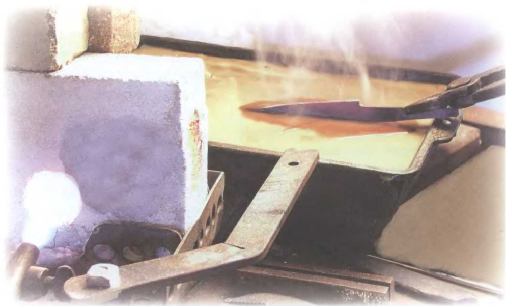
Процесс закалки грани проводится с использованием самодельной пасты автора в качестве закаливающего раствора.
