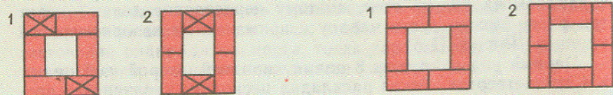
Рис. 35. Варианты кладки дымовых труб
