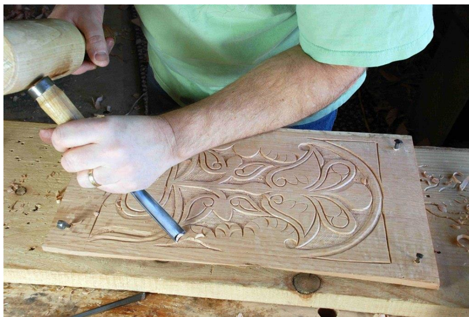
Рис. 3.11. Выборка фона с применением долото и киянки
