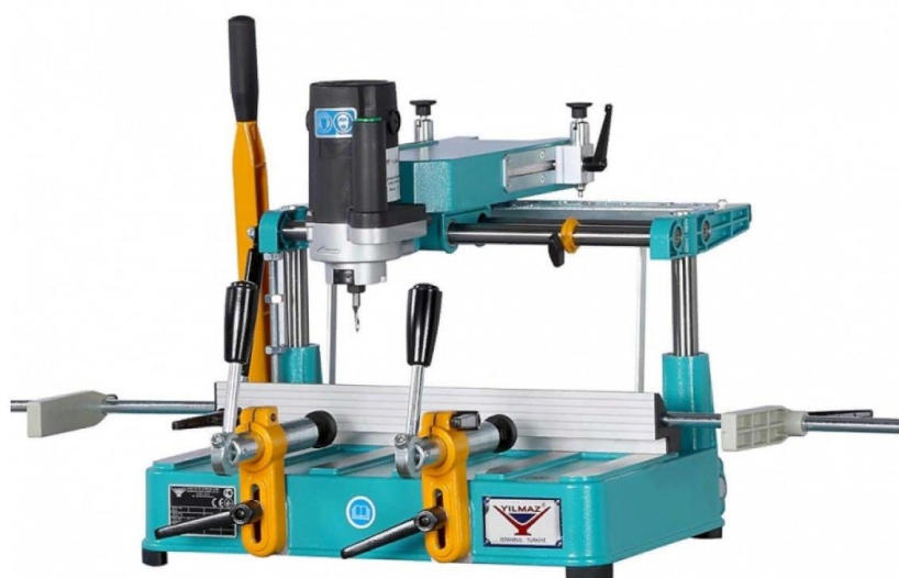
Рис. 5.3. Копировально-фрезерный станок
