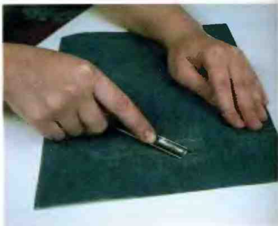
Рис. 63. Заточка инструмента на шлифовальной шкурке после формирования 2-й фаски
