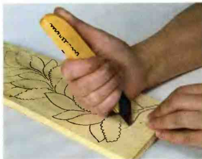
Рис. 152. Надрезка по контуру орнамента ножом-косяком
