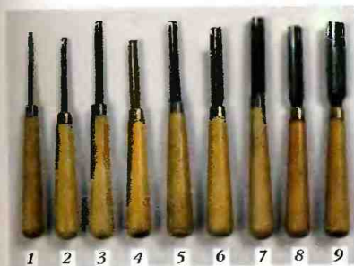
Рис. 51. Стамески полукруглые крутые шириной: 2 мм (1); 3 мм (2); 4 мм (3); 5 мм (4); 6 мм (5); 7 мм (6); 8 мм (7); 10 мм (8); 12 мм (9)
