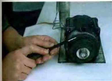
Рис. 67. Правка (шлифовка) инструмента
