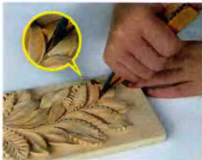
Рис. 179. Завершение вырезания орнамента. Формирование поверхности гладких листьев (подрезка под лист № 18)
