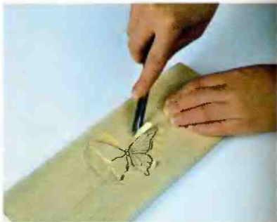
Рис. 134. Выбор материала отлогой стамеской вокруг бабочки
