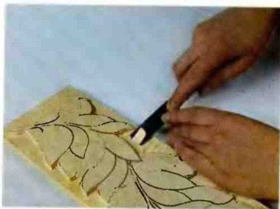
Рис. 159. Выборка фона отлогой стамеской (углубление фона)
