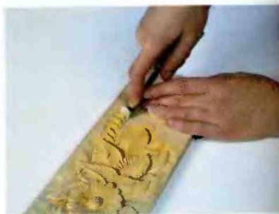
Рис. 125. Стыковка стамески с вышележащей надрезкой
