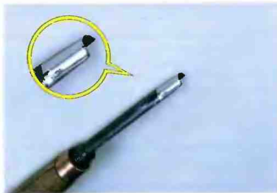
Рис. 69. Вид стамески после шлифовки
