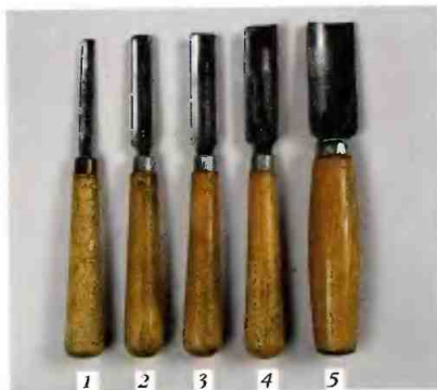
Рис. 52. Стамески отлогие (полуплоские) узкие 4–7 мм (1) и широкие: 10–12 мм (2); 18 мм (3); 20 мм (4); 25 мм (5)
