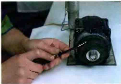
Рис. 68. Правка инструмента
