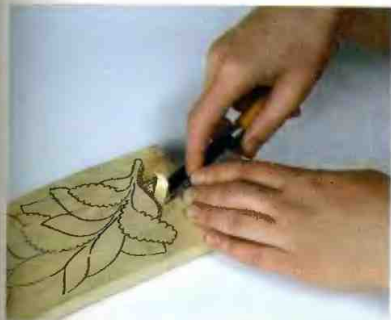
Рис. 155. Стыковка стамески у края орнамента с надрезкой по его контуру
