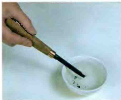
Рис. 62. Охлаждение инструмента в процессе заточки
