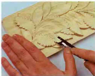
Рис. 171. Формирование второй половины поверхности листа № 1 широкой отлогой стамеской
