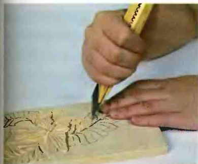
Рис. 147. Рез ножом-косяком от середины листочка до его кончика. На схеме, показанной на рис. 107, соответствует надрезке из точки В к точке Г по линии ВГ
