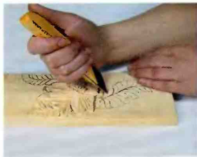
Рис. 144. Надрезка ножом-косяком до половины листочка. На схеме, показанной на рис. 107 соответствует направлению из точки А к точке В по линии АБ
