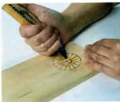
Рис. 103. Двухгранное углубление между лепестками "ромашки" (2-ая надрезка)
