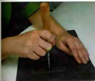
Рис. 58. Торцевание или выравнивание кромки стамески вручную на шкурке
