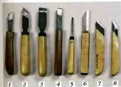
Рис. 50. Стамески: прямые со скосом (1, 2), прямые узкие и широкие (3–5). Ножи: богородский (6), со скосом 45^\circ (7) и 35^\circ (8)
