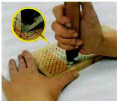
Рис. 82. Выполнение надрезок по линиям АВ, ВВ, ГД, ДЕ, ЖЗ и ИИ
