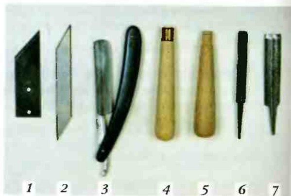
Рис. 55. Полотна ножей-косяков (1, 2), опасная бритва (3), деревянные рукоятки (4, 5), полотна стамесок (6, 7)
