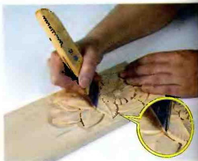
Рис. 113. Формирование “зубчиков” ножом-косяком
