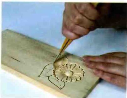
Рис. 111. Выполнение надрезки ножом-косяком по контуру листа
