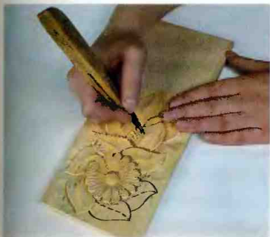
Рис. 116. Надрезка ножом-косяком по поверхности 1-й половины листа (1-й рез)
