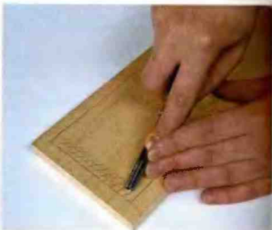
Рис. 93. Положение стамески в момент начала обработки поверхности "чешуек"
