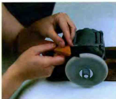
Рис. 60. Формирование 2-й фаски под углом 15\text{--}25^\circ у ножа-косяка
