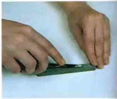
Рис. 64. Заточка инструмента на шлифовальном бруске после формирования 2-й фаски
