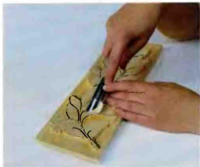
Рис. 166. Выборка материала отлогой стамеской вокруг листа № 1
