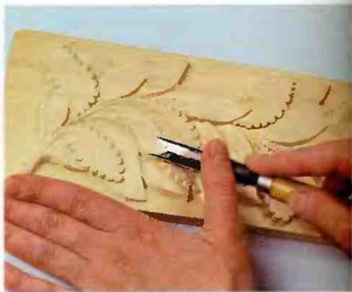
Рис. 173. Формирование поверхности первой половины листа № 2 широкой отлогой стамеской
