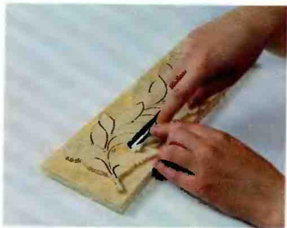
Рис. 164. Снятие материала, обозначенного тоновой заливкой, вокруг листьев
