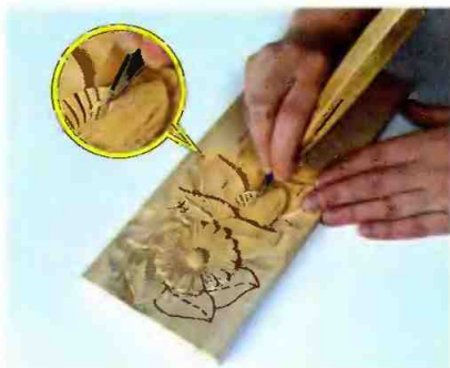
Рис. 117. Подрезка ножом-косяком по поверхности 1-й половины листа (2-й рез)
