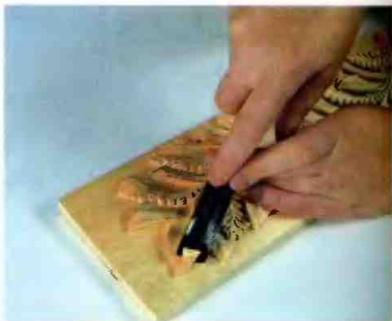
Рис. 181. Окончательная отделка гладких листьев широкой отлогой стамеской
