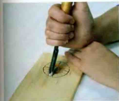
Рис. 101. Выполнение надрезки края лепестка "ромашки"
