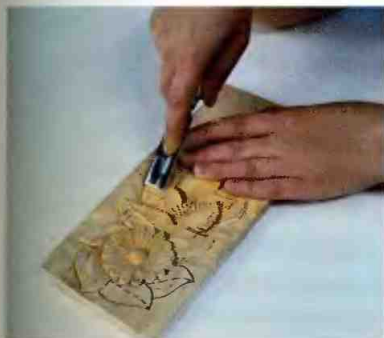
Рис. 115. Подрезка по поверхности листа отлогой стамеской
