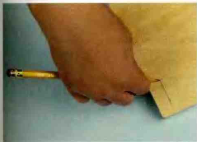
Рис. 80. Нанесение окантовочной линии на заготовку
