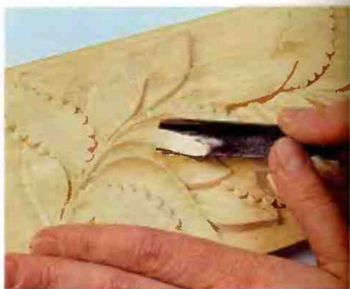
Рис. 174. Формирование поверхности второй половины гладкого листа № 2 широкой отлогой стамеской
