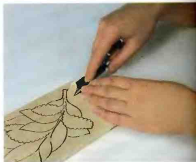
Рис. 154. Выборка фона отлогой стамеской
