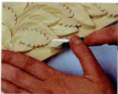
Рис. 170. Формирование первой половины поверхности листа № 1 широкой отлогой стамеской
