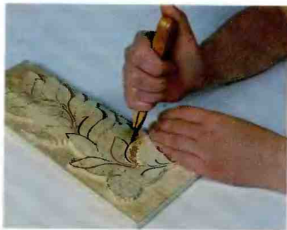
Рис. 165. Выполнение надрезки ножом-косяком по краю листа № 1
