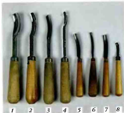
Рис. 53. Клюкарзы: отлогие (1, 2, 4), уголок (3), полукруглые крутые (5–8)
