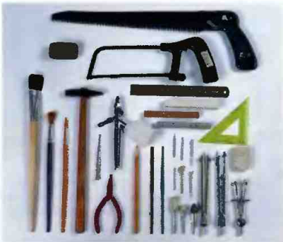
Рис. 72. Инструменты, необходимые для подготовки древесины к работе, разметки, нанесения рисунка и т. д.
