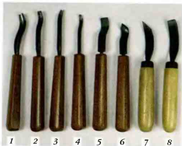
Рис. 54. Кюкарзы: кривые с различным изгибом шейки полотна (1, 2); обратная кривая (3); церазик (4); прямые с различными скосами полотна (5–8)
