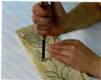
Рис. 158. Углубление надрезки стамеской по контуру орнамента (у края закругленных листьев)
