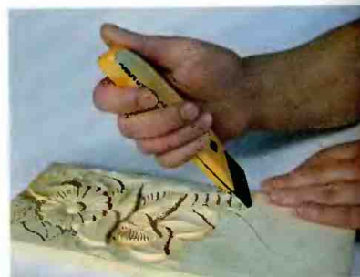
Рис. 126. Надрезка ножом-косяком по краю вырезанного стамеской листочка
