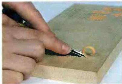
Рис. 70. Срез поперек волокон древесины
