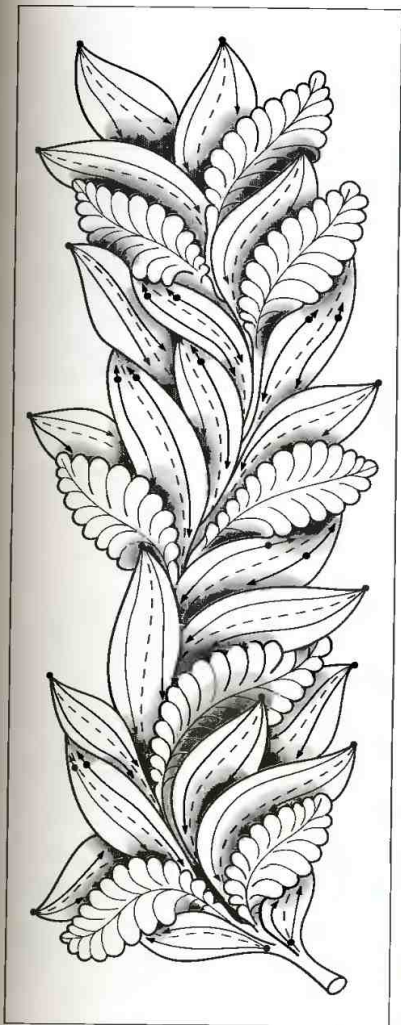
Рис. 168. Схема формирования поверхности гладких листьев. Штрих-пунктир обозначает гребни в середине листьев. Стрелки – направления движений стамески. Точками показано начало движения стамески
