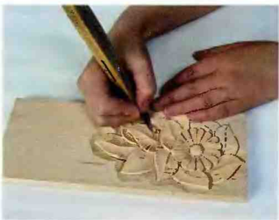
Рис. 118. Подрезка ножом-косяком по поверхности 2-й половины листа
