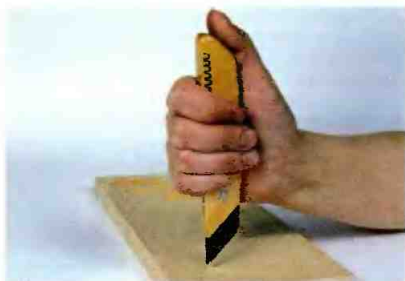
Рис. 74. Захват ножа-косяка при резьбе на себя (способ 1)
