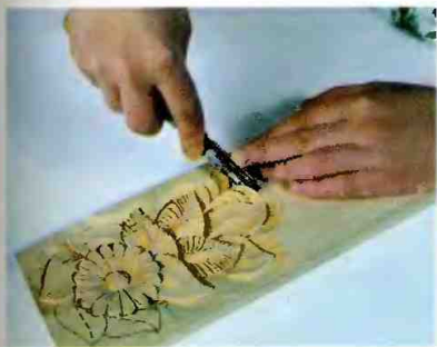
Рис. 127. Формирование листочков, края которых убраны под большой гладкий лист, с помощью отлогой широкой стамески
