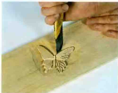
Рис. 139. Подрезка (поднутрение) ножом-косяком под “бабочку”
