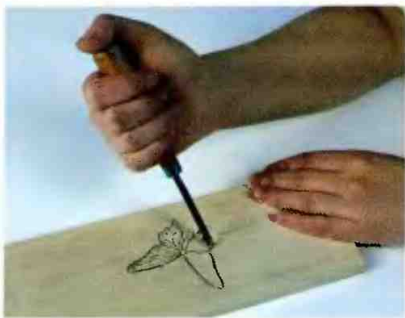
Рис. 133. Надрезка узкой отлогой стамеской по контуру "бабочки"
